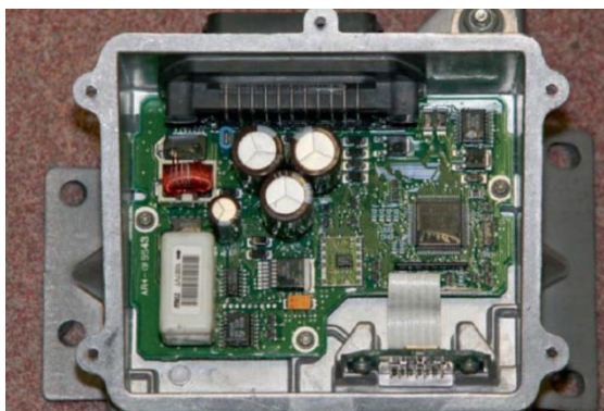
Рисунок 1-15: Модуль управления (компьютер) используется для обработки данных и управления различными электрическими приводами; Delmar/Cengage Learning
