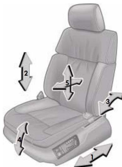
Рисунок 1-21: Функции регулируемого сиденья с памятью. Это сиденье имеет регулировки положения: 1 – в продольном направлении; 2 – по высоте; 3 – по наклону спинки; 4 – по наклону подушки; 5 – поясничной опоры по высоте и в продольном направлении. Кроме того, ряд сидений оснащен регулируемым подголовником с электрическим приводом; источник: VW
