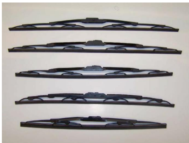
Рисунок 1-10: Очиститель ветрового стекла; Delmar/Cengage Learning
