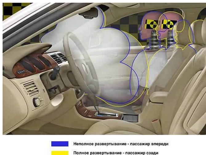
Рисунок1-30: Двухступенчатое срабатывание подушки безопасности запущено в серию в 2006 году; источник: http://www.jcwiki.ru
