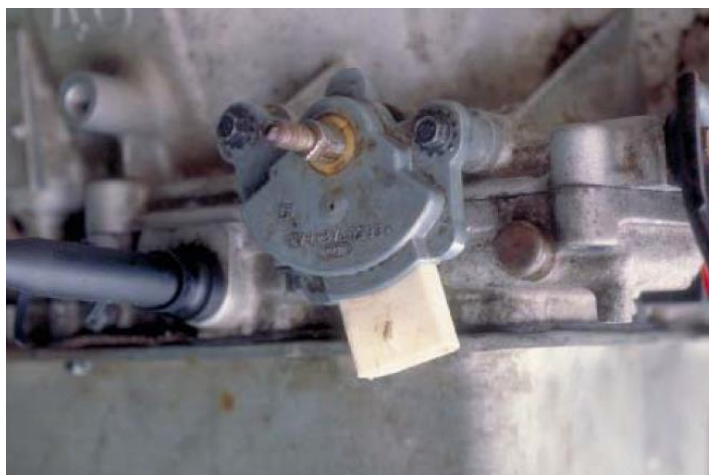
Рисунок 1-3: Размыкатель безопасного пуска двигателя обычно установлен на валу привода селектора диапазонов автоматической трансмиссии; Delmar/Cengage Learning
