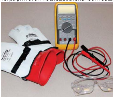
Фото S1.2-1: Процедура проверки высоковольтной изоляции потребует, 1000-Вольтовых диэлектрических перчаток, средства защиты глаз и цифровой мультиметр
