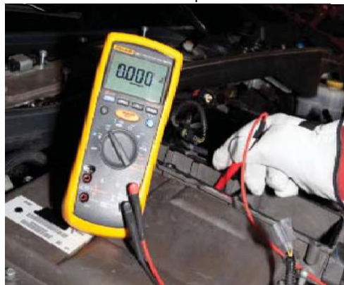
Фото S1.2-9: Используйте цифровой мультиметр, чтобы подтвердить, что высоковольтные контуры имеют напряжение 0 Вольт перед началом процедуры обслуживания высоковольтной системы автомобиля.
