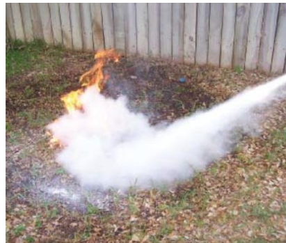
Фото S1-6: Сожмите рычаги, переводя шланг из стороны в сторону. Держите струю огнегасящего вещества в направлении к основанию огня.
