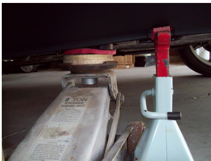
Рисунок S1-9: Опорные стойки должны использоваться для удержания автомобиля после совершения его подъема домкратом
