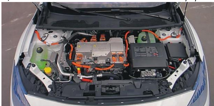
Рисунок S1-36: Высоковольтные кабельные линии, штекерные разъемы и зажимы HEVs имеют оранжевый цвет, а все компоненты. Работающие под высоким напряжением, помечены знаком «Высокое напряжение»; источник: auto.ru.msn.com
