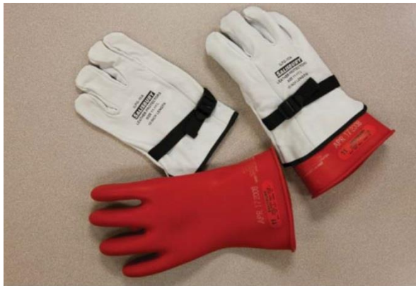
Рисунок S1-38: Диэлектрические перчатки класса «0» должны быть проверены перед началом работ, связанных с обслуживанием высоковольтных систем; источник: Delmar/Cengage Learning
