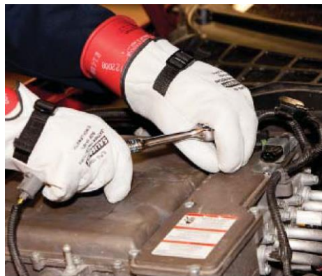
Фото S1.2-8: По истечении 5 минутной паузы, необходимой для разрядки высоковольтных конденсаторов в инверторе, снимите ограждения, чтобы получить доступ к компонентам высоковольтной системы для проведения проверки высоковольтной изоляции.
