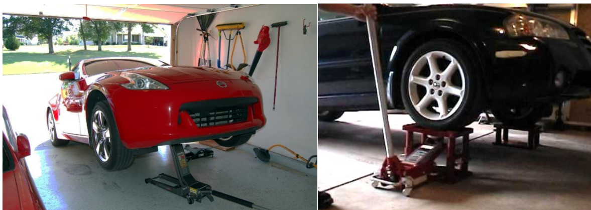
Рисунок S1-6: Напольные домкраты используются для поднятия автомобиля на небольшую высоту от пола. Напольный домкрат можно использовать для подъема автомобиля и на большую высоту, если использовать специальные телескопические мостки
