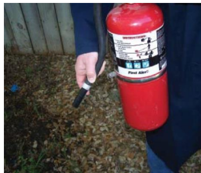
Фото S1-4: Выньте шланг из фиксатора и нацельте его в основание пламени
