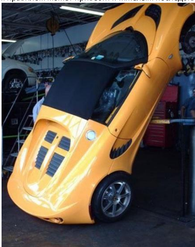
Рисунок S1-15: Падение автомобиля с подъемника произошло в результате пренебрежения к учету распределения масс в автомобиле; источник: pbnation.com
