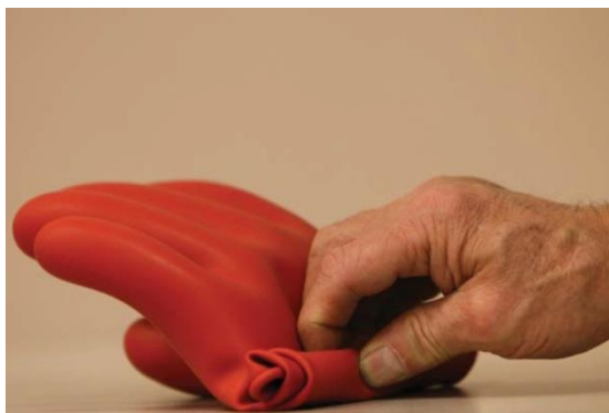
Рисунок S1-39: Перед каждым использованием проведите испытание перчаток на утечку воздуха; Delmar/Cengage Learning
