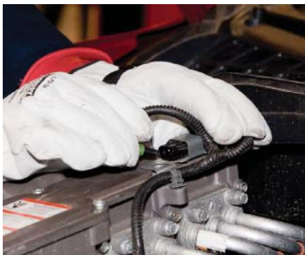
Фото S1.2-5: Если автомобиль оборудован разъединителем 12-Вольтовой аккумуляторной батареи, разъедините его, чтобы изолировать 12-Вольтовую батарею. Если автомобиль не оснащен разъединителем, отсоедините отрицательный зажим от полюсного вывода вспомогательной 12-Вольтовой аккумуляторной батареи. Всегда отсоединяйте вспомогательную 12-вольтовую батарею до отсоединения высоковольтного сервисного размыкателя.
