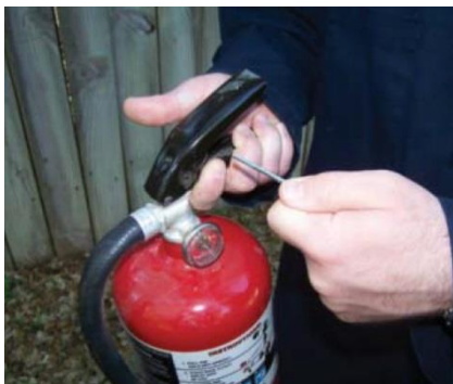
Фото S1-3: Вытяните стопорный штифт из рукоятки
