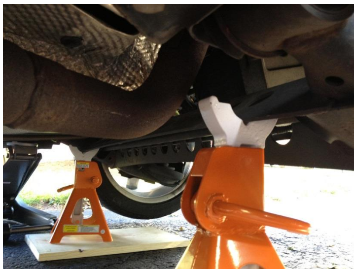
Рисунок S1-10: Для обеспечения большей устойчивости опорные стойки должны быть установлены под каждой четвертью кузова автомобиля. Не используйте напольный домкрат в качестве опорного элемента; источник: Delmar/Cengage Learning
