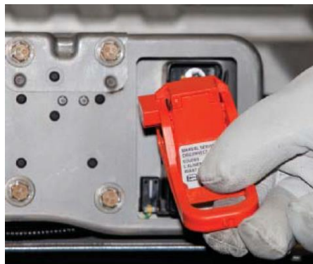
Фото S1.2-6: Отсоедините высоковольтный сервисный размыкатель, и уложите его в Ваш инструментальный ящик, или в каком-нибудь в недоступном месте, чтобы никто не смог установить его на штатное место.
