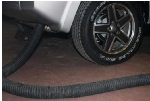
Рисунок S1-19: Подключите вентиляционный шланг к выхлопной трубе автомобиля перед его запуском. Убедитесь, что шланг не имеет перегибов; источник: Delmar/Cengage Learning
