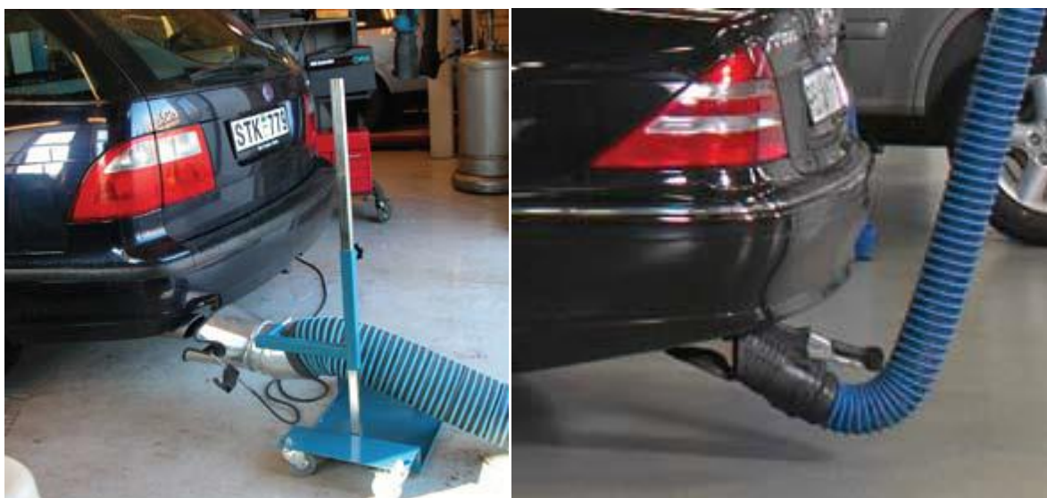
Рис. S1-21: Для предотвращения самопроизвольного отсоединения отборной воронки от автомобиля предусмотрена установка отборной воронки на передвижной площадке с возможностью регулировки по высоте, или комплектование отборной воронки клещевым фиксатором; источник: Nederman
