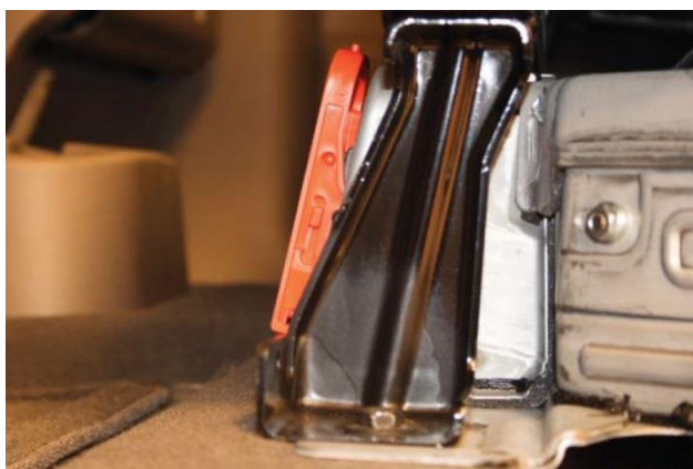
Рисунок S1-40: Высоковольтный сервисный размыкатель расположен возле высоковольтной батареи; источник: Delmar/Cengage Learning
