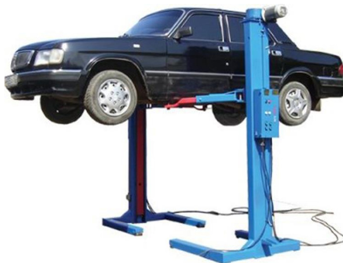
Рисунок S1-14: Двух-стоечный подъемник с телескопическими поворотными балками, часто используемый в автомобильных мастерских
