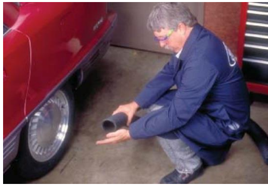
Рисунок S1-18: Испытание вентиляционной системы перед её использованием; источник: Delmar/Cengage Learning
