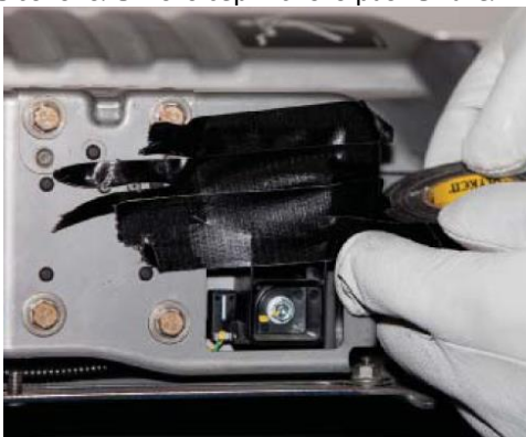
Фото S1.2-7: Заклейте гнездо высоковольтного сервисного размыкателя изоляционной лентой.
