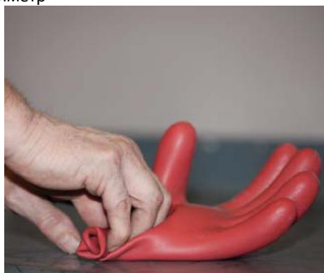
Фото S1.2-3: Перед использованием проверьте целостность диэлектрических перчаток. Не снимайте перчатки, пока не завершите полное выполнение процедуры проверки высоковольтной изоляции.
