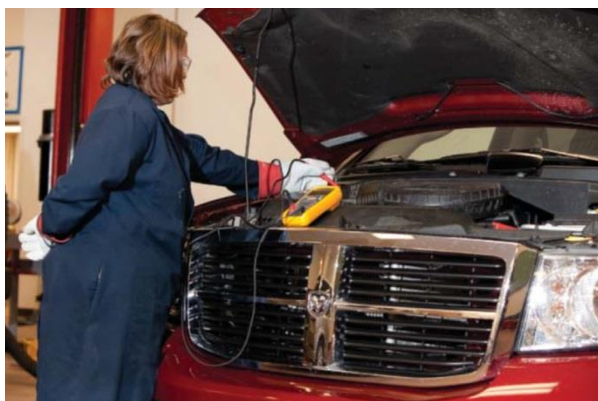
Рисунок S1-37: Придерживайтесь правил проведения измерений высоковольтного напряжения «одной рукой»; источник: Delmar/Cengage Learning
