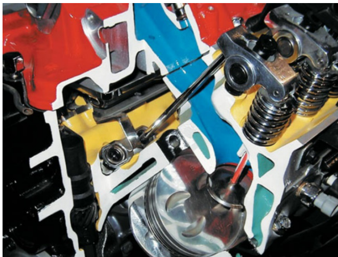
Рисунок 18-14: Вид в разрезе головки блока двигателя с верхним расположением клапанов ( OHV ) и распределительным валом в блоке цилиндров. Виден впускной клапан с возвратной пружиной, коромысло, штанга толкателя и толкатель.
