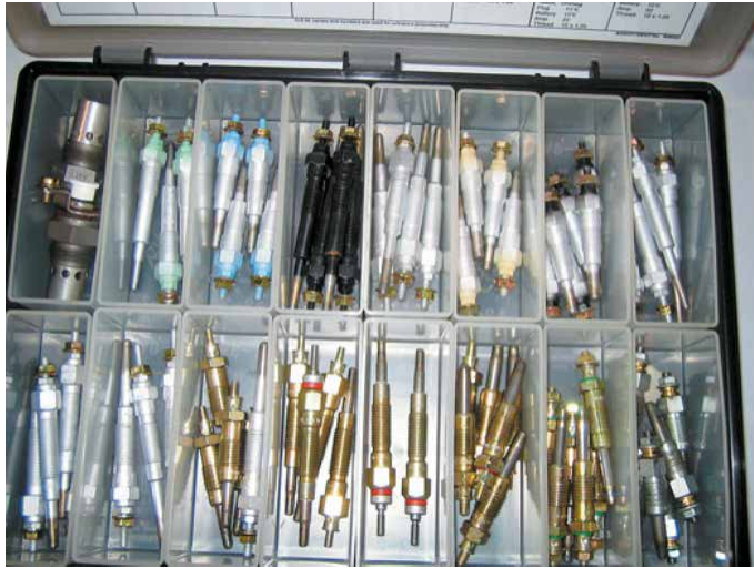
Рисунок 19-23: Свечи накаливания в ассортименте. Показаны для демонстрации разнообразия размеров и типов свечей накаливания. Всегда следует использовать только рекомендованные производителем свечи; источник: Pearson Education, Inc.
