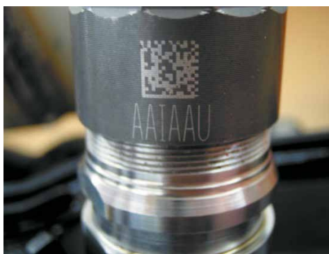
Рисунок 19-50: На снимке ряд букв, нанесенных на корпус инжектора, означают калибровочное число данного инжектора; источник: Pearson Education, Inc.
