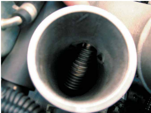
Рисунок 19-25: Электронагревательная спираль, установленная во впускном трубопроводе некоторых дизелей, служит для подогрева впускаемого воздуха; источник: Pearson Education, Inc.
