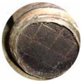
Рисунок 19-38: Крупные твердые частицы нагара, которые образуются при сгорании серы, забивают сажевый фильтр, снижая эффективность работы дизельного двигателя.
