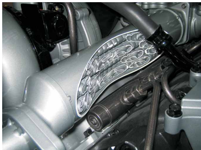
Рисунок 19-31: Иллюстрация теплообменника выхлопного газа в разрезе. Промежуточный теплообменник, установленный в линии возврата выхлопного газа в цилиндр двигателя, позволяет значительно снизить содержание оксидов азота NOx в выхлопных газах двигателя; источник: Pearson Education, Inc.
