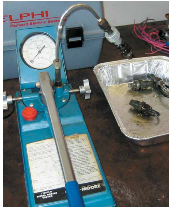
Рисунок 19-47: Типичный тестер начала открытия распылителя форсунки дизельного двигателя позволяет произвести визуальную оценку качества распыления топлива; источник: Pearson Education, Inc.
