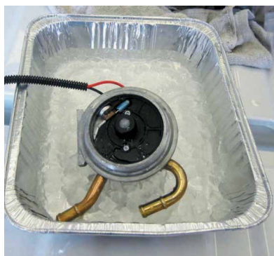
Рисунок 19-9: Тестирование датчика температуры топлива с использованием ледяной бани; источник: Pearson Education, Inc.
