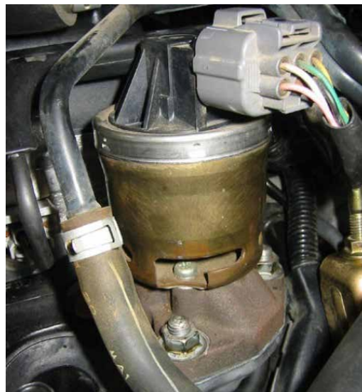
Рисунок 19-32: Большинство клапанов EGR приводятся в действие вакуум-модулированным сигналом. На снимке показан клапан EGR с электронным (цифровым) управлением и постоянным мониторингом положения исполнительного механизма. На части американских автомобилей уже используют этот тип клапана, многие новые автомобили Honda уже используют подобный клапан EGR ; источник: Pearson Education, Inc.
