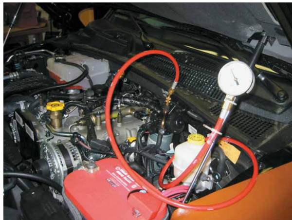
Рисунок 19-45: Измерение уровня давления, создаваемого топливоподкачивающим насосом на 6,7 литровом дизельном двигателе Cummins; источник: Pearson Education, Inc.
