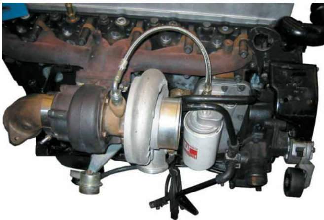
Рисунок 19-27: Турбокомпрессор дизеля Cummins используется для увеличения мощности и крутящего момента; источник: Pearson Education, Inc.
