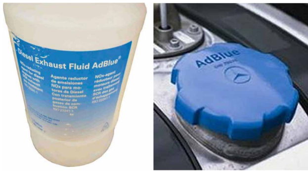
Рисунок 19-42: Жидкости для систем выхлопа дизельных автомобилей AdBlue стоит около 60 рублей за литр и размещается в отдельном контейнере, который содержит от 20 до 40 литров, или в объеме, достаточном до следующей плановой замены масла в большинстве дизельных автомобилей, которые используют SCR ; источник: Pearson Education, Inc.
