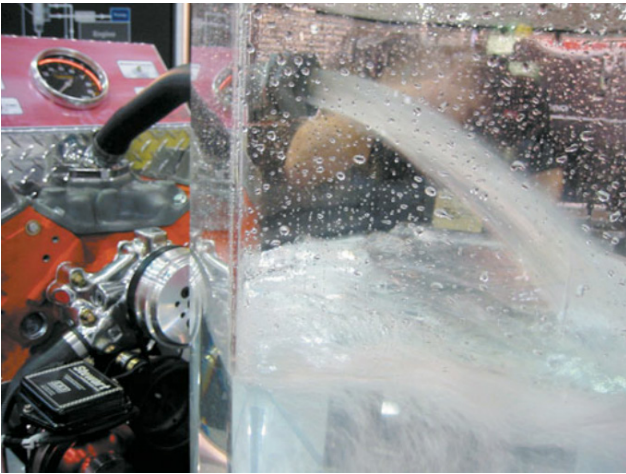
Рисунок 21-21: Работа двигателя на стенде, демонстрирующем объема расхода охладителя, который прокачивается через систему охлаждения; источник: Pearson Education, Inc.
