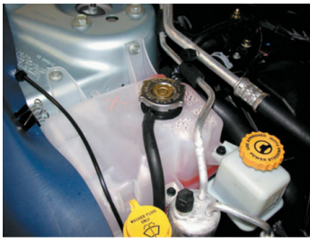
Рисунок 21-19: Некоторые автомобили используют расширительный бачок, который расположен на самом высоком уровне системы охлаждения, с крышкой радиатора, установленной на расширительном бачке; источник: Pearson Education, Inc.
