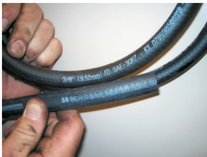
Рисунок 21-38: На снимке показаны 3/8 дюймовые шланги, предназначенные для масла и подобных жидкостей, и 3/8 дюймовый шланг, на котором имеется надпись «HEATER HOSE», и предназначен для контакта с охлаждающей жидкостью; источник: Pearson Education, Inc.
