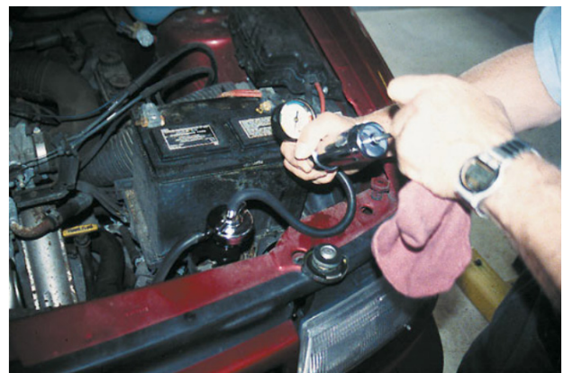
Рисунок 21-30: Опрессовка системы охлаждения. Используя типовой ручной тестер давления, создается давление, равное величине, указанной на крышке радиатора. Давление должно удерживаться в течение не менее 2 минут; если давление падает, это указывает на утечку жидкости в системе охлаждения. Адаптер используется для подключения насоса к крышке радиатора, чтобы определить, какое давление может удержать крышка радиатора, поскольку повышение давления выше номинала должно сброситься напорным клапаном; источник: Pearson Education, Inc.
