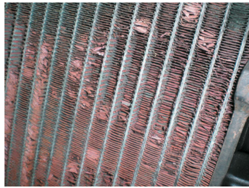
Рисунок 21-29: Сильная коррозия радиатора автомобиля указывает, что был перегрев. Визуальный осмотр выявил, что коррозия разъела многие ребра охлаждения, но подтекание охлаждающей жидкости отсутствует. Этот радиатор был заменен – так была решена проблема перегрева; источник: Pearson Education, Inc.
