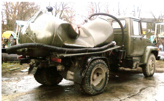
Рисунок 21-18: Автомобильная цистерна была помыта изнутри горячим паром. Конденсация пара привела к возникновению в цистерне разрежения. Атмосферное давление попросту расплющило цистерну.
