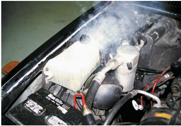
Рисунок 21-33: Когда двигатель перегревается, часто охлаждающей жидкости выплескивается через край расширительного бачка, и вскипает; источник: Pearson Education, Inc.
