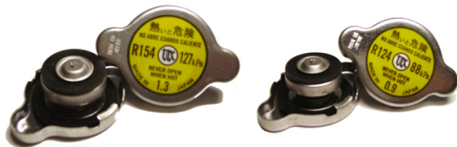
Рисунок 21-16: Надпись на крышке японского автомобиля: 88 кПа или 0,9 бар; 127 или 1,3 бар – давление открытия подпружиненного (напорного) клапана. На некоторых крышках имеется надпись на внутренней стороне крышки, которая указывает давление открытия вакуумного (вентиляционного) клапана. R124 или R154 – тип радиатора.
