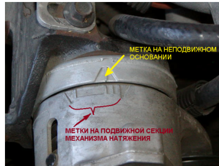
Рисунок 21-34: Типовые метки на натяжителе ремня привода аксессуаров; источник: Pearson Education, Inc.
