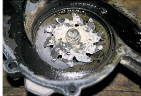
Рисунок 21-22: Это сильно заржавевший водяной насос не может обеспечить циркуляцию достаточного количества охлаждающей жидкости, чтобы удерживать двигатель в диапазоне рабочих температур. Как результат, двигатель перегрелся, и разрушилась прокладка головки блока; источник: Pearson Education, Inc.
