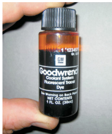
Рисунок 21-32: Используйте специально разработанный краситель для охлаждающей жидкости, при проверке системы на герметичность с помощью источника ультрафиолетового света; источник: Pearson Education, Inc.
