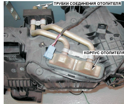
Рисунок 21-28: Типичный отопитель установлен в системе отопления, вентиляции и кондиционирования воздуха (HVAC= HEATING, VENTILATING, AND AIR CONDITIONING). На рисунке показан корпус отопителя в сборе; источник: Pearson Education, Inc.
