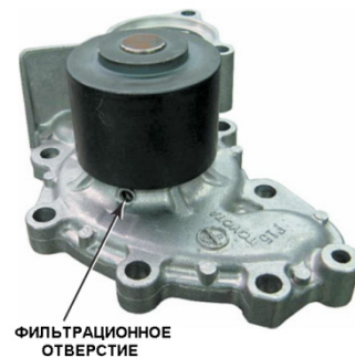
Рисунок 21-23: Фильтрационное отверстие в корпусе водяного насоса позволяет охлаждающей жидкости вытечь из насоса, не поступая к подшипнику. Если подшипник подвергнуть действию охлаждающей жидкости, могут привести более серьезные повреждения; источник: Pearson Education, Inc.
