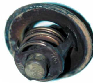
Рисунок 21-6: Термостат, застрявший в открытом положении – двигатель не в состоянии достичь рабочей температуры (слишком холодный). Если же клапан застрянет в закрытом положении – двигатель будет перегреваться; источник: Pearson Education, Inc
