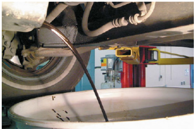
Фото 22-4. Снимите сливную пробку, и позвольте горячему маслу вытечь из двигателя. Соблюдайте осторожность во время этого шага, так как горячее масло может вызвать болезненные ожоги!
