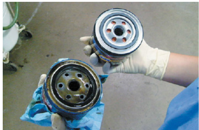
Фото 22-6. Сравните новый масляный фильтр со старым, чтобы быть уверенным, что сменяемый фильтр именно тот, который нужен для двигателя.
