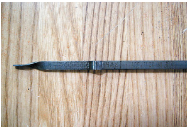
Фото 22-18. Уровень масла должен быть между линиями min и max. Как правило, на щупе между отметками расположена заматованная зона.
