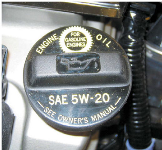
Рисунок 22-2: Классификационную характеристику моторного масла по вязкости обычно указывают на заливной горловине масляного картера двигателя; источник: Pearson Education, Inc.
