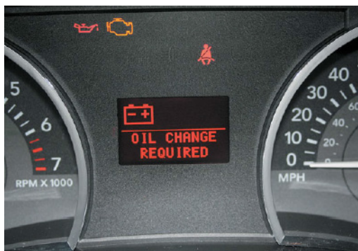
Рисунок 22-15: Некоторые производители автомобилей устанавливают устройства, информирующие водителя о пробеге до следующей смены масла, а некоторые производители прибегают к простому устройству, зажигающему предупреждающую лампу по достижении запланированного пробега до очередной смены масла; источник: Pearson Education, Inc.
