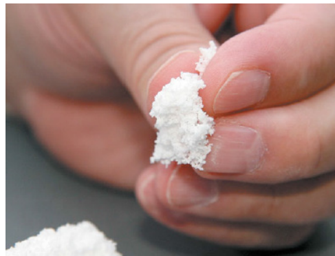
Рисунок 22-1: Улучшитель индекса вязкости ( VI ) – это полимер, внешне напоминающий мелко измельченный поролон. Растворенный в масле полимер расширяется при увеличении температуры, препятствуя вытеканию масла через масляные зазоры подшипников скольжения; источник: Pearson Education, Inc.
