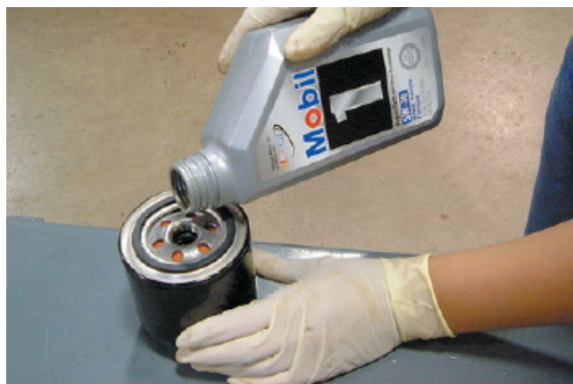
Фото 22-7. Опытный техник добавляет масло в масляный фильтр, если это возможно. Это обеспечивает быстрое наполнение фильтра во время пуска и снизит количество времени работы двигателя «на сухую»
