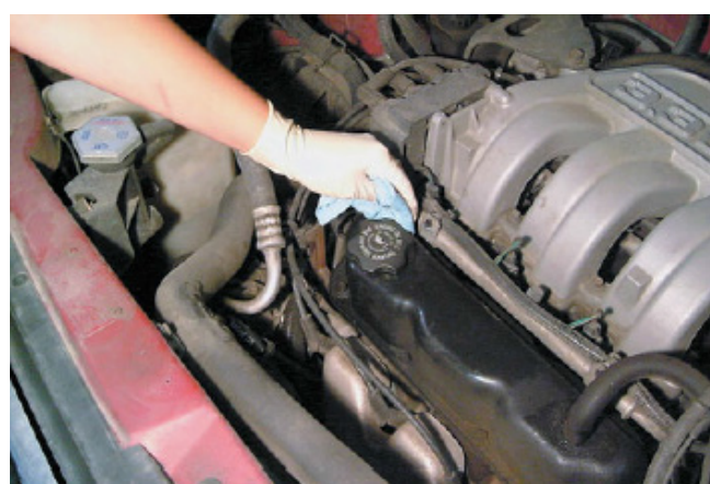
Фото 22-12. Опустите автомобиль, и очистите зону вокруг крышки для заливки масла перед её удалением.
