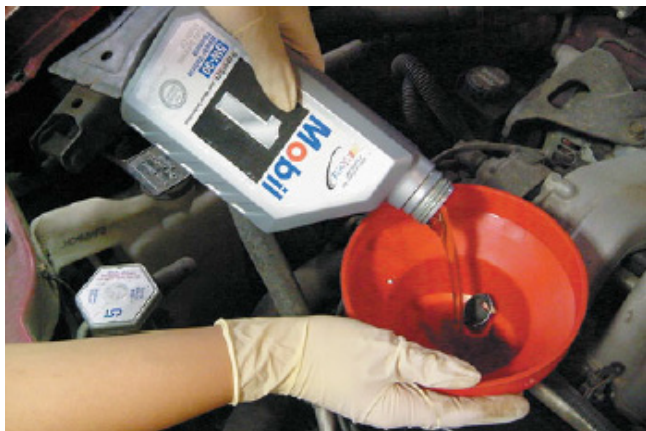
Фото 22-13. Используйте воронку, чтобы добавить указанное количество масла в двигатель через отверстие для заливки масла. Когда закончите заливку масла, установите пробку заливной горловины.
