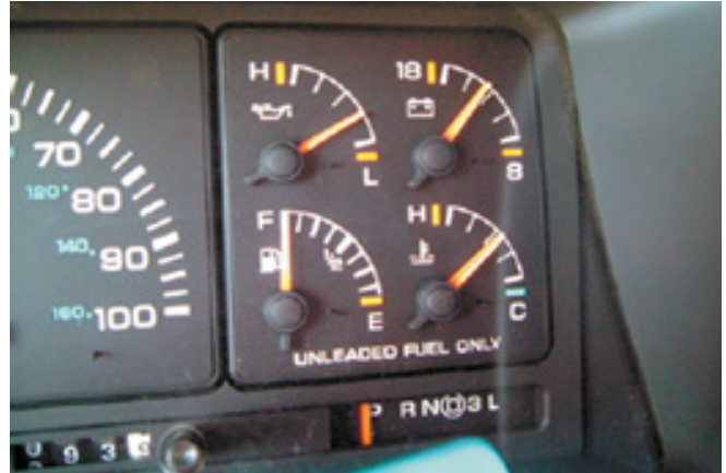
Фото 22-2. Запустите двигатель и дайте ему поработать до достижения нормальной рабочей температуры. Это позволит быстро слить горячее масло из двигателя.
