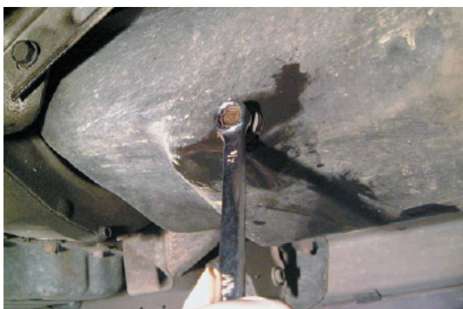
Фото 22-11. Внимательно осмотрите пробку для слива масла и её прокладку. Замените прокладку по мере необходимости. Установите сливную пробку на место и прочно затяните, но не перетягивайте!
