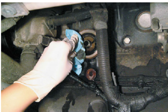
Фото 22-9. Внимательно осмотрите пробку для слива масла и её прокладку. Замените прокладку по мере необходимости. Установите сливную пробку на место и прочно затяните, но не перетягивайте!
