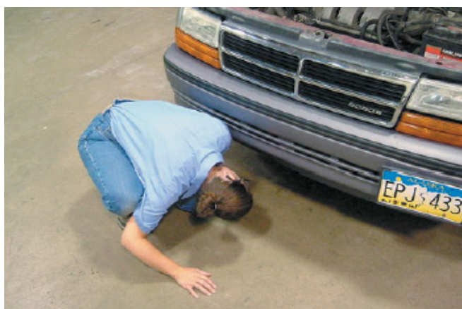
Фото 22-15. Остановите двигатель и подождите несколько минут, чтобы дать маслу стечь обратно в масляный поддон. Загляните под автомобиль и проверьте наличие утечек масла из-под пробки для слива масла, или из-под масляного фильтра.
