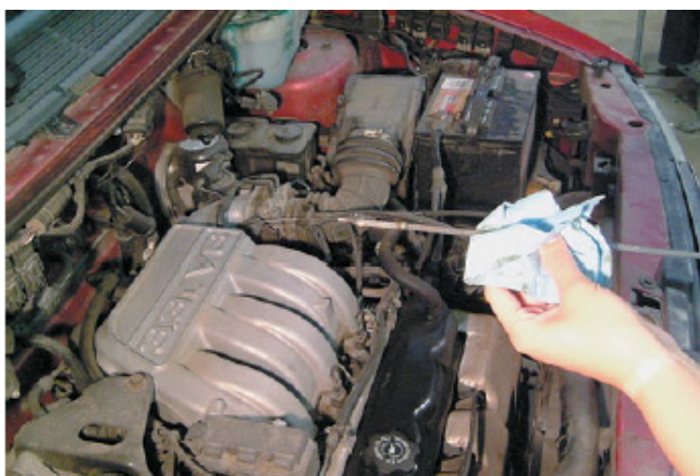
Фото 22-16. Выньте щуп оценки уровня масла, и протрите его с тканью или сервисной салфеткой.
