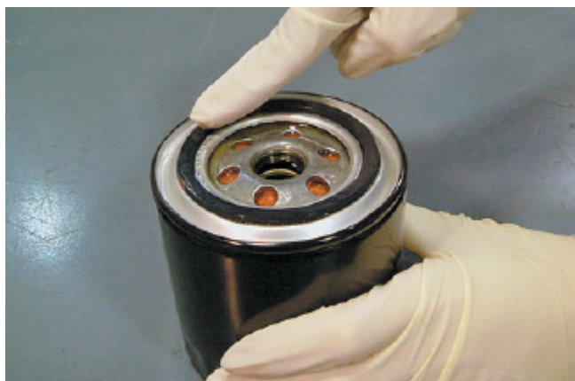
Фото 22-8. Установите новый масляный фильтр и затяните его от руки. Не используйте гаечный ключ для затягивания корпуса масляного фильтра! Большинство фильтров должны быть затянуты на 3/4 оборота после соприкосновения прокладки с площадкой двигателя.
