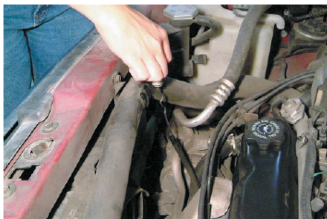
Фото 22-17. Вставьте щуп на его место, выньте и проверьте уровень масла по щупу.
