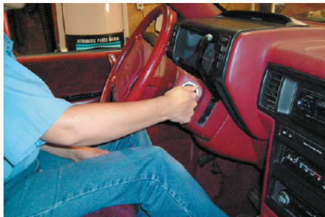
Фото 22-14. Запустите двигатель и дайте ему поработать на холостых оборотах, наблюдая за датчиком давления масла и/или контрольной лампой давления масла. Давление масла должно достичь нормального значения в течение 15 секунд после запуска двигателя.
