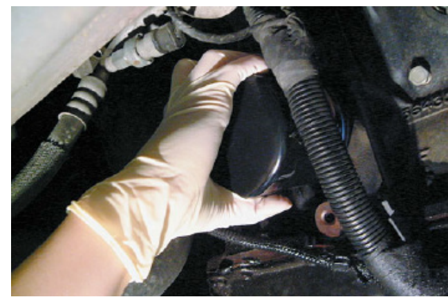
Фото 22-10. Опустите автомобиль, и очистите зону вокруг крышки для заливки масла перед её удалением
