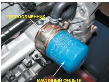
Рисунок 23-32: Масло охлаждается, протекая через адаптер, установленный между фильтром и площадкой крепления фильтра; источник: Pearson Education, Inc.
