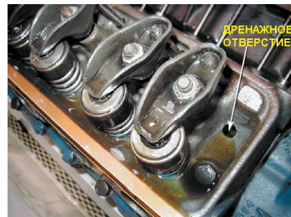
Рисунок 23-23: Масло направляется к коромыслам V-образного двигателя через полые толкатели. Масло возвращается в масляный поддон через дренажные отверстия в головке блока цилиндров; источник: Pearson Education, Inc.
