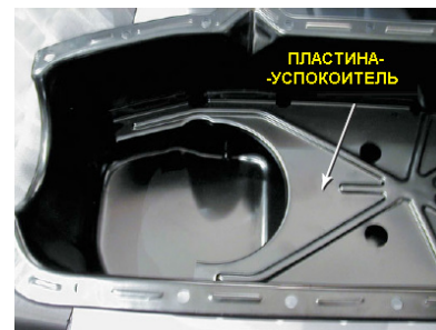
Рисунок 23-26: Типичный масляный поддон с встроенным отделителем, который используется, чтобы удержать масло от вспенивания вращающимся коленчатым валом и потоками воздуха, формируемыми поршнями; источник: Pearson Education, Inc.
