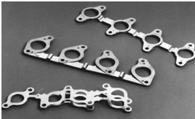
Рисунок 24-20: Типичные прокладки выпускного коллектора. Обратите внимание, что они, как правило, выполнены многослойными, чтобы позволить выпускному коллектору расширяться и сжиматься при нагревании и охлаждении; источник: Pearson Education, Inc
