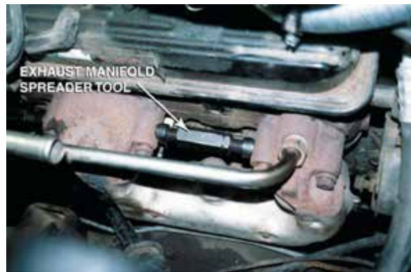
Рисунок 24-21: При повторной установке выпускного коллектора расширительный инструмент абсолютно необходим. Когда коллектор снимается с двигателя, коллектор имеет тенденцию слегка деформироваться, хотя двигателю дают остыть до снятия коллектора. Расширительный инструмент позволяет технику совместить отверстия для болтов без вреда для коллектора; источник: Pearson Education, Inc
