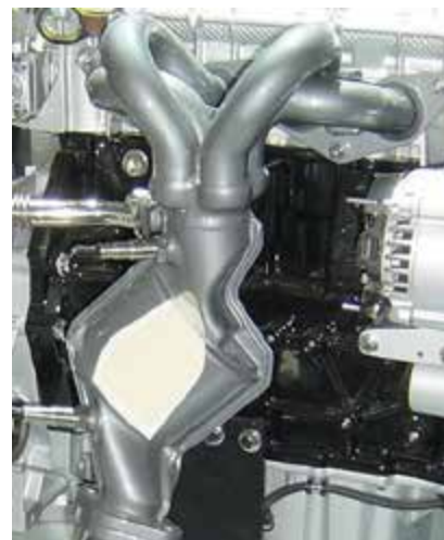
Рисунок 24-18: Многие выпускные коллекторы выполнены из выгнутых или сваренных стальных труб, и представляют собой соединяющиеся трубопроводы, обладающие минимальным аэродинамическим сопротивлением; это необходимо для улучшения производительность двигателя; источник: Zühlke
