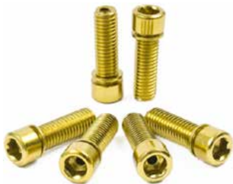
Рисунок 24-16: Болты крепления выпускного коллектора часто выполнены либо с полый головкой, либо полыми, что позволяет им быстро реагировать на изменение температуры коллектора.
