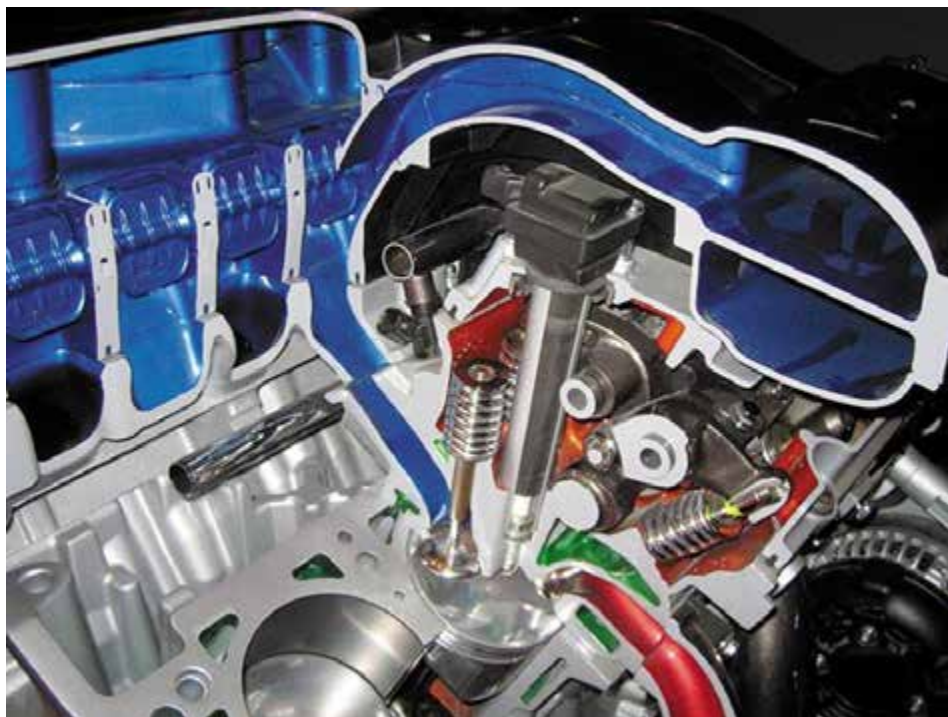
Рисунок 24-11: Воздух, поступающий в двигатель, может быть направлен через длинные или короткие русла для лучшей производительности и экономии топлива; источник: Pearson Education, Inc
