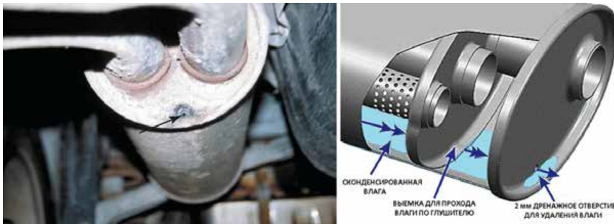
Рисунок 24-23: Маленькое отверстие в нижней части глушителя служит для выброса сконденсированной влаги из корпуса глушителя; источник: Pearson Education, Inc
