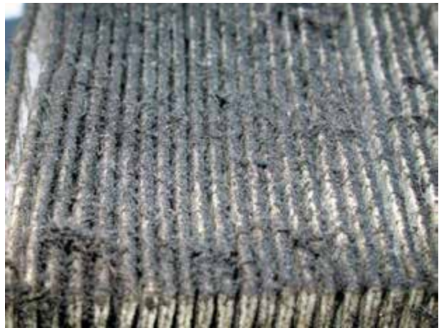
Рисунок 24-2: Пыль и грязь, находящаяся в воздухе, осели на поверхностях воздушного фильтра, поэтому они не попадали в двигатель; источник: Pearson Education, Inc
