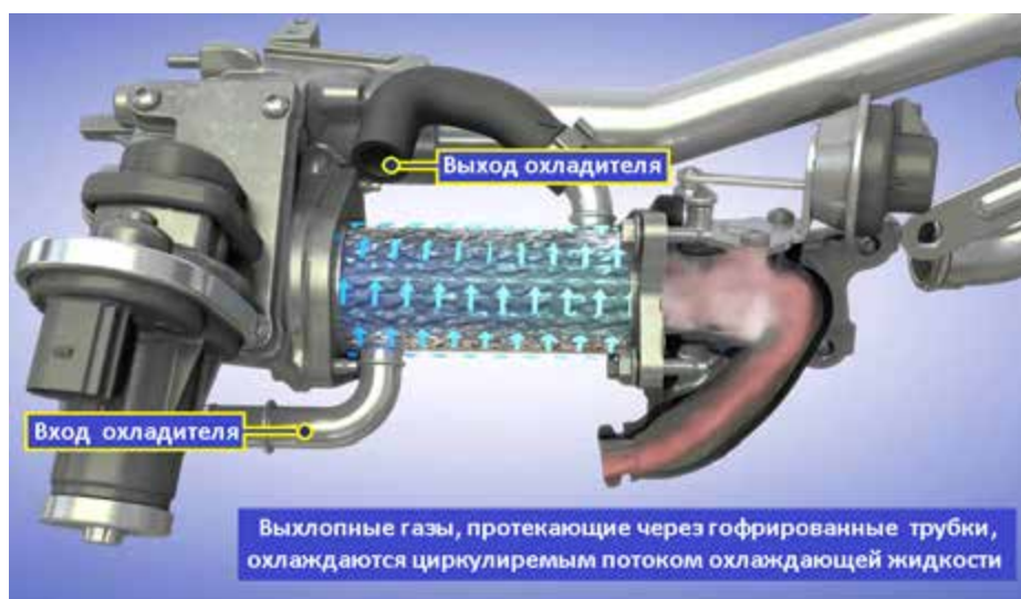
Рисунок 24-14: Жидкостное охлаждение отработавших газов перед их поступлением в клапан EGR .
