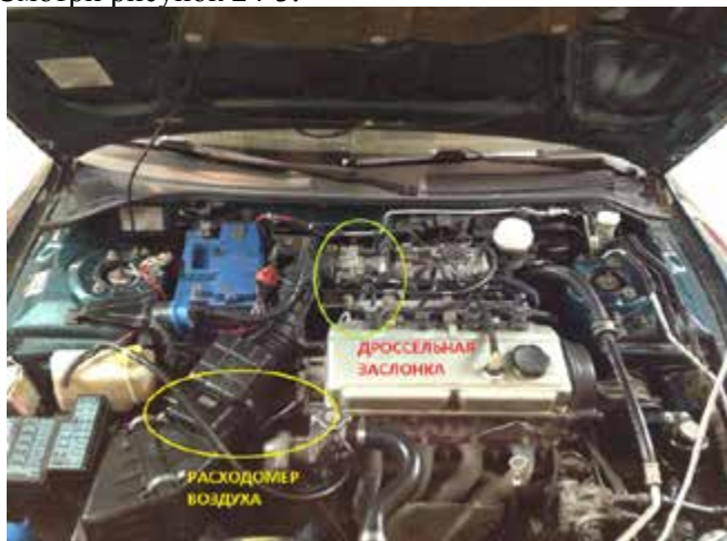
Рисунок 24-3: Большинство корпусов воздушных фильтров расположены на одной из сторон моторного отсека, и для соединения корпуса воздушного фильтра с корпусом дроссельной заслонки используется гибкий резиновый шланг.
