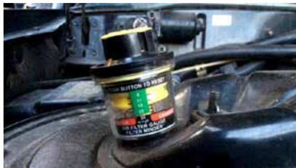
Рисунок 24-4: Типичный индикатор засорения воздушного фильтра. Индикатор становится красным, когда он выявляет достаточное ограничение движению воздуха, и фильтр требует замены.
