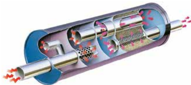
Рисунок 24-22: Выхлопные газы расширяются и охлаждаются, путешествуя через тонкие каналы в глушителе; источник: my-cardictionary
