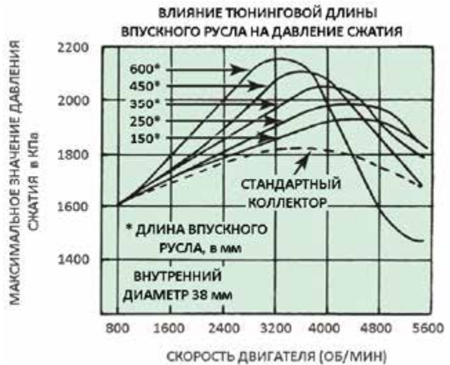
Рисунок 24-9: График показывает эффект звуковой настройки впускного коллектора изменением его длины. Чем больше протяженность русла впускного коллектора, тем ближе смещается максимальное значение крутящего момента в сторону низких оборотов коленчатого вала двигателя; источник: Pearson Education, Inc
