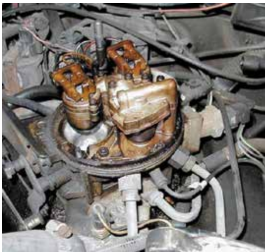
Рисунок 24-7: Узел впрыска топлива над дроссельной заслонкой, применяемой на двигателе GM V-6; источник: Pearson Education, Inc
