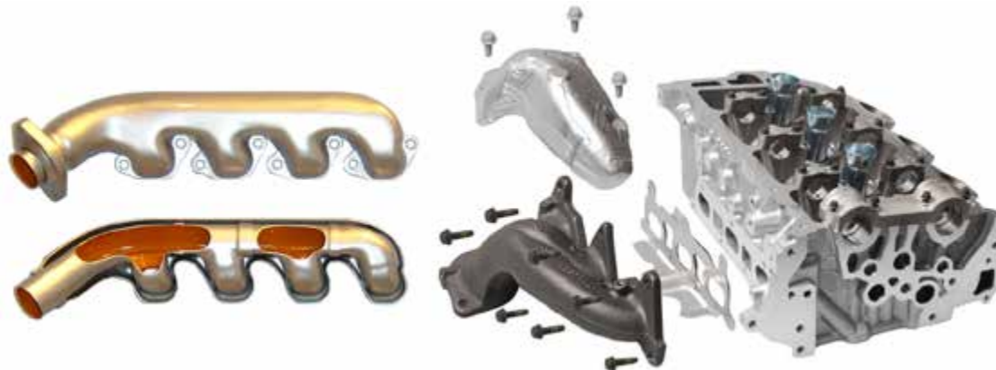
Рисунок 24-17: Часто выпускной коллектор оборудуют тепловым щитом (экраном), который помогает сохранить тепло, и снизить токсичность отработавших газов, реже, выхлопной коллектор выполнен 2-стенным, заключенным в несъемный кожух; источник: Worldcarfans u Zühlke
