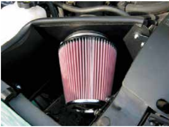
Рисунок 24-25: Высокопроизводительный неоригинальный воздушный фильтр часто может увеличить поток воздуха в двигатель для получения большей мощности, а дизайнерский наконечник выхлопной трубы в сочетании с грамотно рассчитанным резонатором, позволяет получить оригинальное звучание выхлопа.
