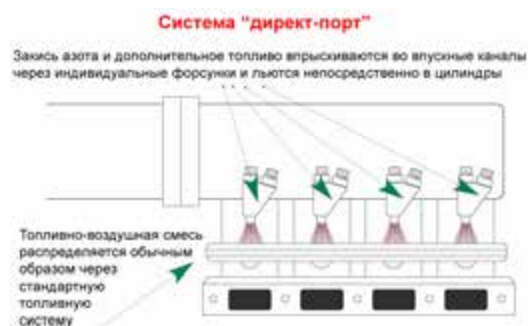
Рисунок 25-23: Система распределенного впрыскивания закиси азота и дополнительного топлива, получившая название «директ-порт»; источник: steer.ru
