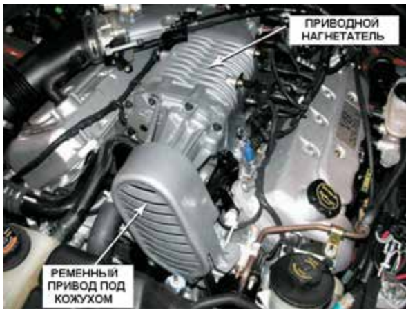
Рисунок 25-1: Механический нагнетатель V-образного двигателя автомобиля Ford; источник: Pearson Education, Inc.
