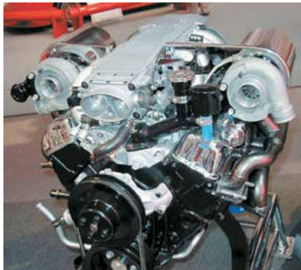
Рисунок 25-19: Двойной наддув применяют на V-образных двигателях небольшого объема для получения высокой мощности от относительно небольшого двигателя; источник: Pearson Education, Inc.
