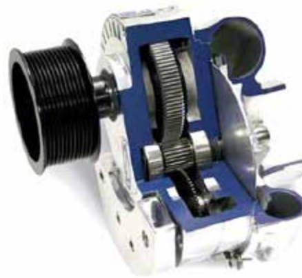
Рисунок 27-8: Передаточное число внутреннего редуктора центробежного нагнетателя позволяет уже на низких скоростях вращения коленчатого вала получить приемлемое давление наддува, необходимое для разгона двигателя.
