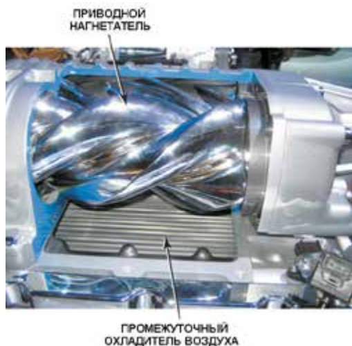
Рисунок 25-11: На автомобиле Ford используется приводной нагнетатель Руста и охладитель воздушного заряда (интеркулер), расположенный под нагнетателем. Охладитель воздушного заряда используется для снижения температуры сжатого воздуха перед его подачей в двигатель, чтобы увеличить плотность воздуха в свежем заряде; источник: Pearson Education, Inc.
