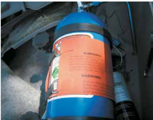
Рисунок 25-24: Электрический нагревательный мат устанавливается на баллон с закисью азота для повышения давления газа внутри него; источник: Pearson Education, Inc.
