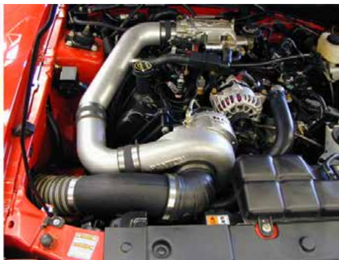
Рисунок 24-9: Установка центробежного приводного компрессора Vortech (слева) и Paxton (справа) в подкапотном пространстве автомобилей.
