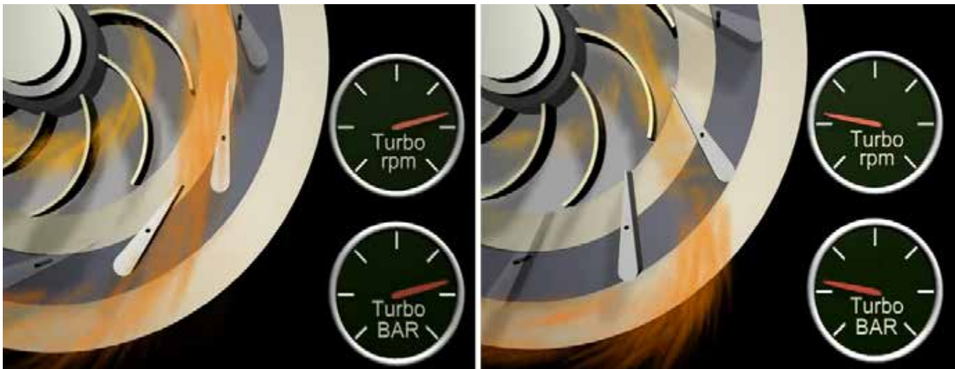
Рисунок 25-20: Схематическое изображение принципа регулирования давления наддува в турбокомпрессоре с изменяемой геометрией. На рисунке слева небольшое количество выхлопных газов быстро разгоняет турбинное колесо до высокой скорости, что обеспечивает высокое давление наддува; на рисунке справа большое количество газа поступает через направляющий аппарат на лопатки турбины под таким углом, что часть газов тормозят вращение турбинного колеса, при этом быстро снижается скорость вращения турбины и давление наддува.
