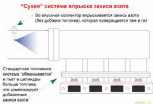
Рисунок 25-21: Сухая система впрыска закиси азота; источник: steer.ru
