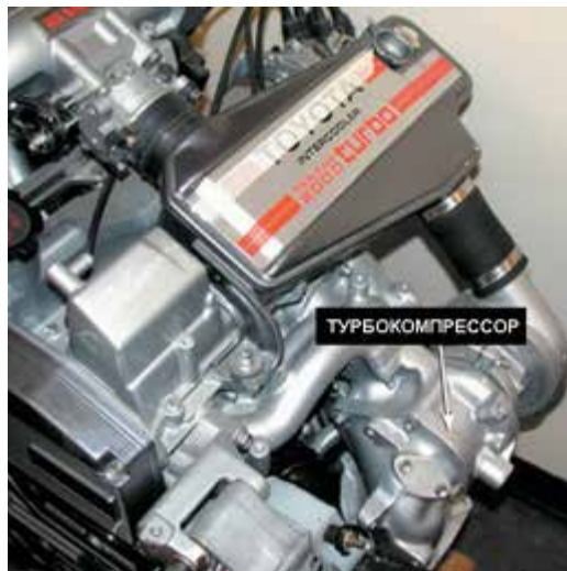
Рисунок 25-2: Газотурбинный нагнетатель на двигателе, применяемом на автомобилях Toyota/Lexus; источник: Pearson Education, Inc.
