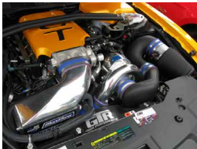
Рисунок 24-9: Установка центробежного приводного компрессора Vortech (слева) и Paxton (справа) в подкапотном пространстве автомобилей.
