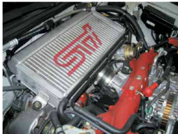
Рисунок 25-17: Устройство, установленное в верхней части моторного отсека этой Субару, который выглядит как радиатор - это и есть промежуточный охладитель (интеркулер), в котором охлаждается сжатый турбокомпрессором воздух; источник: Pearson Education, Inc.
