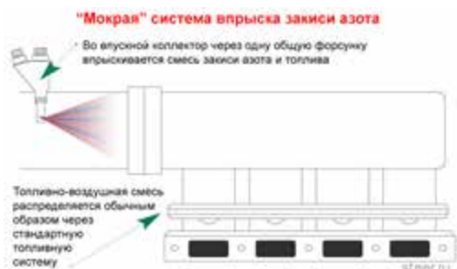
Рисунок 25-22: Мокрая система впрыскивания закиси азота; источник: steer.ru
