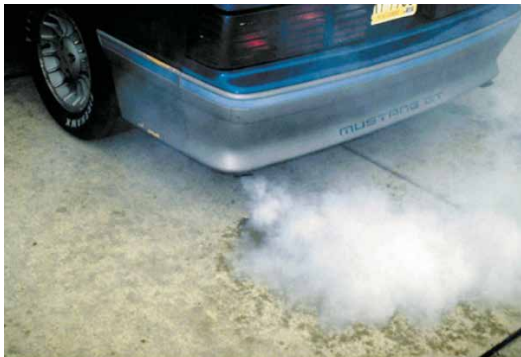
Рисунок 26-2: Большое количество белого пара из выхлопной трубы указывает на то, что нарушена целостность прокладки головки блока, что позволяет охлаждающей жидкости поступать в цилиндры двигателя, где жидкость превращается в пар; источник: Pearson Education, Inc.
