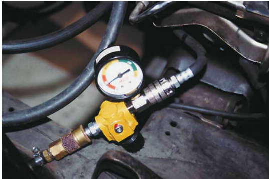
Рисунок 26-13: Типичный портативный тестер цилиндрических утечек; источник: Pearson Education, Inc.
