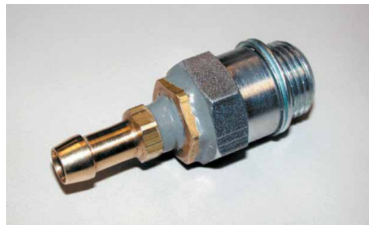
Рисунок 26-28: Самодельный адаптер, выполненный для подключения манометра к отверстию для кислородного датчика; источник: Pearson Education, Inc.
