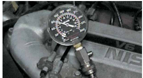
Фото 26-8: Запишите показания манометра, которые были достигнуты при первом всасывании воздуха в испытуемый цилиндр. Если показания при первом всасывании были низки, но при последующих тактах сжатия давление с каждым всасыванием увеличивалось, существует проблема с компрессионными кольцами, которую следует внести в протокол испытаний.
