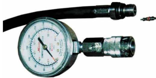
Рисунок 26-10: На снимке показан компрессометр, состоящий из двух частей. В свечное отверстие вворачивается шланг, на другой части которого расположено быстросъемное соединение для подключения манометра; Pearson Education, Inc.
