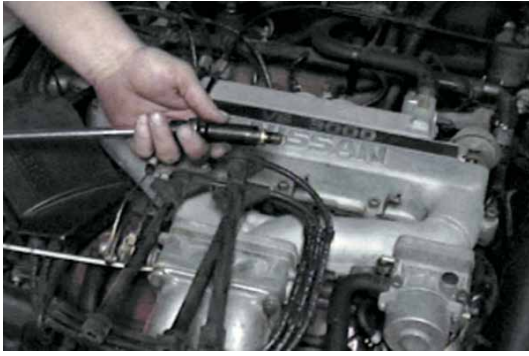
Фото 26-5: Перед снятием свечей зажигания пометьте свечные провода, чтобы при подключении не возникло путаницы. Затем снимите все свечи зажигания.
