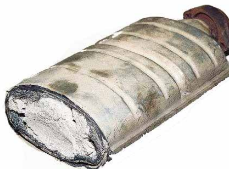
Рисунок 26-27: На снимке показан разрезанный катализатор, керамическая сердцевина которого оплавилась в результате перегрева; источник: motorhelp.ru
