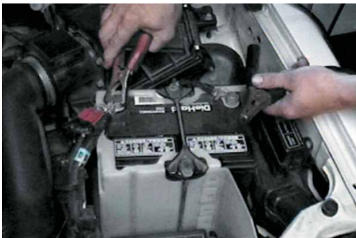
Фото 26-7: При необходимости, перед началом испытаний подключите пуско-зарядное устройство к клеммам батарейных проводов. Важно, чтобы при последовательном тестировании каждого из цилиндров электрическим стартером обеспечивалась одинаковая скорость вращения коленчатого вала.
