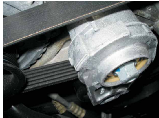
Рисунок 26-6: На снимке – дополнительный натяжитель ремня. Большинство натяжителей имеют метку, по которой можно судить о нормальном состоянии, или чрезмерном растяжении приводного ремня. Как натяжитель, так и растянутый приводной ремень может стать причиной появления шума; источник: Pearson Education, Inc.
