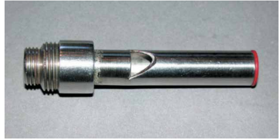
Рисунок 26-14: Свисток остановки используется для поиска верхней мертвой точки. Снимите свечу зажигания и установите свисток остановки, затем проверните двигатель вручную. Когда свист прекращается, не издавая ни звука, поршень расположен в верхней мертвой точке (ВМТ); источник: Pearson Education, Inc.
