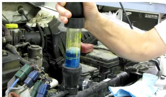
Рисунок 26-31: Отбор газа из радиатора бензинового двигателя с помощью ручной помпы, входящей в комплект тестера утечек выхлопного газа.
