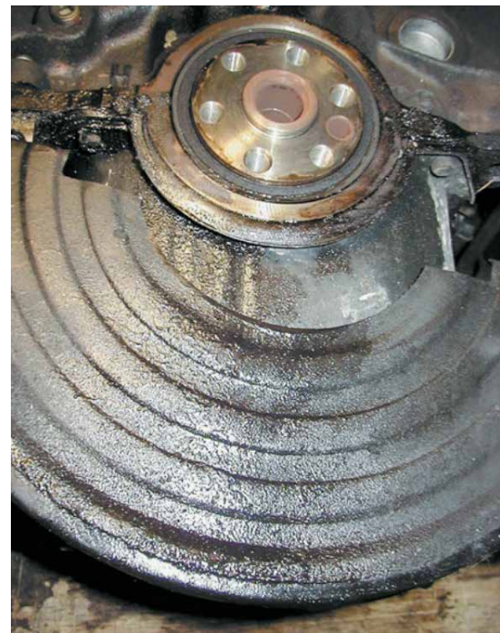
Рисунок 26-4: Коробка передач и маховик были демонтированы, чтобы уточнить место утечки масла из-под маховика двигателя. На снимке видно, что утечка может произойти как в результате повреждения заднего уплотнения коленчатого вала, так и в результате повреждения прокладки между поддоном и опорой коленчатого вала; источник: Pearson Education, Inc.
