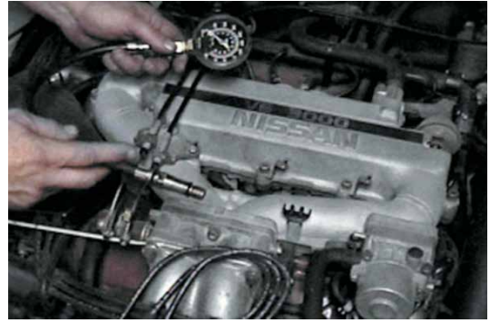
Фото 26-6: Выберите соответствующий адаптер для компрессометра. Резьба на адаптере должна соответствовать размеру резьбы, указанной на свече.
