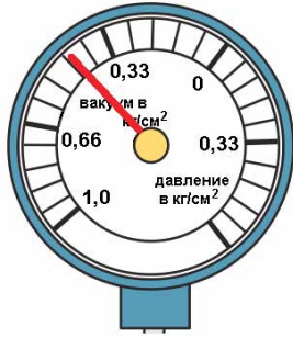
Рисунок 26-17: Стабильные, но низкие показатели разрежения указывают на запаздывание зажигания или открытия впускного клапана; источник: Pearson Education, Inc.
