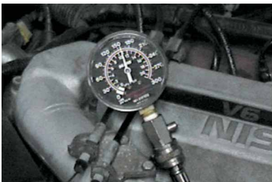
Фото 26-9: После того, как испытуемый цилиндр двигателя совершил четыре такта сжатия, остановите стартер и отметьте показания компрессометра.
