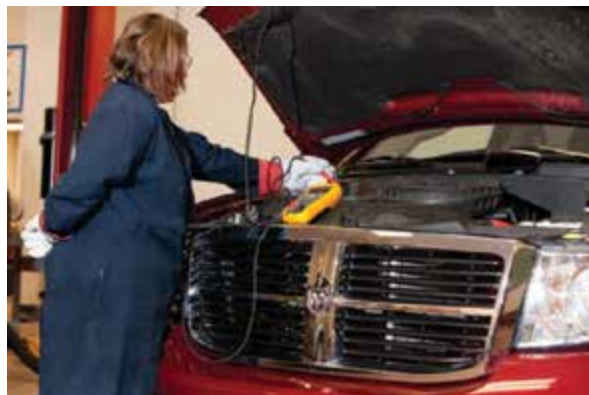
Рисунок 27-10: Придерживайтесь правил проведения измерений высоковольтного напряжения «одной рукой»; источник: Delmar/Cengage Learning
