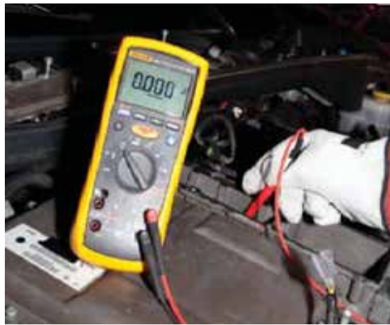
Фото 27-1-9: Используйте цифровой мультиметр, чтобы подтвердить, что высоковольтные контуры имеют напряжение 0 вольт перед началом процедуры обслуживания высоковольтной системы автомобиля.
