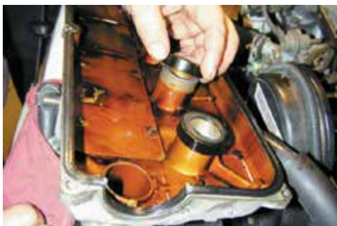
Фото 27-2-17: После завершения регулировок всех клапанов и проверки правильности регулировок, начинаем процедуру сборки, руководствуясь указаниями производителя. Меняем все уплотнительные прокладки, если это рекомендовано производителем, или осматриваем их, и меняем по мере необходимости.
