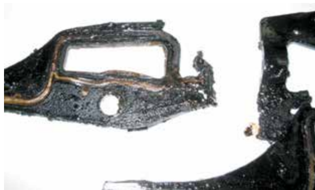
Рисунок 27-3: Прокладка впускного коллектора получила повреждение, в результате чего охлаждающая жидкость попала в цилиндр двигателя, вызвав гидравлический замок; источник: Pearson Education, Inc
