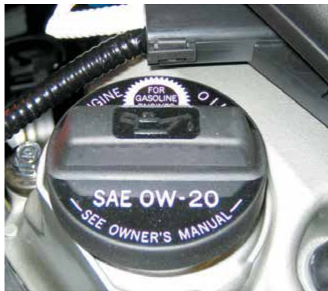
Рисунок 27-16: Всегда используйте вязкость масла, которая указана на крышке заливной горловины; источник: Pearson Education, Inc
