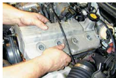
Фото 27-2-18: Устанавливаем клапанную крышку, соблюдая осторожность, и проверяя, не зажат ли провод или вакуумный шланг между крышкой и головкой цилиндров.
