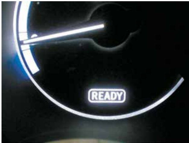
Рисунок 27-8: На приборной панели гибридных автомобилей Toyota/Lexus расположен световой индикатор готовности. Если индикатор готовности светится, двигатель может запуститься в любое время без предупреждения; источник: Pearson Education, Inc
