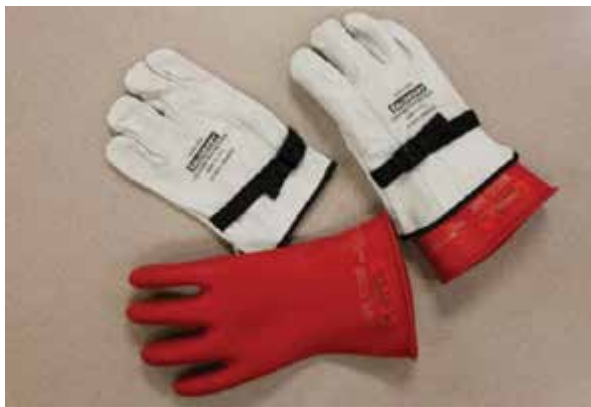
Рисунок 27-11: Диэлектрические перчатки класса «0» должны быть проверены перед началом работ, связанных с обслуживанием высоковольтных систем; источник: Delmar/Cengage Learning
