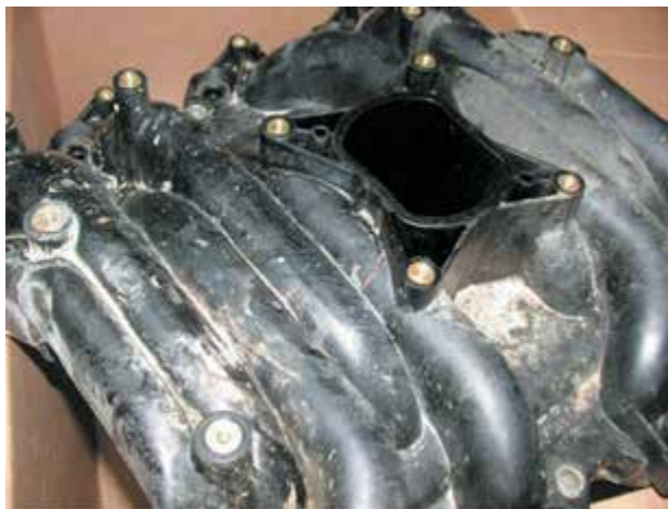
Рисунок 27-5: Верхняя часть впускного коллектора, часто именуемая пленумом, или коробом, крепится к нижней части впускного коллектора; источник: Pearson Education, Inc
