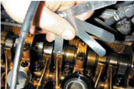
Фото 27-2-15: Специалист с помощью пластинчатых щупов толщиной на 0,05 мм больше и на 0,05 мм меньше требуемого зазора проверяет правильность регулировки зазора.
