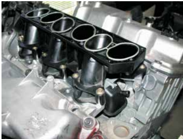
Рисунок 27-4: Нижняя часть впускного коллектора крепится к головкам цилиндра болтами; источник: Pearson Education, Inc
