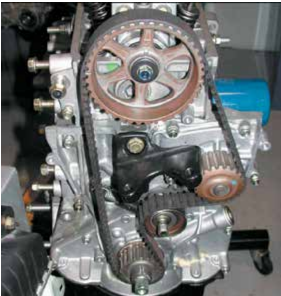
Рисунок 27-7: Ремень привода газораспределительного механизма часто вращает приводное зубчатое колесо водяного циркуляционного насоса (водяной помпы); источник: Pearson Education, Inc
