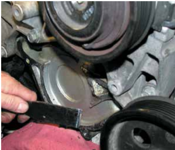
Рисунок 27-2: Соблюдайте осторожность при использовании стального скребка для удаления прокладок с поверхностей алюминиевых деталей. Лучше всего использовать деревянный или пластиковый скребок; источник: Pearson Education, Inc
