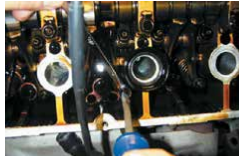
Фото 27-2-16: Регулировка клапана занимает обе руки – одной держим гаечный ключ, чтобы ослабить и затянуть контргайку, а второй рукой держим отвертку, чтобы вращать регулировочный винт. Всегда дважды проверяйте отрегулированный зазор, не забывая о том, что зазоры у впускных и выпускных клапанов могут отличаться.
