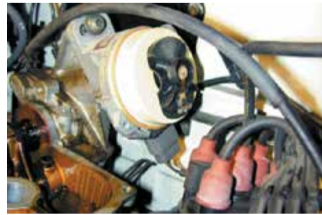
Рисунок 27-2-14: На двигателях, оснащенных распределителем зажигания, можно определить, в каком цилиндре заканчивается такт сжатия. Ротор распределителя будет направлен в сторону выводной клеммы того цилиндра, в котором надо производить регулировку. Всегда следуйте указаниям производителя, который подробно описывает процедуры регулирования тепловых зазоров в клапанах (если регулировки предусмотрены).
