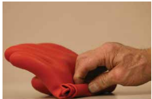
Рисунок 27-12: Перед каждым использованием проведите испытание перчаток на утечку воздуха; Delmar/Cengage Learning
