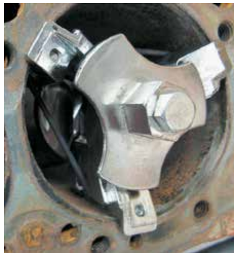
Рисунок 28-13: Образовавшийся в цилиндре выступ удаляется режущим инструментом типа развертки перед извлечением поршневого узла из цилиндра двигателя; источник: Pearson Education, Inc.
