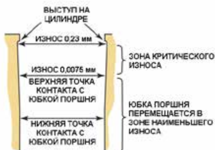
Рисунок 28-12: Наибольший износ цилиндра происходит в области прилегания верхнего компрессионного кольца, вблизи нахождения поршня в верхней мертвой точки. Износ обусловлен силой прижатия компрессионного кольца к стенке цилиндра за счет пружинных свойств, суммируемых с давлением горящих газов. Верхнее компрессионное кольцо работает в условиях недостаточной смазки; источник: Pearson Education, Inc.
