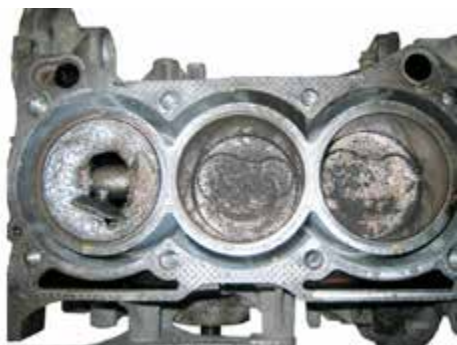
Рисунок 28-9: Иногда после снятия головки цилиндров выявляется, что поломки столь серьезны, что двигатель невозможно отремонтировать, и единственным вариантом ремонта остается замена блока цилиндров и/или головки цилиндров; источник: Pearson Education, Inc.
