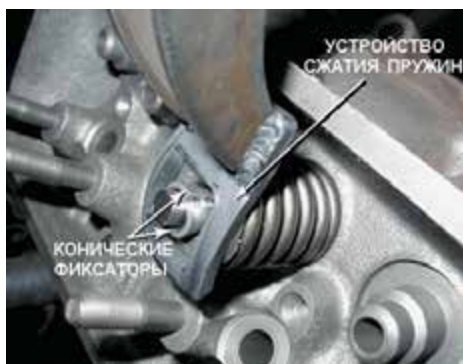
Рисунок 28-20: Клапанную пружину надо сжать столь сильно, чтобы сухари клапана вышли из верхней тарелки клапанной пружины; источник: Pearson Education, Inc.
