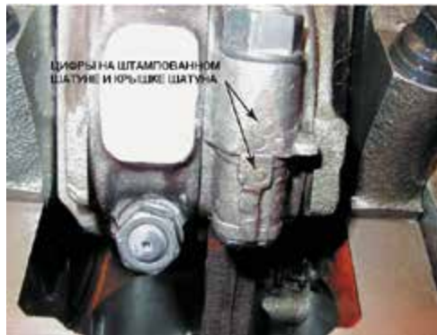
Рисунок 28-10: Эти шатуны и крышки шатунов были пронумерованы с завода. Если нумерации нет, то шатуны и крышки шатунов перед разборкой следует пометить; источник: Pearson Education, Inc.
