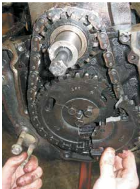
Рисунок 28-15: После снятия крышки привода ГРМ была обнаружена поломка звездочки привода распределительного вала этого V-6 двигателя. Естественно, при такой поломке двигатель не мог работать; источник: Pearson Education, Inc.
