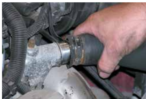
Фото 28-4: Отсоедините все шланги системы охлаждения и отопителя салона, а также снимите радиатор.
