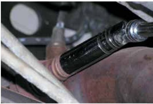
Фото 28-9: Обеспечивая безопасность, поднимите автомобиль, и отсоедините выхлопную систему от выпускного коллектора.
