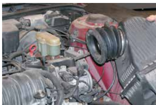
Фото 28-6: Снимите систему впуска воздуха, включая корпус воздушного фильтра, если это необходимо.
