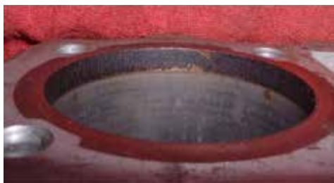
Рисунок 28-11: Выступ в верхней части цилиндра необходимо удалить, чтобы избежать поворота кольца на ребро и разрушения канавок поршня; источник:
