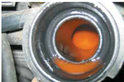
Фото 28-3: Слейте охлаждающую жидкость, и утилизируйте ее надлежащим образом.
