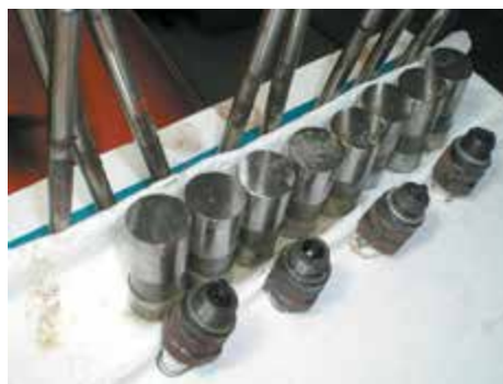
Рисунок 28-8: Хранение штанг толкателей и самих толкателей отсортированный по цилиндрам, в том числе свечей зажигания – мудрый способ действий при разборке головки цилиндров; источник: Pearson Education, Inc.
