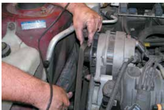
Фото 28-5: Снимите крышку приводного ремня/ремней, снимите и уложите в стороне генератор, насос гидроусилителя рулевого управления и компрессор кондиционера.
