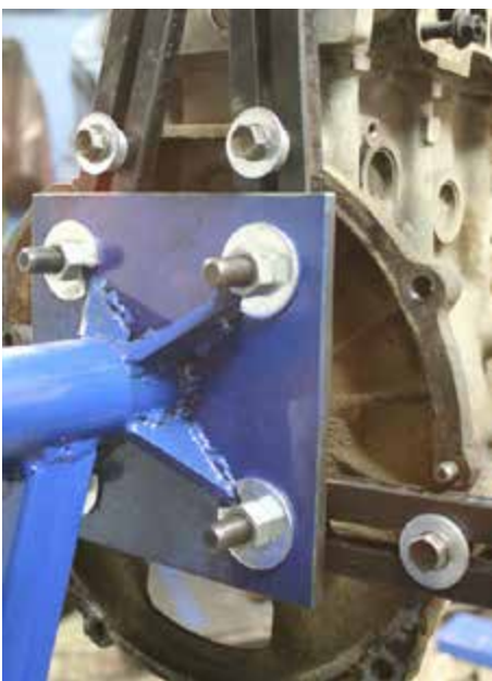
Рисунок 28-7: Всегда используйте градуированные болты—либо 5, либо 8 класса прочности при установки двигателя на стенд; источник: garage98
