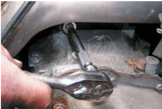
Фото 28-11: Опустите автомобиль и снимите болты крепления двигателя и коробки передач и удалите крепеж колокола сцепления.
