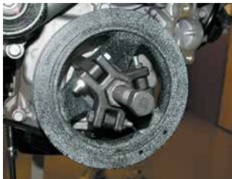
Рисунок 28-14: Съемник используется для того, чтобы стянуть демпфер крутильных колебаний с коленчатого вала; источник: Pearson Education, Inc.
