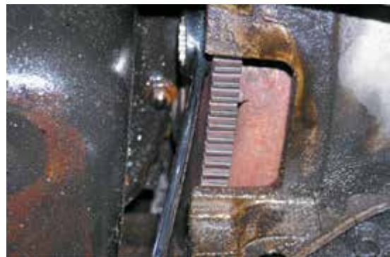
Фото 28-10: Промаркируйте и снимите крепежные детали, соединяющие гибкую пластину с гидротрансформатором.
