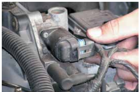
Фото 28-7: Снимите электрические разъемы со всех датчиков и промаркируйте их.
