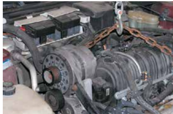
Фото 28-12: Присоедините крючки подъемных цепей к двигателю, и осторожно извлеките двигатель из автомобиля.
