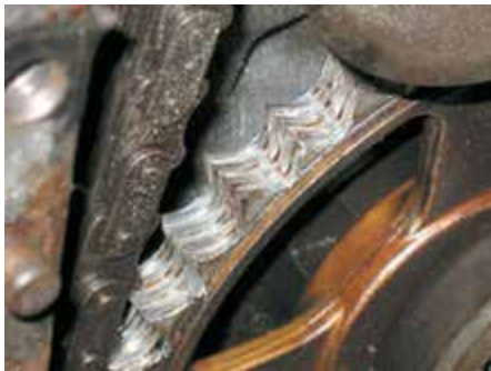
Рисунок 28-1: Износ зубчатого колеса может проявиться в отставании фаз газораспределения, и снижение производительности двигателя; источник: Pearson Education, Inc.
