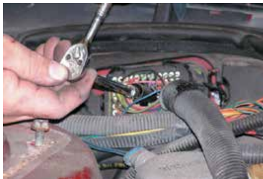
Фото 28-8: Отсоедините жгут проводов двигателя, и отсоедините разъем на переборке.
