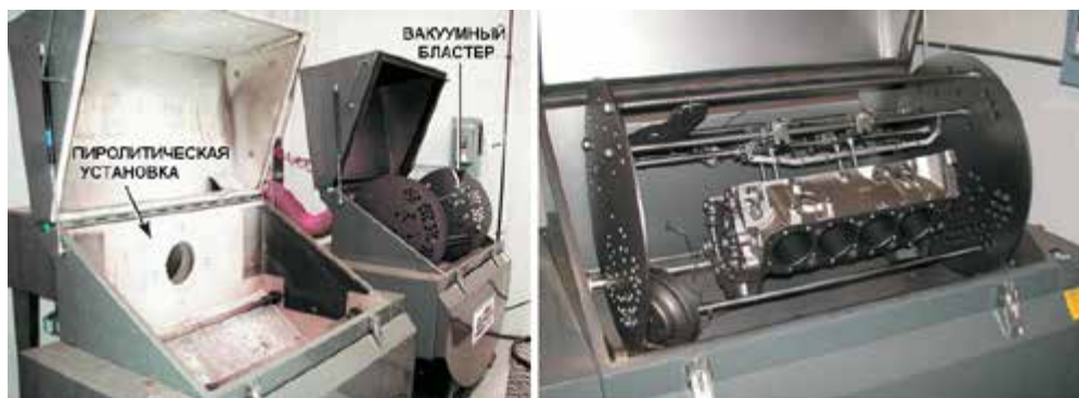
Рисунок 29-7: (а) В пиролитической (высокотемпературной) установке очистка деталей двигателя производится путем их обжига. После высокотемпературного обжига детали помещают в установку для вакуумной обработки. В этой же установке очищенную деталь подвергают дробеструйной обработке с одновременным удалением отслоившихся загрязнений из вакуумной камеры. (б) На снимке справа показана очищенная в пиролитической установке головка цилиндров; источник: Pearson Education, Inc.
