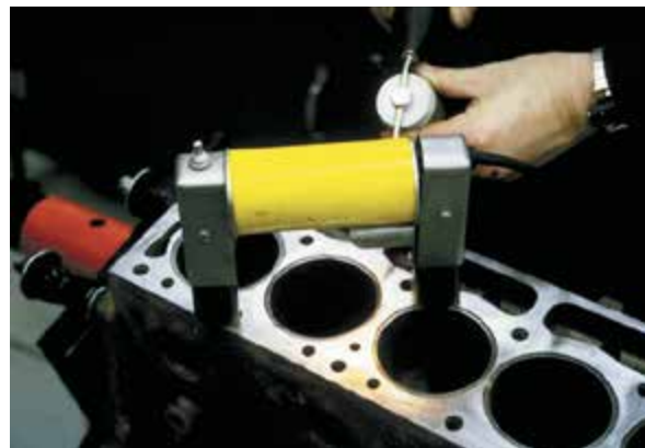
Рисунок 29-9: Верхняя сопрягаемая с головкой цилиндров поверхность блока цилиндров подвергается магнитной дефектоскопии на наличие трещин с помощью специального электромагнитного оборудования, возбуждающего сильное магнитное поле; источник: Pearson Education, Inc.
