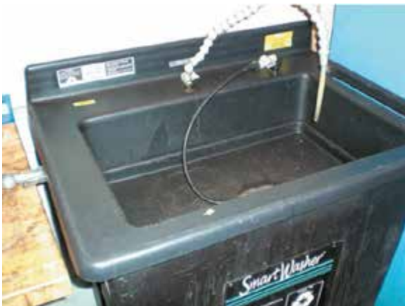
Рисунок 29-6: В установках для микробиологической очистки используются микроорганизмы, которые питаются маслами и мазутными отложениями; источник: Pearson Education, Inc.
