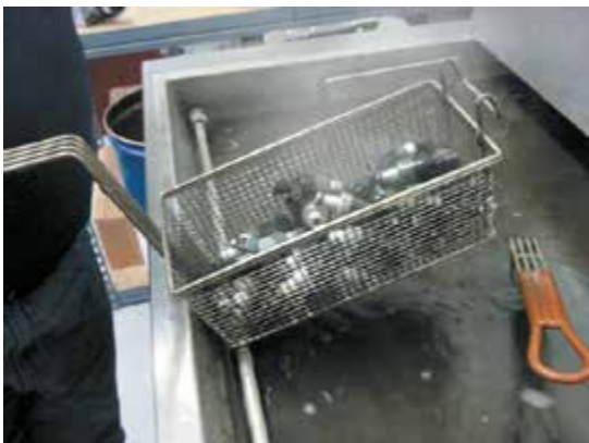
Рисунок 29-8: Ультразвуковой очистке подвергаются и топливные форсунки бензиновых двигателей, не разбирая их; источник: Pearson Education, Inc.
