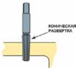
Рисунок 29-15: Формирование отверстия с помощью конической развертки; источник: Pearson Education, Inc.
