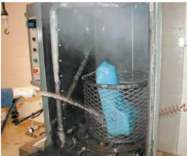
Рисунок 29-5: Струя моющего раствора, выходящего из сопла, смывает грязь и смазку с поверхностей деталей. После мойки детали следует ополоснуть чистой водой для удаления моющего раствора и мусора, который может попасть в детали при струйной мойке в камере; источник: Pearson Education, Inc.
