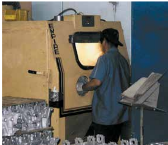
Рисунок 29-4: Небольшие детали двигателя целесообразно очищать в стационарной дробеструйной кабине; источник: Pearson Education, Inc.
