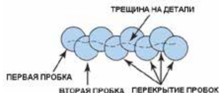
Рисунок 29-19: Перекрывание устанавливаемых резьбовых пробок; источник: Pearson Education, Inc.
