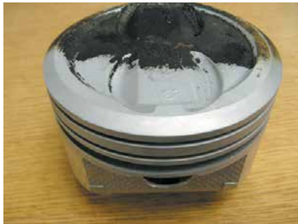
Рисунок 29-3: Для очистки деталей двигателя рекомендуют использовать соду, поскольку она способна растворяться в воде или масле, в отличие от песка или стеклянных бусин, используемых при дробеструйной/пескоструйной обработке; источник: Pearson Education, Inc.
