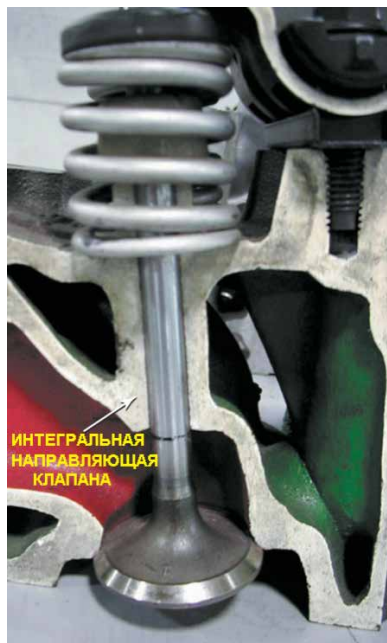
Рисунок 30-29: Интегральная направляющая – это сверление в чугунной головке цилиндров. В чугунной головке цилиндров седло клапана также выполнено прямо в материале головки; источник: Pearson Education, Inc.
