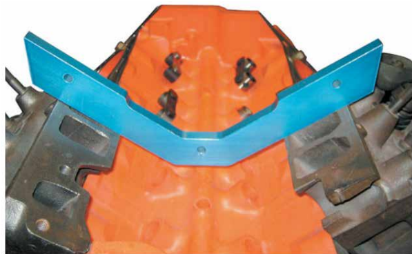
Рисунок 30-28: Используйте шаблон для проверки правильных углов прилегания после выполнения механической обработки привалочной плоскости прокладки головки цилиндров; источник: Pearson Education, Inc.
