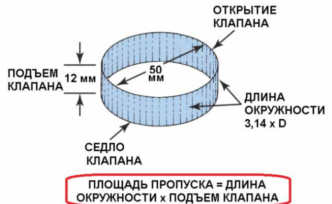
Рисунок 30-7: Метод определения пропускного сечения открытого клапана; источник: Pearson Education, Inc.
