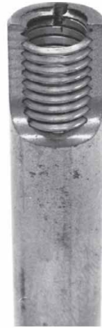
Рисунок 30-40: установленная бронзовая спираль внутри направляющей клапана; источник: Pearson Education, Inc.
