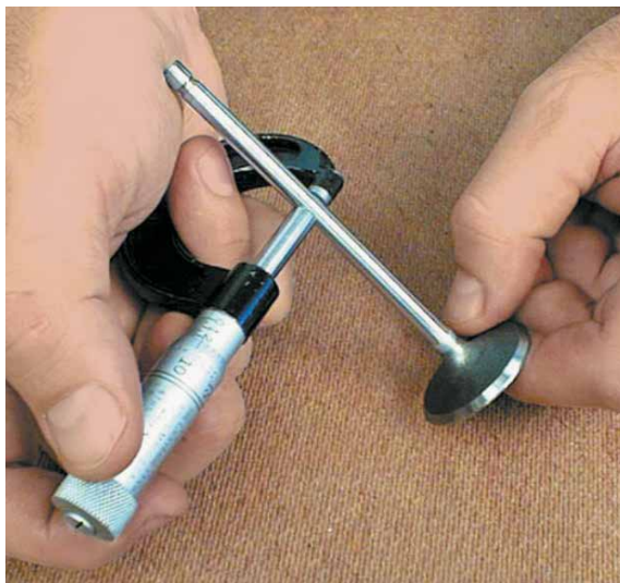
Рисунок 30-34: Диаметр стержня клапана измеряется с помощью микрометра. Разница между внутренним диаметром направляющей клапана и диаметром штока клапана является зазором между стержнем клапана и направляющей; источник: Pearson Education, Inc.
