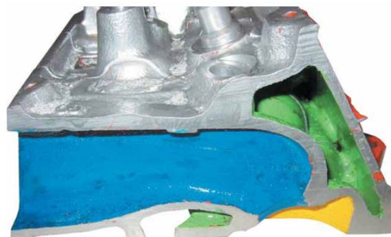
Рисунок 30-14: На снимке показан длинный газовый канал впуска свежего заряда (окрашено синим) и каналы охлаждения головки цилиндров (окрашены зеленым); источник: Pearson Education, Inc.
