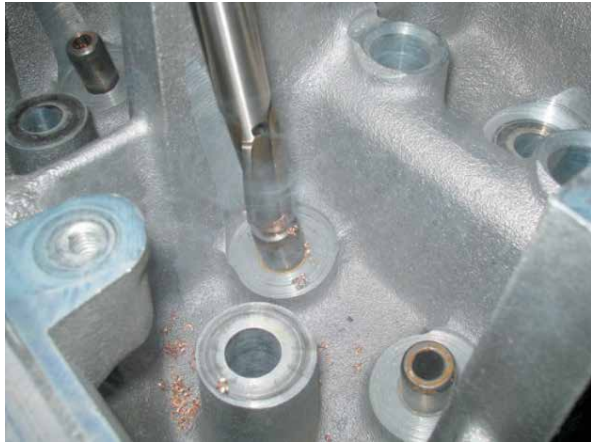
Рисунок 3-39: Обрезка верхней части вставленной втулки; источник: Pearson Education, Inc.
