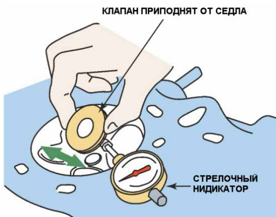
Рисунок 30-35: Измеренный зазор между стержнем клапана и его направляющей при раскатке клапана из стороны в сторону не способны дать сравнимого со спецификацией результата, поскольку в технических условиях, как правило, приводится зазор, полученный в результате вычитания диаметров. Тем не менее, этот метод позволяет оценить состояние направляющих клапанов, сравнивая результаты измерений в нескольких клапанах двигателя; источник: Pearson Education, Inc.
