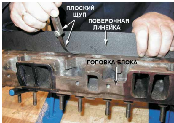
Рисунок 30-20: Для проверки состояния сопрягаемой с прокладкой поверхности используют плоский щуп и поверочную линейку; источник: Pearson Education, Inc.
