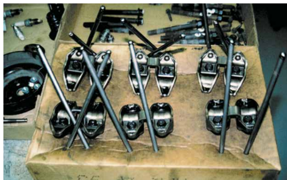
Рисунок 30-18: Штанги толкателей клапанов лучше всего держать вместе со снятыми деталями клапанного механизма по их принадлежности, используя коробку из жесткого картона. Этот способ хранения позволяет сгруппировать детали в таком порядке, как они снимались с двигателя; источник: Pearson Education, Inc.
