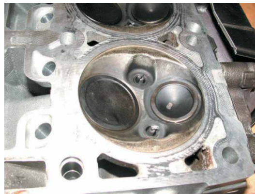
Рисунок 30-4: Показанная на снимке камера сгорания 5,7-литрового двигателя Chrysler Hemi имеет две свечи зажигания и два клапана, расположение которых позволяет улучшить условия воспламенения смеси, обеспечивает полноту сгорания топлива, повышая эффективность, и снижая эмиссию вредных веществ; источник: Pearson Education, Inc.
