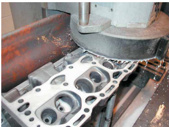
Рисунок 30-22: Повторная чистовая обработка огневой палубы чугунной головки блока производится абразивным кругом большого диаметра; источник: Pearson Education, Inc.
