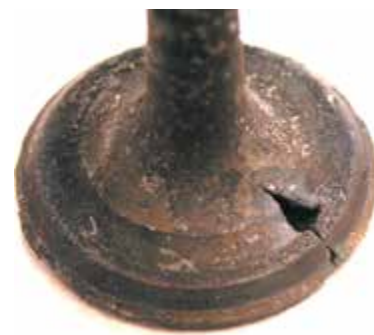
Рисунок 31-11: Образование сквозного отверстия в тарелке клапана изначально было вызвано получением теплового удара; последующее разрушение клапана происходило в результате прорыва выхлопных газов через образовавшуюся трещину; источник: Pearson Education, Inc.
