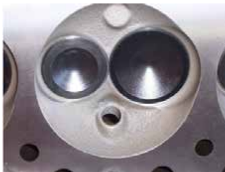
Рисунок 31-3: Впускной клапан имеет больший диаметр, чем выпускной клапан, поскольку свежий заряд в атмосферном двигателе всасывается в цилиндр за счет разницы между атмосферным давлением и разрежением, создаваемым нисходящим движением поршня. Выпуск отработавших газов происходит при восходящем движении поршня, который фактически выталкивает газы из цилиндра. Выпускной клапан меньшего диаметра «оставляет» больше места для впускного клапана.
