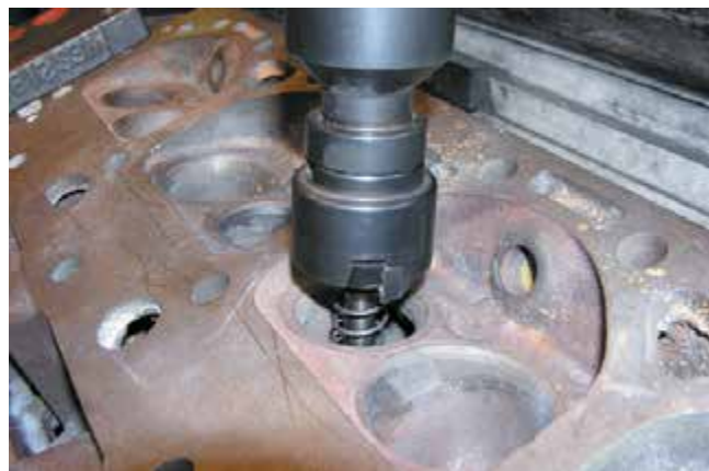
Фото 31-8: Установите режущую головку на направляющий стержень (пилот).
