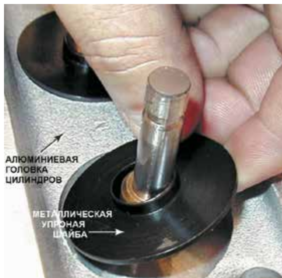
Рисунок 31-52: Металлическая упорная шайба должна быть установлена между клапанной пружиной и головкой цилиндра. Некоторые производители автомобильных двигателей используют комбинированную упорную шайбу, включающую в состав позитивное уплотнение штока клапана; источник: Pearson Education, Inc.
