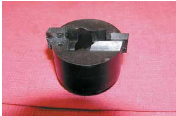
Фото 31-4: Подберите правильную режущую головку, и убедитесь, что резцы хорошо заточены.
