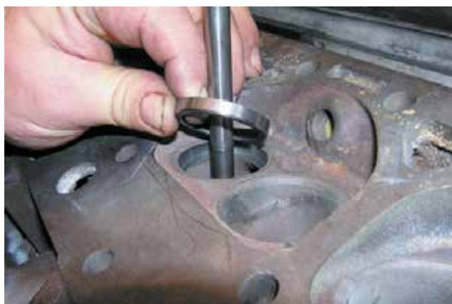
Фото 31-12: Поместите охлажденное седло клапана над обработанным углублением, убедившись в том, что фаска ремонтной вставки обращена к головке цилиндра, как это показано на снимке.
