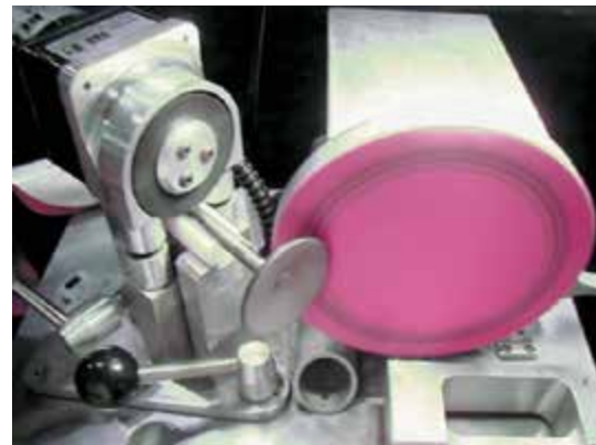
Рисунок 31-23: Восстановление рабочей фаски клапана шлифованием. И клапан, и шлифовальный круг вращаются, что необходимо для получения равномерной и гладкой поверхности на рабочей фаске клапана; источник: Pearson Education, Inc.
