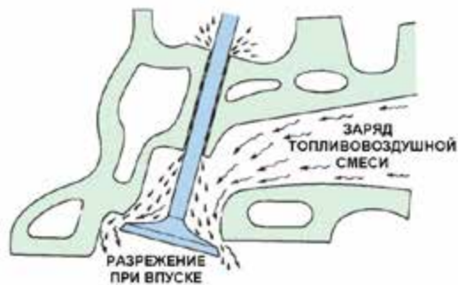
Рисунок 31-45: Разрежение в двигателе может втянуть масло через зазор между направляющей втулкой клапана и штоком клапана, и подать это масло в камеру сгорания. Использование уплотнений в клапанной системе ограничивает количество масла, которое всасывается в двигатель. Если уплотнения имеют дефекты, во время пуска двигателя чаще всего наблюдается чрезмерно синий (масляный) дым; источник: Pearson Education, Inc.
