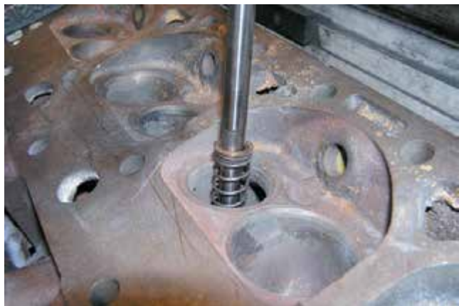
Фото 31-7: Установите направляющий стержень (пилот) в направляющую втулку клапана для поддержки режущей головки седла клапана.
