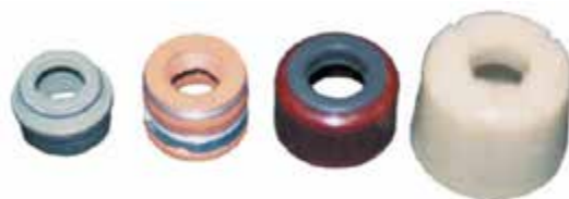
Рисунок 31-51: Ассортимент форм, цветов и материалов позитивных (принудительных) уплотнений штоков клапанов; источник: Pearson Education, Inc.
