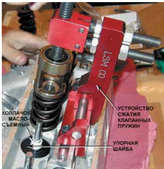
Рисунок 31-53: Сборка клапанного механизма гоночного двигателя с помощью сверхпрочного устройства сжатия клапанных пружин; источник Pearson Education, Inc.
