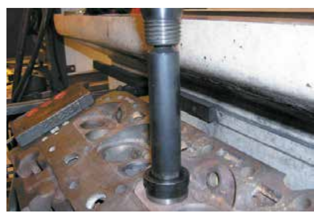
Фото 31-14: Используя пневматический молот или пресс, загоните седло клапана в подготовленное углубление.
