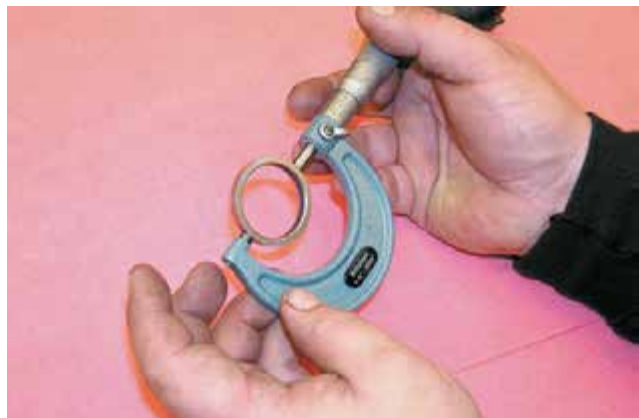
Фото 31-5: Тщательно измерьте наружный диаметр ремонтной вставки седла клапана.
