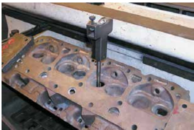
Фото 31-1: После замены и/или восстановления направляющей втулки клапана перед удалением изношенного/поврежденного седла клапана необходимо правильно позиционировать головку цилиндров. Для этого установите в направляющую втулку клапана направляющий стержень.
