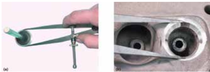
Рисунок 31-35: (а) Установите циркуль-измеритель на 1,5 мм (1/16 дюйма) меньше, чем диаметр рабочей фаски клапана. (б) Отшлифуйте верхнюю 15° кромку седла клапана, пока нижний край этой кромки не достигнет соответствия диаметру, установленному делительным циркулем.
