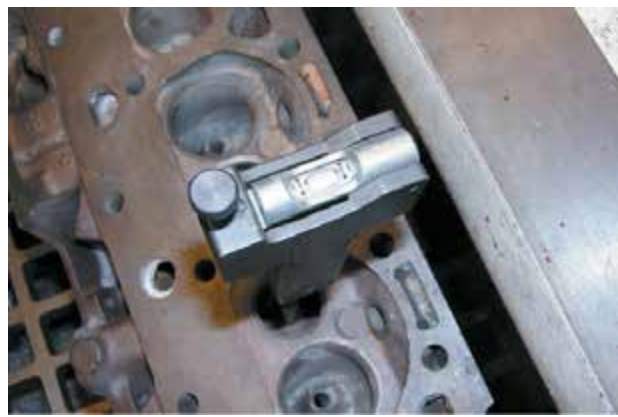
Фото 31-2: На направляющем стержне установите жидкостной уровень, и выставьте головку цилиндра так, чтобы воздушный пузырек занимал срединное положение, как при поперечном, так и при продольном позиционировании головки цилиндров.
