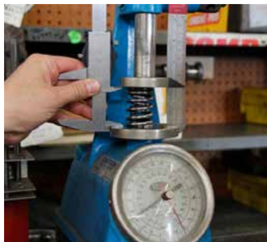
Рисунок 31-18: На снимке представлен один из наиболее популярных приборов проверки силы сжатия пружин. Спецификация обычно указывает: (1) свободную высоту пружины; (2) силу сжатия пружины в состоянии, соответствующем закрытию клапана; (3) силу сжатия пружины при максимальном ходе открытия клапана; источник: motortech.ru
