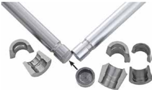
Рисунок 31-19: На внутренних поверхностях сухарных замков выполнены фасонные выступы, которые должны точно совпадать по форме с пазами на штоке клапана.
