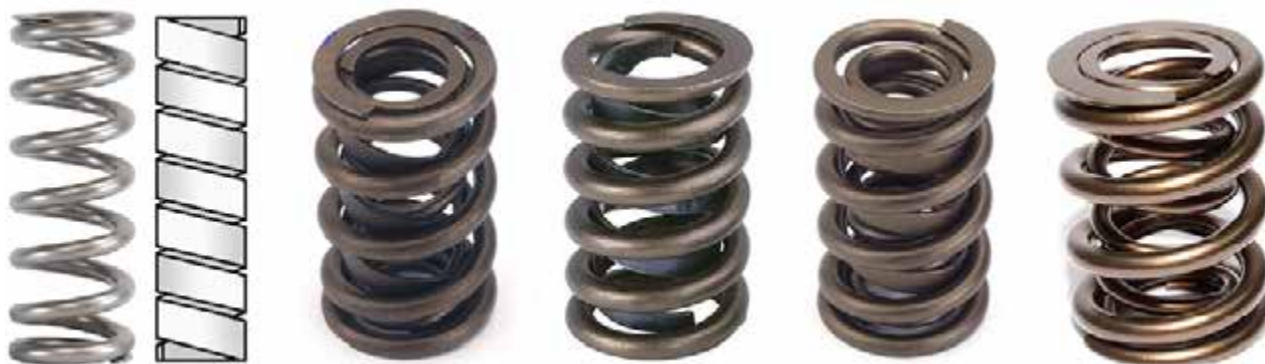
Рисунок 31-14: Типовые клапанные пружины: самый левый рисунок показывает конструкцию плоского спирального амортизатора, изображенного рядом со спиральной клапанной пружиной (обратите внимание на направление витков в пружине и амортизаторе); вторым слева изображена двойная клапанная пружина с установленным между ними узким спиральным амортизатором; средний рисунок демонстрирует одинарную клапанную пружину с установленным в ней плоским спиральным амортизатором; четвертый слева рисунок изображает двойную пружину с широким спиральным амортизатором; правый рисунок изображает двойную клапанную пружину без демпфера колебаний.
