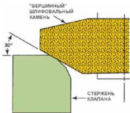
Рисунок 31-30: Абразивный камень с углом в 30^\circ снимает металл с верхней части седла клапана, формируя широкую входную воронку; источник: Pearson Education, Inc.
