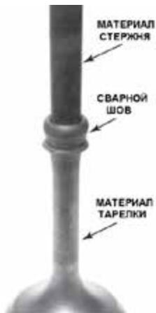
Рисунок 31-4: Сваренные инерционным трением детали клапана перед механической обработкой; источник: Pearson Education, Inc
