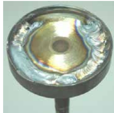
Рисунок 31-40: Удаление седла клапана путем приварки клапана меньшего диаметра к седлу; источник: mechanica.ru
