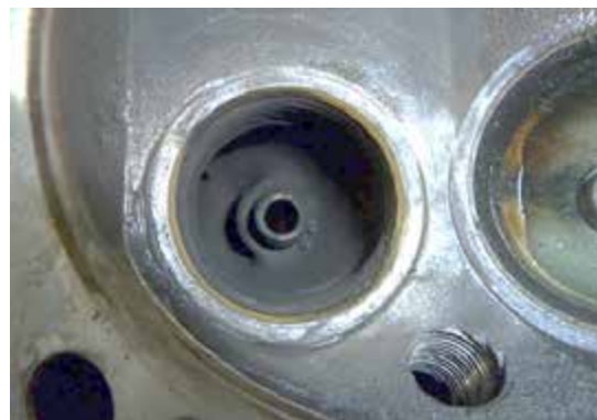
Рисунок 31-8: Типичный износ седла выпускного клапана. На снимке видно, что выпускной клапан не обеспечивал надлежащего прилегания к седлу; источник: kickstarter.org.
