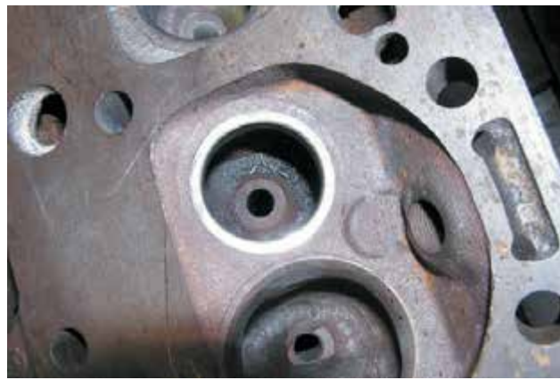
Фото 31-15: Теперь установленное седло клапана можно закернить, если это рекомендуется производителем, и приступить к механической обработке седла клапана.
