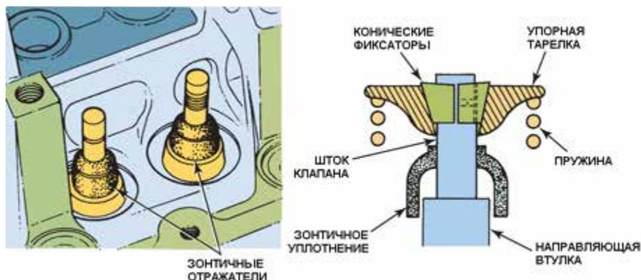
Рисунок 31-47: Зонтичное уплотнение крепится на штоке клапана таким образом, что его нижняя кромка прикрывает направляющую втулку клапана; источник: Pearson Education, Inc.
