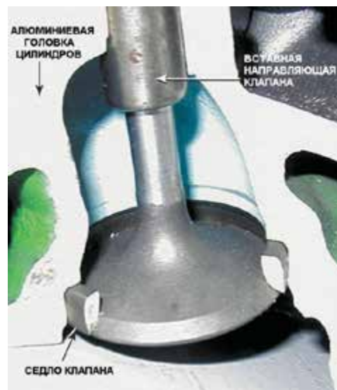
Рисунок 31-39: Все алюминиевые головки цилиндров используют вставные седла клапанов. Если несъемное седло клапана (в чугунной головке) сильно изношено, он может быть заменено специальной вставкой с предварительной механической обработкой углубления для нового вставного седла клапана; источник: Pearson Education, Inc.
