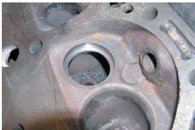
Фото 31-11: Финальная стадия обработки углубления под ремонтную вставку состоит в обязательном удалении всей образовавшейся стружки пылесосом.
