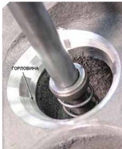
Рисунок 31-36: Дополнительной шлифовкой горловины (60° углом) можно исправить чрезмерную ширину ответной части (45°) уплотнительной фаски клапана. Шлифовальный камень обрабатывает ту часть седла клапана, которая на снимке показана стрелкой; источник: Cengage Learning
