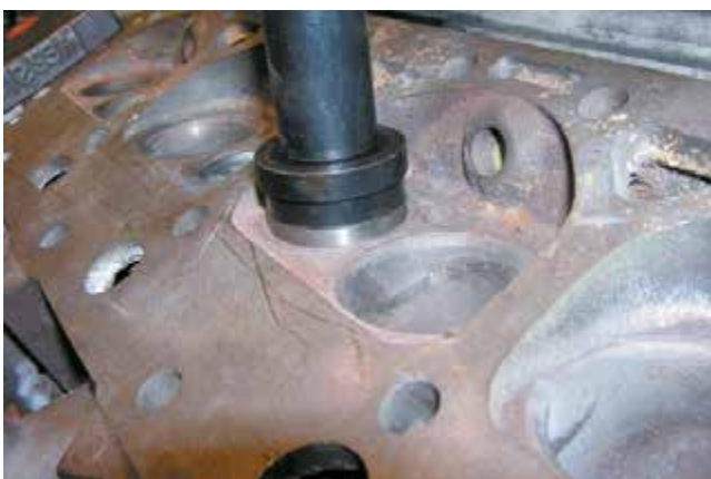
Фото 31-13: Установите седло клапана на корректный размер оправки.
