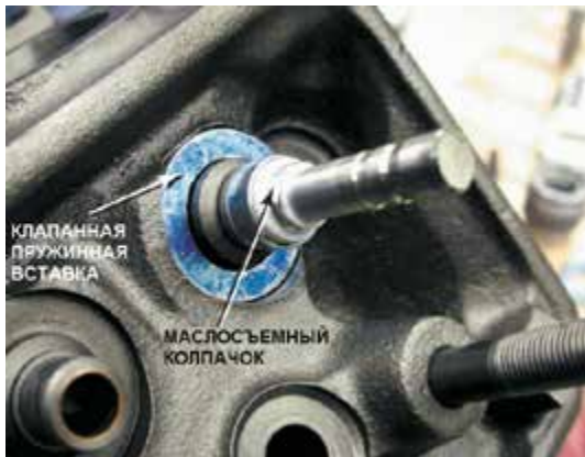
Рисунок 31-44: Клапанные пружинные вставки используются для восстановления предписанной высоты установки; источник: Pearson Education, Inc.
