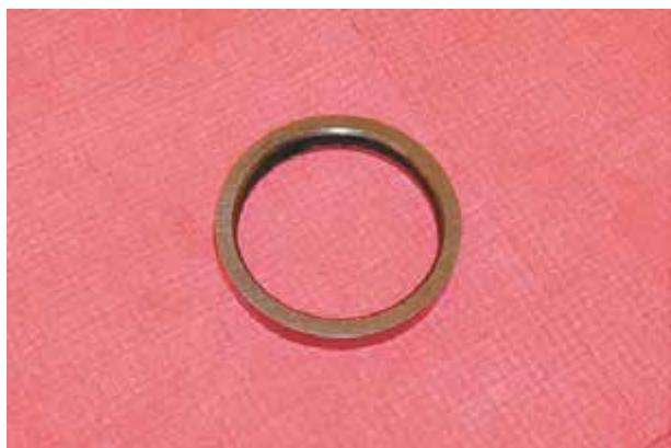
Фото 31-3: Выберите необходимую по размеру и материалу ремонтную вставку. Обязательно обратитесь к рекомендациям производителя ремонтной вставки для уточнения условий правильного выбора натяга.
