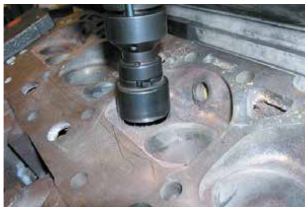
Фото 31-10: Не меняя позиционирования головки цилиндров, запустите режущий станок и удалите изношенное сиденье клапана вместе с частью материала головки цилиндров.
