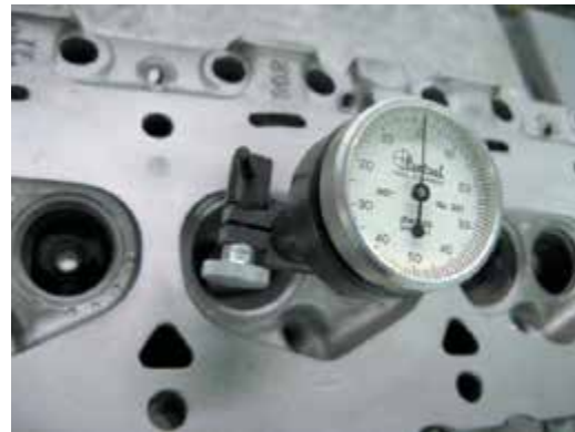
Рисунок 31-33: Проверка соосности седла и направляющей клапана с помощью индикатора часового типа; источник: Pearson Education, Inc.
