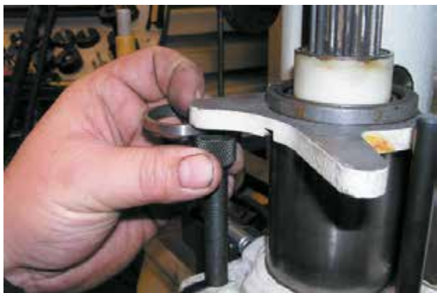
Фото 31-9: Отрегулируйте глубину резания, используя новое седло клапана, для этого выверните упорное приспособление на толщину сиденья.
