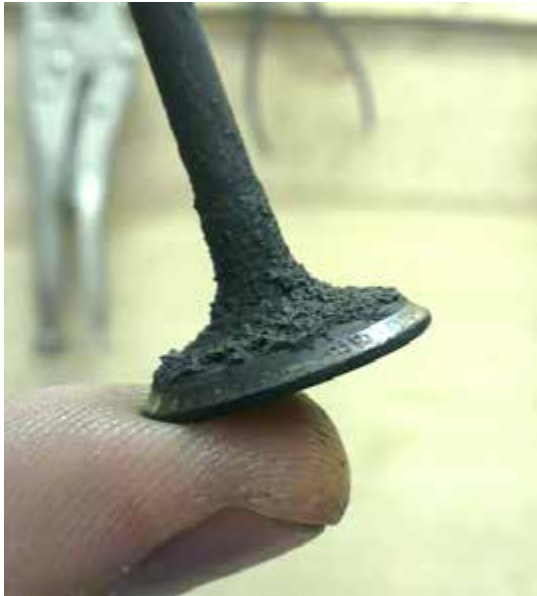
Рисунок 31-9: Нагар на впускном клапане образуется в результате поступления масла по штоку клапана, или некачественного распыления топлива инжектором; источник: Pearson Education, Inc.
