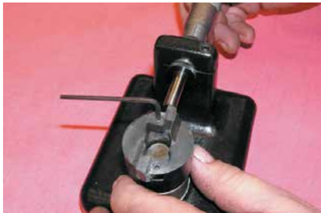
Рисунок 31-6: Отрегулируйте глубину установки каждого резца в соответствии с рекомендуемой спецификацией производителем размером для обработки посадочного углубления седла клапана.
