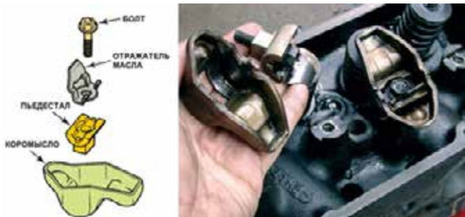
Рисунок 32-34: Конструкция коромысла, устанавливаемого на пьедестал, не обеспечивает возможности регулировки теплового зазора клапана. Если возникает необходимость в регулировках, необходимый тепловой зазор обеспечивается подбором штанг различной длины; источник: Ford-trucks.com
