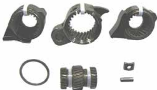
Рисунок 32-73: Два клапанных рычага и роликовый рычаг имеют противоположное направление угла наклона зубьев, что позволяет при продольном перемещении косозубого приводного элемента (в середине внизу) обеспечить движение клапанных рычагов относительно роликового рычага, подобно лезвиям ножниц, меняя угловое положение двух клапанных рычагов относительно роликового рычага; источник: Toyota
