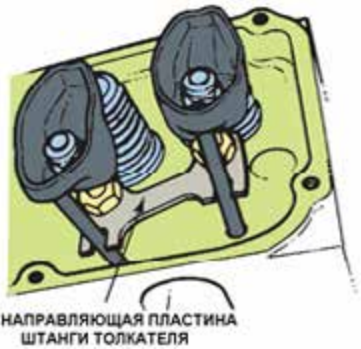
Рисунок 32-33: Прикрепленные к головке цилиндров направляющие пластины обеспечивают стабильность штангам толкателя, особенно на высоких оборотах двигателя; источник: Pearson Education, Inc.
