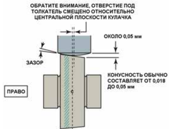
Рисунок 32-26: Небольшая конусность рабочей поверхности кулачка, и небольшая выпуклость дна толкателя, плюс смещение оси отверстия под толкатель относительно центральной плоскости сечения кулачка позволяют получить вращение толкателя и штанги толкателя при работе двигателя; источник: Pearson Education, Inc.
