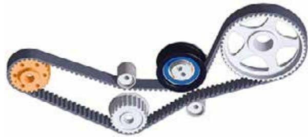
Рисунок 32-16: Схематическое изображение привода распределительного вала посредством ременной передачи с полукруглым профилем зубьев; источник: ООО «Резон»
