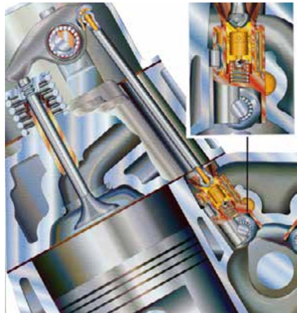
Рисунок 32-40: Гидравлический компенсатор встроен в толкатель привода клапанов в двигателе с верхним расположением клапана и распределительным валом в блоке цилиндров; источник: INA
