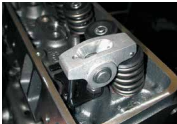
Рисунок 32-30: Высокопроизводительное алюминиевое роликовое коромысло. Как узел соприкосновения штанги толкателя с коромыслом, так и узел, контактирующий со штоком клапана, оснащены роликами, чтобы помочь уменьшить трение для получения большей мощности и улучшения топливной экономичности; источник: Pearson Education, Inc.
