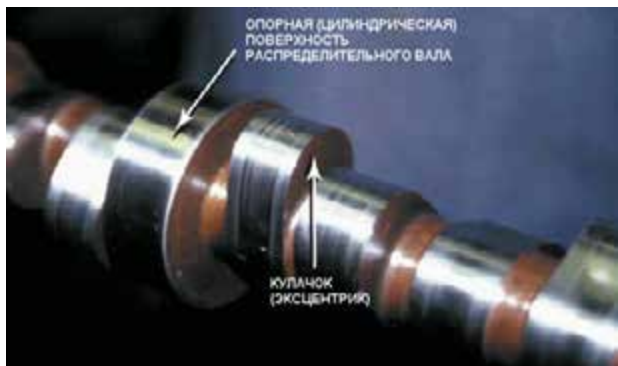
Рисунок 32-1: Этот высокопроизводительный распределительный вал имеет кулачок, который быстро открывает клапан и держит его открытым длительное время; источник: Pearson Education, Inc.
