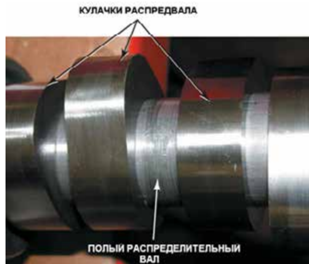
Рисунок 32-5: Композитный распределительный вал с одной стороны – легкий, с другой стороны – достаточно податливый, поскольку усилия, прилагаемые к кулачкам при открытии клапанов, достаточно велики; источник: Pearson Education, Inc.
