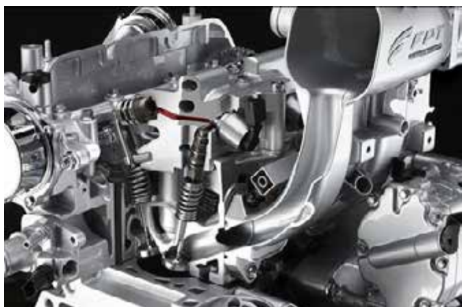
Рисунок 32-75: Двухцилиндровый 900 см 3 двигатель автомобиля FIAT 500 , мощностью 84 лошадиные силы оснащен системой гидравлического управления впускными клапанами; источник: FIAT
