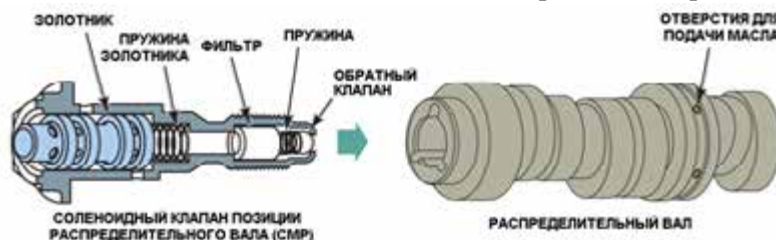
Рисунок 32-65: Золотниковый механизм электромагнитного клапана, используемого для регулирования фаз газораспределения поворотом распределительного вала, установленного в блоке цилиндров; источник: Pearson Education, Inc.
