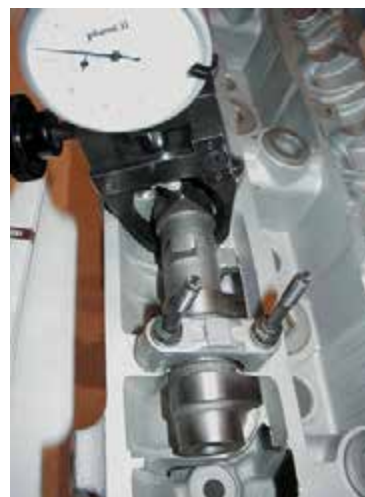
Рисунок 32-55: Циферблатный индикатор используется для измерения высоты кулачка; источник: Pearson Education, Inc.
