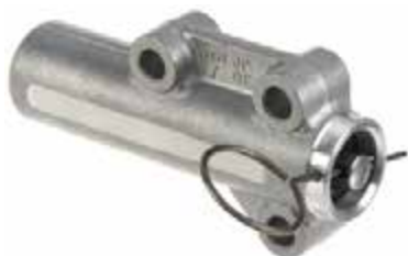
Рисунок 32-23: Устройство гидравлического натяжения ремня привода распределительного вала перед его установкой приведено в исходное состояние, и зафиксировано чекой, которую следует вынуть при завершении монтажа ремня ГРМ; источник: europaparts.com
