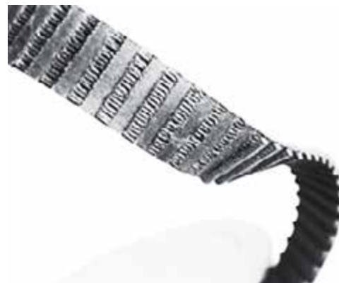
Рисунок 32-17: Этот ремень перестал передавать вращение на распределительный вал, поскольку при пробеге в 140000 км. Владелец не смог (или не захотел) произвести замену при рекомендуемом 100000 километровом пробеге, и заплатил сломанной головкой цилиндров; источник: diaginfo.ru
