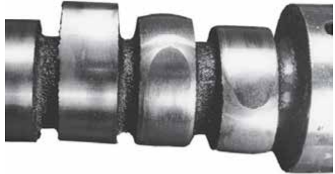
Рисунок 32-6: Изношенный распределительный вал с двумя кулачками, изношенными до такой степени, что стали практически круглыми; источник: Pearson Education, Inc.
