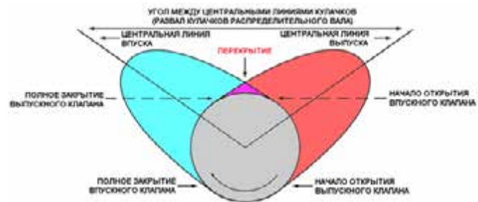
Рисунок 32-43: Если угол между центральными линиями кулачков уменьшить, не меняя профиль кулачков, то увеличится длительность перекрытия клапанов; источник: Pearson Education, Inc.
