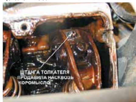
Рисунок 32-52: Причина перебоев воспламенения в одном из цилиндров 3,1-литрового V-образного двигателя GM была выявлена после вскрытия крышки и обнаружения, что толкатель продавил насквозь коромысло; источник: Pearson Education, Inc.
