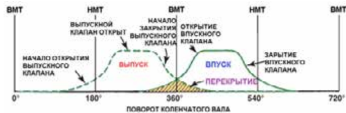
Рисунок 32-42: Графическое представление типичного распределительного вала, показывающее соотношения длительности открытия впускного и выпускного клапана. Затрихованная область показывает длительность периода перекрытия клапанов в 100°; источник: Pearson Education, Inc.
