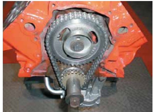
Рисунок 32-14: Замена высокопроизводительной двойной роликовой цепи. Хотя эта цепь немного шумнее, чем бесшумная (сайлент) цепь, втулочно-роликовые цепи растягиваются значительно меньше, и, следовательно, имеется возможность осуществлять более точное управление фазами газораспределения долгое время; источник: Pearson Education, Inc.
