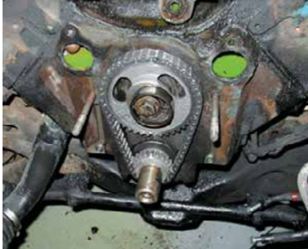
Рисунок 32-12: Замена бесшумной (сайлент) цепи и зубчатого колеса. Оригинальное зубчатое колесо было с алюминиевой ступицей и нейлоновыми зубьями, которые позволяли снизить шум работы. Замена цепи и зубчатых колес не должна вызвать беспокойство по поводу появившегося шума, и должна обеспечить многие тысячи километров до следующей замены; источник: Pearson Education, Inc.
