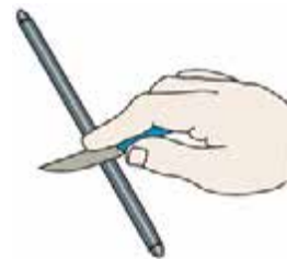
Рисунок 32-37: Во всех двигателях должны использоваться только закаленные штанги толкателей. Для того, чтобы определить, закален ли материал штанги, достаточно попробовать поцарапать штангу острым ножом; источник: Pearson Education, Inc.
