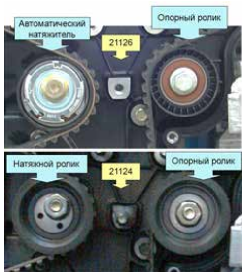
Рисунок 32-21: Применение автоматического и ручного натяжителя на двигателях автомобилей семейства ВАЗ 2112.
