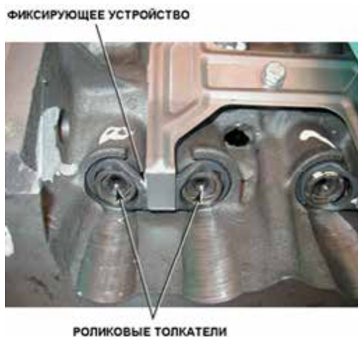
Рисунок 32-50: Все роликовые толкатели должны оснащаться фиксирующими, или направляющими устройствами, которые не позволяют толкателю повернуться вокруг его продольной оси; источник: Pearson Education, Inc.
