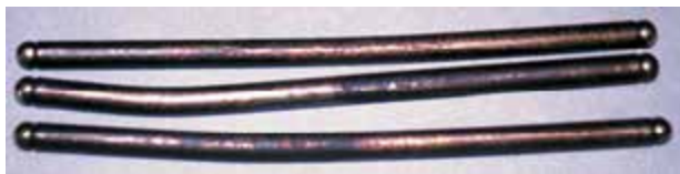
Рисунок 32-36: На снимке показаны штанги, которые были погнуты в результате разрыва цепи привода распределительного вала. Клапаны перестали двигаться, а поршни продолжали возвратно-поступательное движение, что привело к соударению тарелок клапанов с днищем поршня; источник: Pearson Education, Inc.
