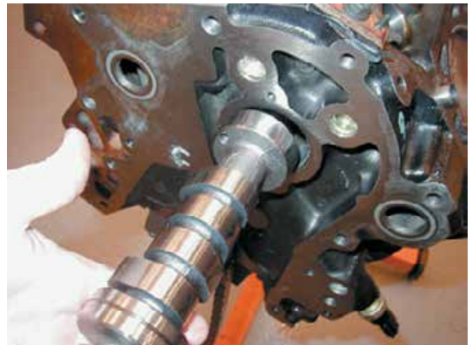
Рисунок 32-3: У типового двигателя с расположением распределительного вала в блоке цилиндров распределительный вал вращается в подшипниках, установленных в тоннеле блока цилиндров; источник: Pearson Education, Inc.
