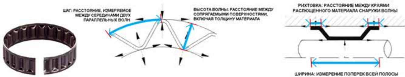
Рисунок 32-10: Кольцо толерантности устанавливается между неподвижным корпусом и подвижным валом, обеспечивая защиту от перегрузок путем её распределения по всей поверхности расточенного отверстия; источник: Rencol
