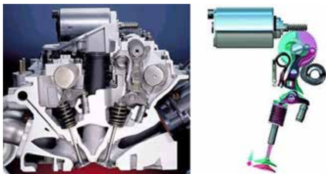
Рисунок 32-68: Система плавного регулирования высоты подъема клапана, примененная BMW , получила название Valvetronic ; источник: BMW
