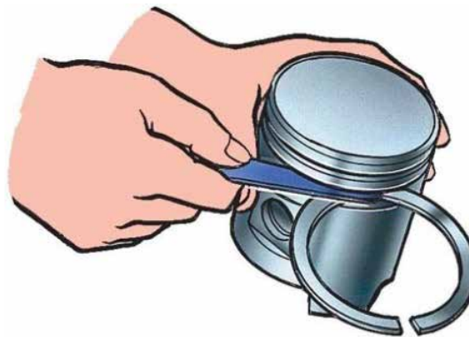
Рисунок 33-НН16: Измерение бокового зазора между кольцом и стороной кольцевой канавки щупом -толщиномером; источник: Manual-Car.info .
