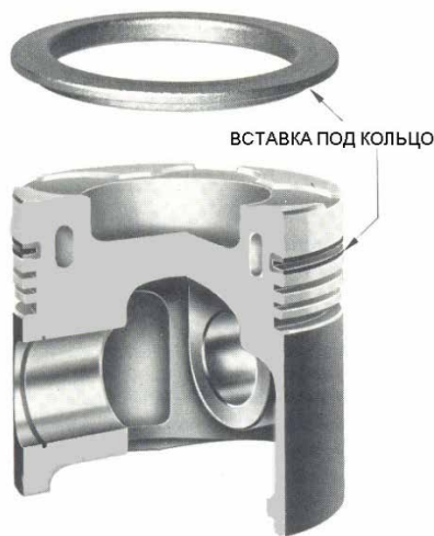
Рисунок 33-НН5: Вставка для поршневого кольца в поршне дизельного двигателя; источник: Westermann
