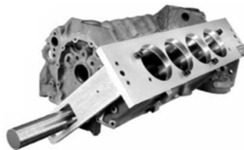
Рисунок 34-28: На снимке показан комплект, предназначенный для установки на V-8 или V-6 блок двигателя, который целесообразно использовать при растачивании как портативным инструментом, прикрепляемым к верхней палубе комплекта, так и при растачивании на крупногабаритных расточных станках. Боковые направляющие и оправка, устанавливаемая в седла коренных подшипников, гарантирует выравнивание цилиндров относительно оси вращения коленчатого вала; источник: ВНУ
