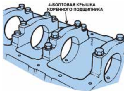
Рисунок 34-15: Высокопроизводительные двигатели и двигатели грузовых автомобилей часто используют 4-болтовое крепление крышек коренных подшипников для придания необходимой прочности крепления коленчатого вала. На некоторых двигателях резьбовые отверстия для двух дополнительных болтов сделаны под углом относительно двух основных отверстий крепления крышек коренных подшипников; источник: Pearson Education, Inc.
