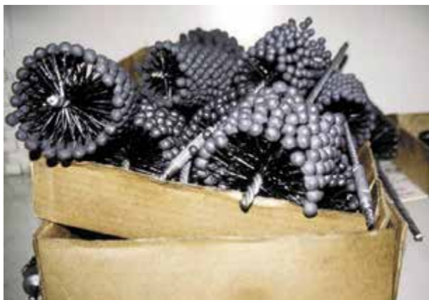
Рисунок 34-31: Ассортимент матирующих хонеров шарикового типа. Этот тип хона не способен исправить волнистость стенок цилиндра; источник: Pearson Education, Inc.
