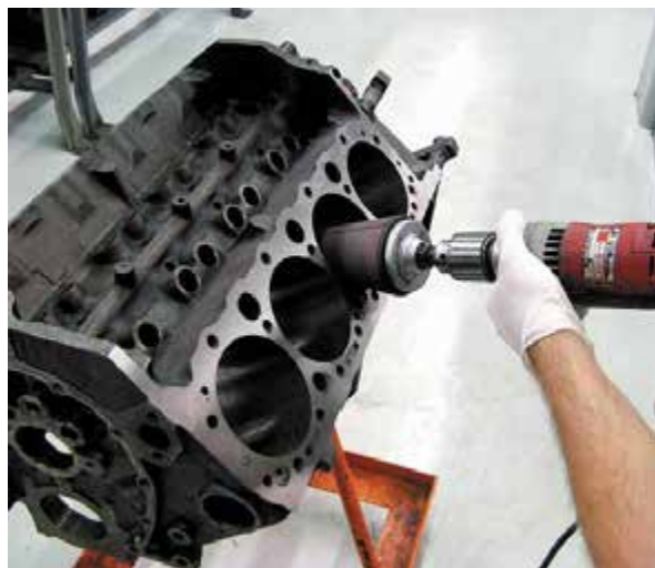
Рисунок 32-37: Если блок цилиндров подвергался механической обработке, используйте резиновый конус, покрытый слоем шлифовальной ткани, для удаления острых краев цилиндра; источник: Pearson Education, Inc.
