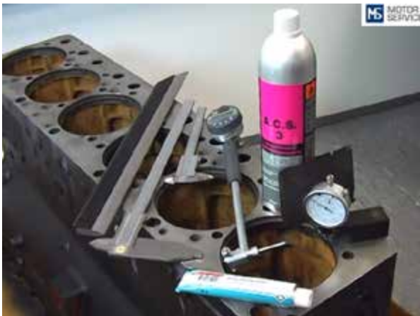
Фото 34-1: Для проверки и монтажа «мокрой» гильзы цилиндра потребуются; нутромер; циферблатный индикатор с держателем; штангенциркуль; лекальная линейка; пригоночная краска; средство для очистки (можно использовать средство для тормозных механизмов) и мелкозернистая наждачная бумага.
