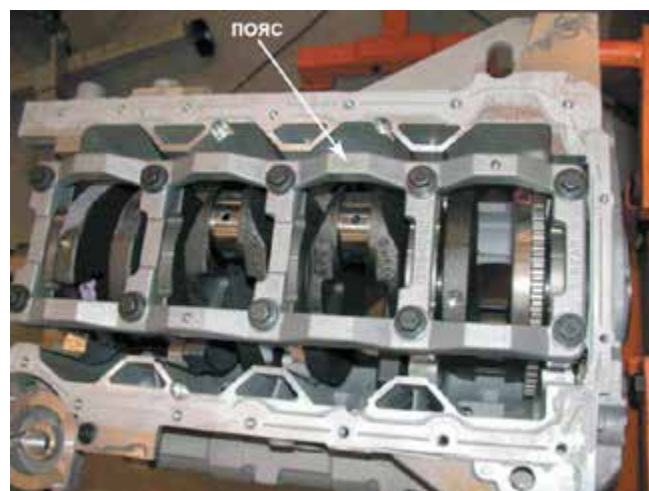
Рисунок 34-18: Пояс, или обойма, используется для того, чтобы соединить все крышки коренных подшипников вместе, и придать дополнительную жесткость нижней части блока цилиндров; источник: Pearson Education, Inc.
