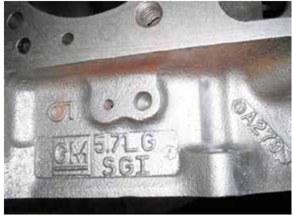
Рисунок 34-8: Литой номер необходим для идентификации блока цилиндров; источник: Pearson Education, Inc.
