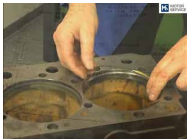
Фото 34-14. Укладываем дополнительную шайбу из комплекта на опорный буртик и вставляем гильзу цилиндра (никаких смазок не применять!).
