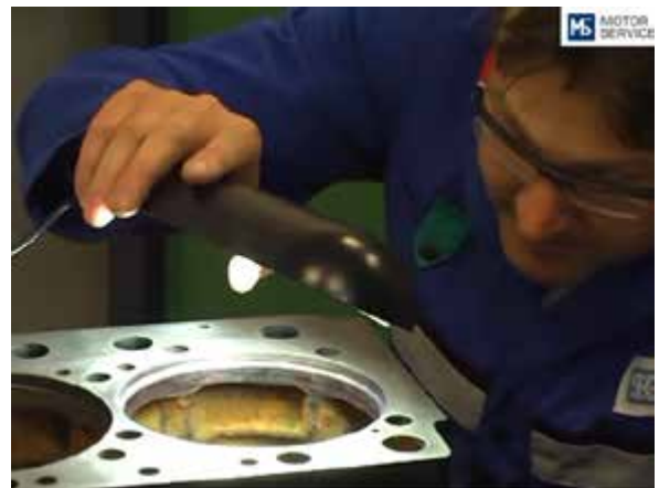
Фото 34-2: Перед монтажом гильзы цилиндра следует внимательно осмотреть все поверхности на наличие коррозии и повреждений. Эти недостатки могут оказать существенное влияние на качество работы двигателя.
