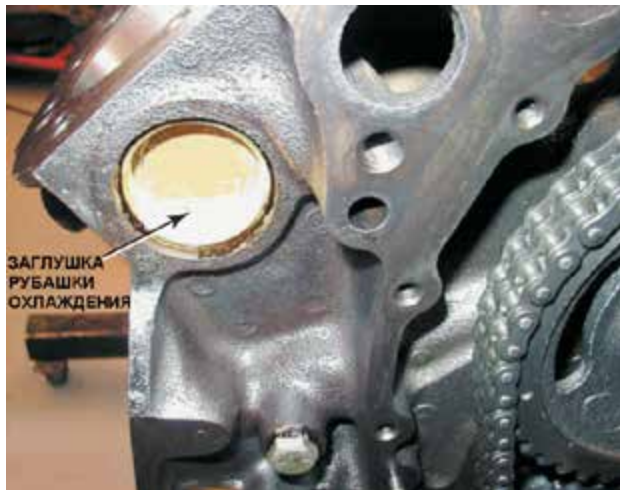
Рисунок 34-3: Расширяемая заглушка используется для закрытия технологического отверстия в блоке цилиндров или головке блока после завершения механической обработки и окончательной очистки внутренних полостей от остатков стержней и металлической стружки; источник: Pearson Education, Inc.
