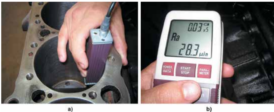
Рисунок 34-36: (а) Инструментальная оценка качества финишной отделки поверхности цилиндра. (б) Показания прибора указывают, что шероховатость поверхности Ra = 28,3 \mu\text{in} (микродюйма = миллионных долей дюйма) = 0,0000283 дюйма = 0,00071882 миллиметра указывает, что для использования молибденовых колец стенки цилиндра нуждаются в дополнительной, более тщательной доводке; источник: Pearson Education, Inc.
