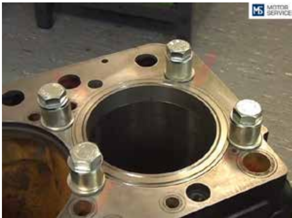
Фото 34-15: Осаживаем гильзу на место с помощью набора болтов, шайб и втулок.
