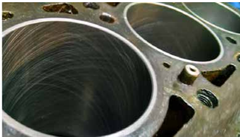
Рисунок 34-34: Штриховка перекрестными штрихами стенок цилиндров позволяет удерживать масляную пленку на стенках цилиндра, необходимую для смазки поршневых колец, в то же время подобная штриховка остается газонепроницаемой.
