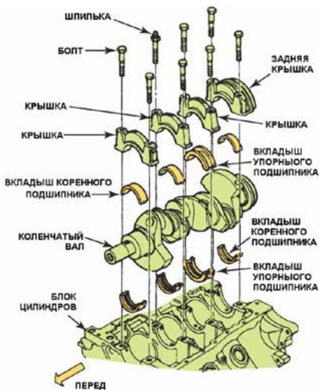
Рисунок 34-14: Крепление крышки коренных подшипников двумя болтами обеспечивают необходимую прочность и надежность удержания коленчатого вала внутри двигателя; источник: Pearson Education, Inc.
