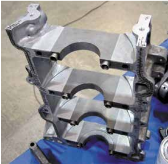
Рисунок 34-7: Опорная плита – это структурный элемент, который устанавливается между блоком цилиндров и масляным поддоном, и содержит опорные элементы крепления коленчатого вала двигателя; источник: Pearson Education, Inc.
