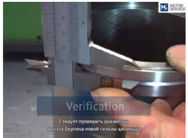
Фото 34-12: С помощью штангенциркуля измеряют внутренний и наружный диаметр, и толщину и буртика гильзы цилиндра.
