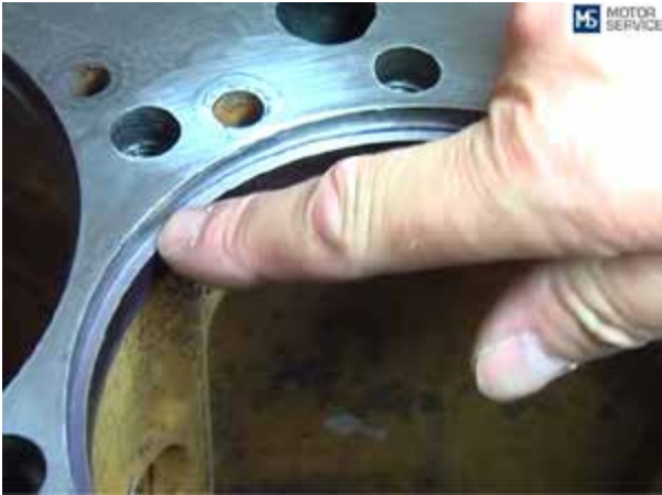
Фото 34-5: Особое внимание следует уделить состоянию опорной поверхности гильзы цилиндра
