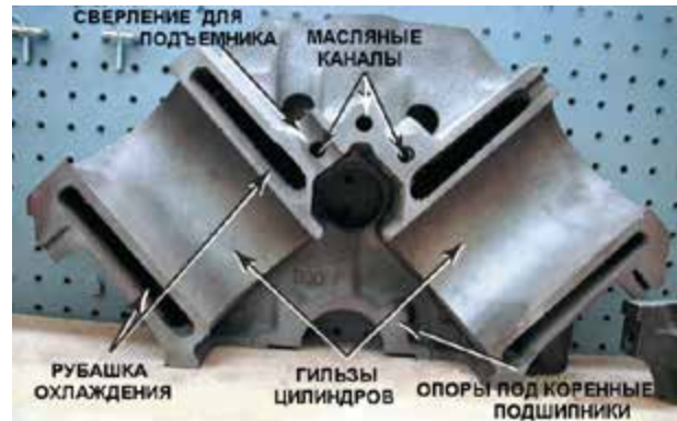
Рисунок 34-11: Учебно-разрезной макет блока цилиндров 8-цилиндрового V-образного двигателя Chevrolet демонстрирует рубашку охлаждения и масляные каналы в блоке цилиндров двигателя; источник: Pearson Education, Inc.
