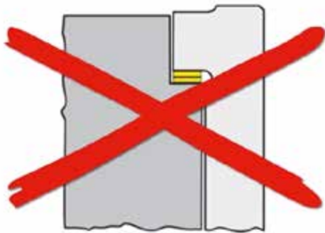
Фото 34-17: Сравниваем результаты измерений с данными производителя. ВНИМАНИЕ! Слишком малый размер выступания нельзя компенсировать за счет установки второй шайбы. Если размер выступания мал, следует использовать гильзу ремонтного размера с более высоким буртиком.
