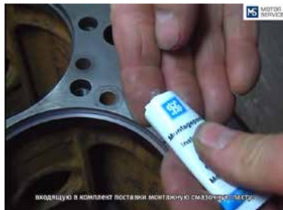
Фото 34-20: Используем для смазки колец и части гильзы, входящей в контакт с уплотнительными кольцами специально поставляемую монтажную пасту.
