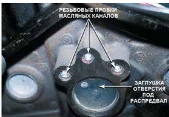
Рисунок 34-12: Типичные резьбовые пробки масляных каналов на V-образном 8-цилиндровом двигателе Chevrolet; источник: Pearson Education, Inc.
