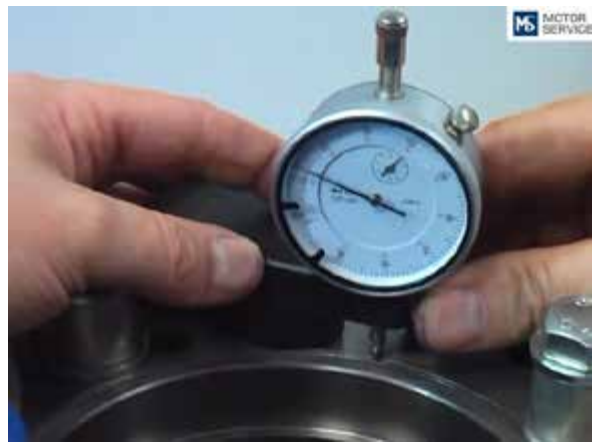
Фото 34-16: С помощью циферблатного индикатора определяем выступание гильзы над палубой блока цилиндра. Измерения производятся в четырех местах под углом 90° относительно друг друга.
