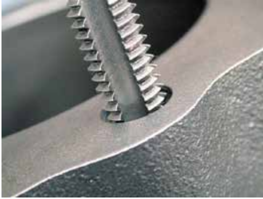
Рисунок 34-40: Перед сборкой двигателя следует «пройти» резьбовые отверстия метчиками, и очистить отверстия от стружки, грязи и влаги; источник: Pearson Education, Inc.
