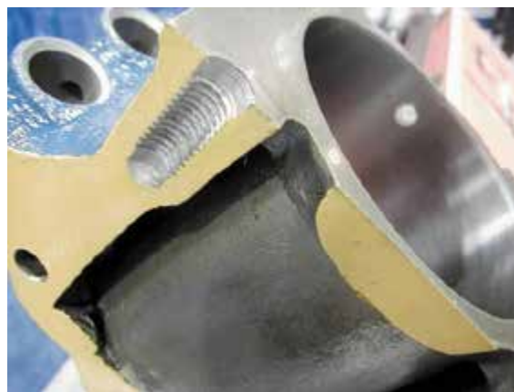
Рисунок 34-39: Обратите внимание на этот блок цилиндра в разрезе, где хорошо видно, что глухие резьбовые отверстия могут быть неглубоки. Опилки и грязь может скопиться на дне глухих отверстий, и все резьбовые отверстия должны быть очищены перед сборкой двигателя; источник: Pearson Education, Inc.
