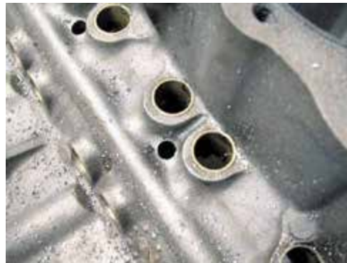
Рисунок 34-38: Производители высоко-мощных двигателей часто в отверстия толкателей устанавливают бронзовые втулки; источник: Pearson Education, Inc.
