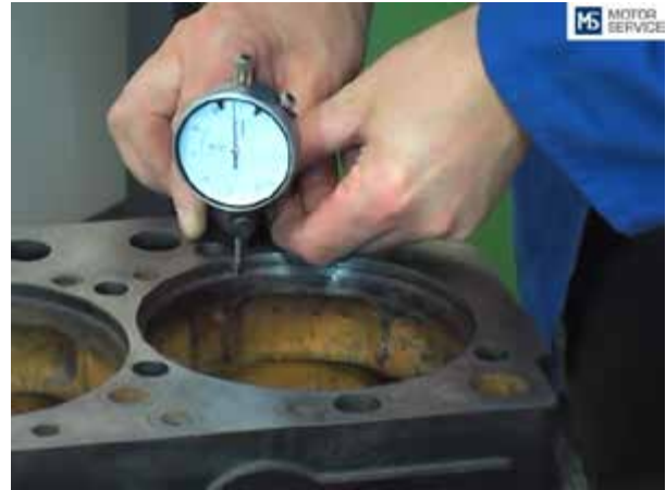
Фото 34-6: С помощью циферблатного индикатора проверьте глубину опорной поверхности и её параллельность палубе блока цилиндров
