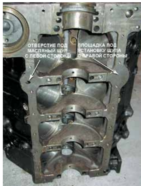
Рисунок 34-13: «Переходный» блок цилиндров V-8 Chevrolet. Отверстие под масляный щуп выполнено с левой стороны, но имеется возможность установки щупа и с правой стороны; источник: Pearson Education, Inc.
