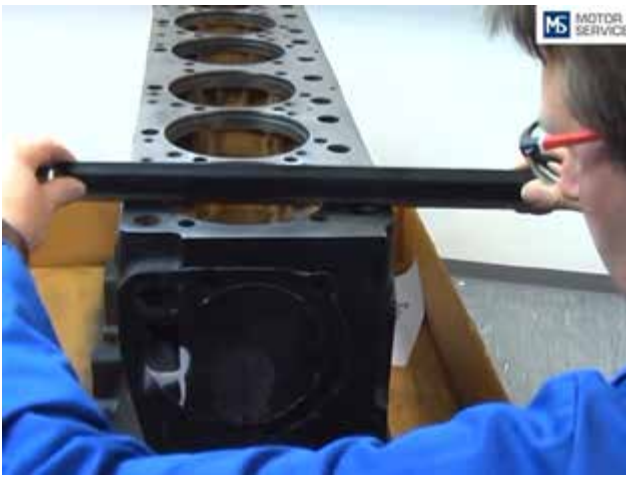
Фото 34-3: Производим проверку «палубы» блока цилиндров с помощью лекальной линейки, соблюдая рекомендации изготовителя транспортного средства.
