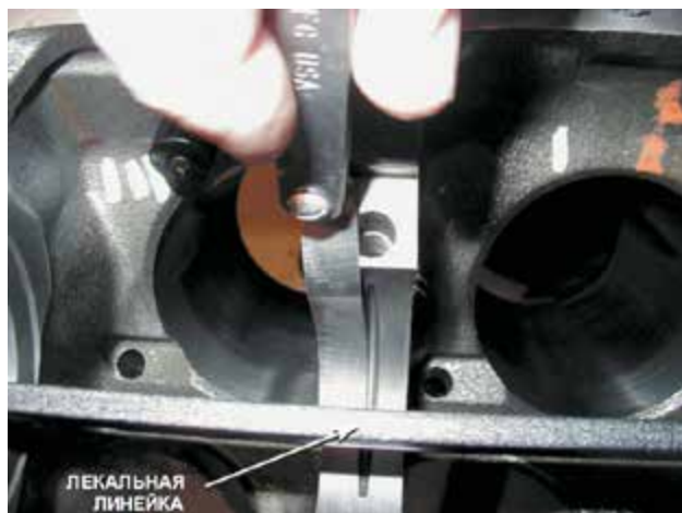
Рисунок 34-21: Соосность седел коренных подшипников можно проверить с помощью лекальной линейки и набора плоских щупов; источник: Pearson Education, Inc.
