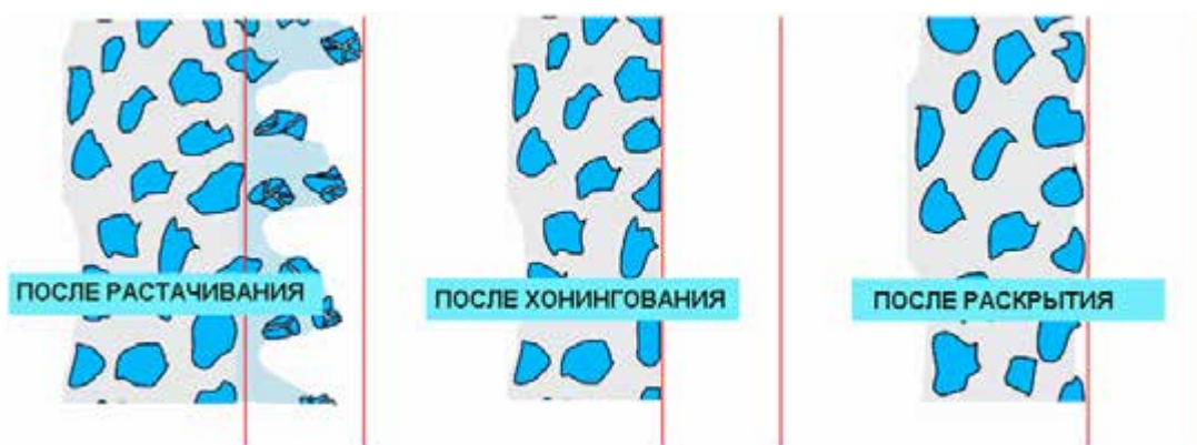
Рисунок 34pro-55: Схематическое изображение технологических операций обработки алюминиево-кремниевых поверхностей стенок цилиндров; источник: MSI
