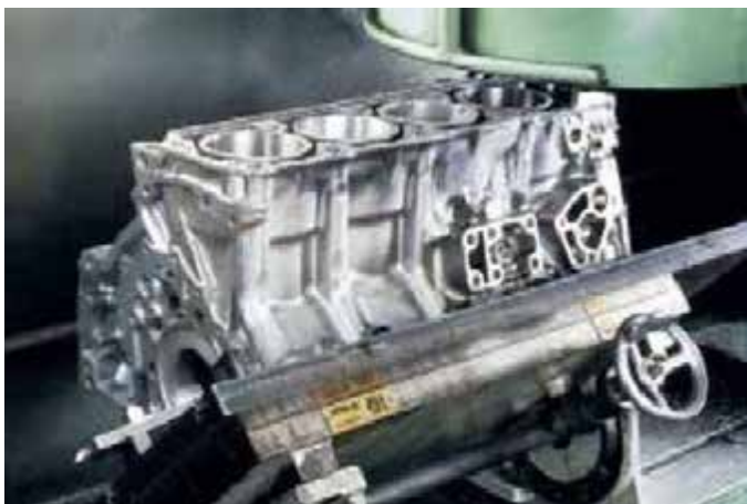
Рисунок 34pro-53: Торцевание верхней палубы блока цилиндров после установки втулок в рассверленные цилиндры; источник: MSI
