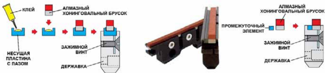
Рисунок 34pro-70: Крепление брусков в держателе производится с помощью клея или с помощью зажимных устройств; источник: MSI
