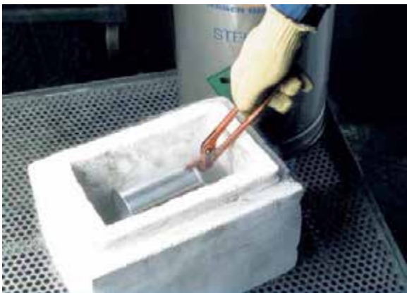
Рисунок 34pro-50: Жидкий азот позволяет снизить температуру втулки до -180^{\circ}\text{C} ... -200^{\circ}\text{C} ; источник: MSI
