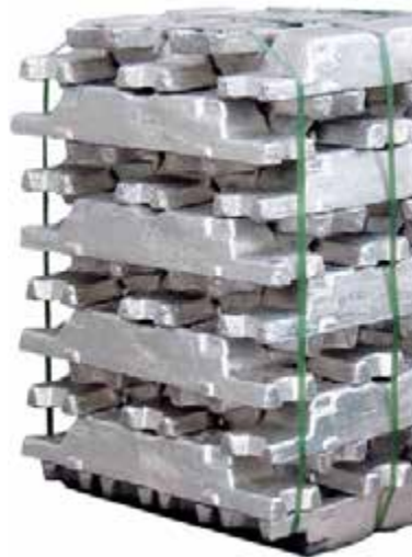
Рисунок 34pro-02: Сырьем для изготовления блоков цилиндров, как правило, является алюминиевый сплав, хорошо известный под наименованием «Силумин»; источник: MSI
