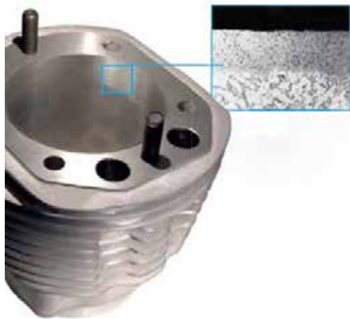
Рисунок 34pro-30: Рёберный цилиндр мотоциклетного двигателя, стенки которого покрыты тончайшим слоем никеля; источник: MSI
