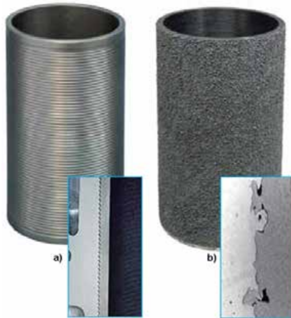
Рисунок 34pro-34: Заливаемые в алюминиевый блок цилиндров чугунные втулки гильз цилиндров; источник: MSI
