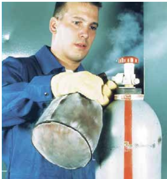
Рисунок 34pro-49: Применение сухого льда при расширении сжатого углекислого газа \text{CO}_2 позволяет снизить температуру гильзы перед её «горячей» запрессовкой до температуры -80^{\circ}\text{C} ; источник: MCI
