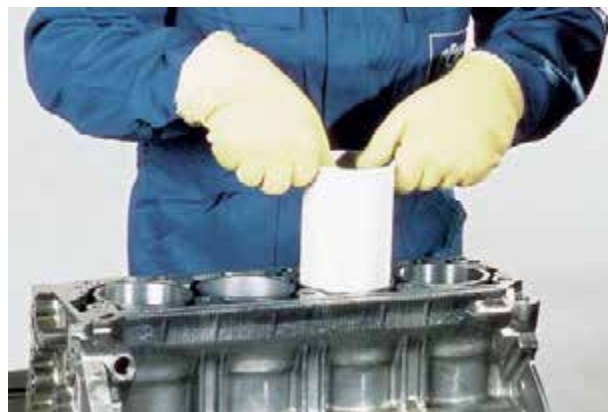
Рисунок 34pro-52: Установка охлажденной гильзы цилиндра в подогретый блок; источник: MSI
