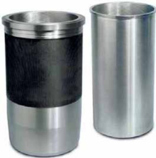
Рисунок 34pro-41: Slip-fit гильза слева и Press-fit гильза справа. Slip-fit гильзу можно монтировать от руки, в то время как Press-fit гильзу только с помощью пресса; источник: MSI
