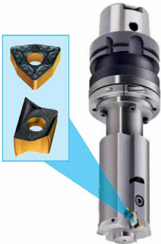
Рисунок 34pro-56: Обрабатывающая головка для растачивания цилиндра может быть оснащена сменными металлокерамическими лезвиями, которые крепятся в регулируемых державках. При обработке кремний-алюминиевых поверхностей цилиндров используется резцы с тонким слоем поликристаллических алмазов; источник: Walter AG
