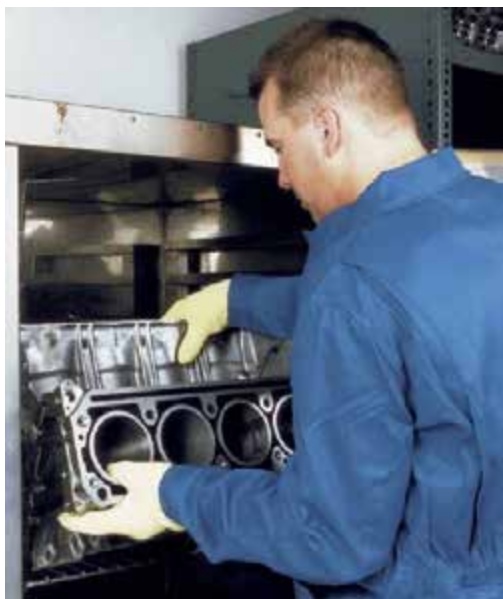
Рисунок 34pro-51: В печи блок цилиндров перед установкой втулок нагревают до 120^{\circ}\text{C} ... 140^{\circ}\text{C} , и выдерживают в ней 20...30 минут; источник: MSI
