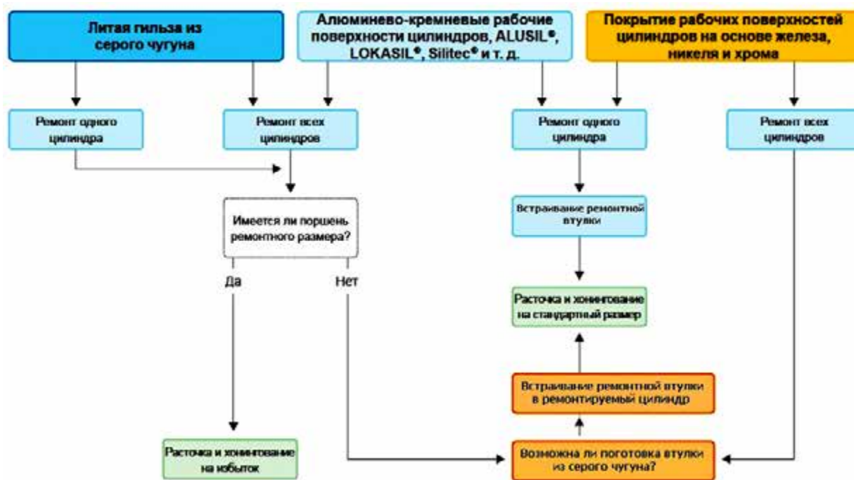
Рисунок 34pro-40: Обзор возможностей ремонта рабочей поверхности цилиндра; источник: MSI
