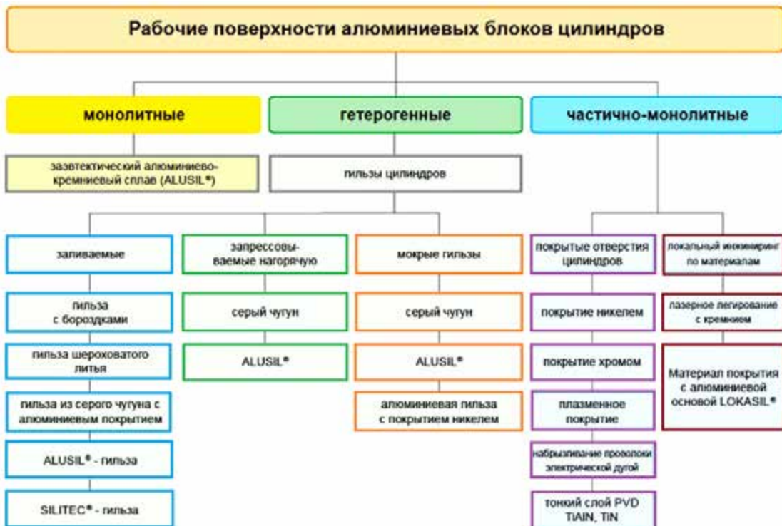
Рисунок 34pro-24: Технологии рабочих поверхностей алюминиевых блоков цилиндров; источник: MSI
