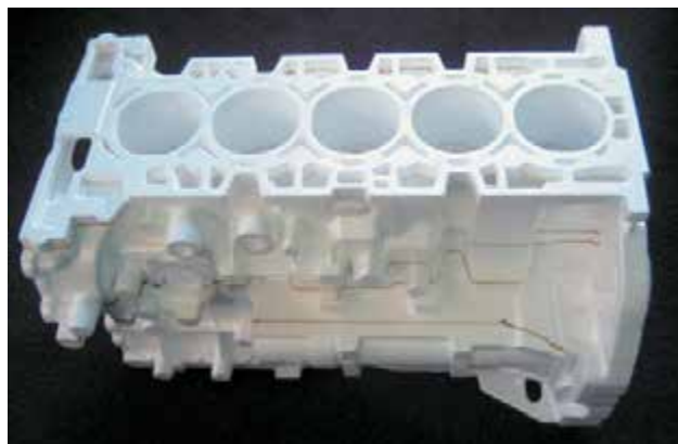
Рисунок 34pro-07: Одноразовая пенопластовая модель, склеенная из отдельных частей (видны следы клея в месте стыка). Внутри одноразовой модели установлены песчано-клеевые стержневые формы; источник: MSI
