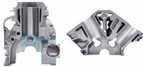
Рисунок 34pro-23: Вентиляционные отверстия в нижней части цилиндра позволяют организовать перетекание газов и масляного тумана от одного цилиндра к другому, не оказывая существенного сопротивления движениям поршней; источник: MSI
