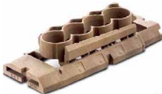
Рисунок 34pro-09: Конструирование и изготовление песчано-клеевых стержней позволяет изготовить блок цилиндров со сложными внутренними полостями; источник: MSI
