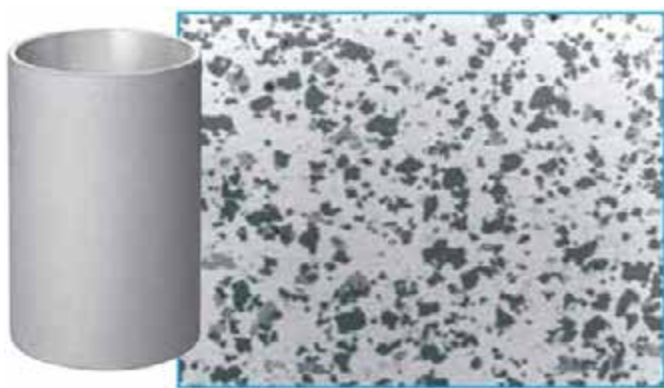
Рисунок 34pro-36: Структура набрызгиваемого расплава на металлическую заготовку показывает равномерное распределение кристаллов кремния в алюминиевой основе; источник: MSI
