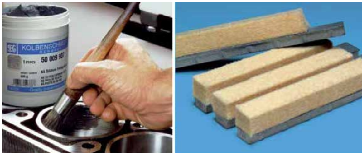
Рисунок 34pro-67: Притирочная паста, впитавшаяся в войлочные бруски, удаляет алюминий, обнажая кремниевые кристаллы; источник: MSI
