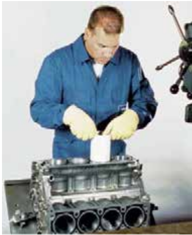
Рисунок 34pro-42: Установка сухой гильзы в алюминиевый блок может производиться только после её охлаждения: источник: MSI
