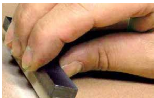
Рисунок: 34pro-74 Перед первым применением кромки брусков следует надломать или снять наждачной бумагой; источник: MSI
