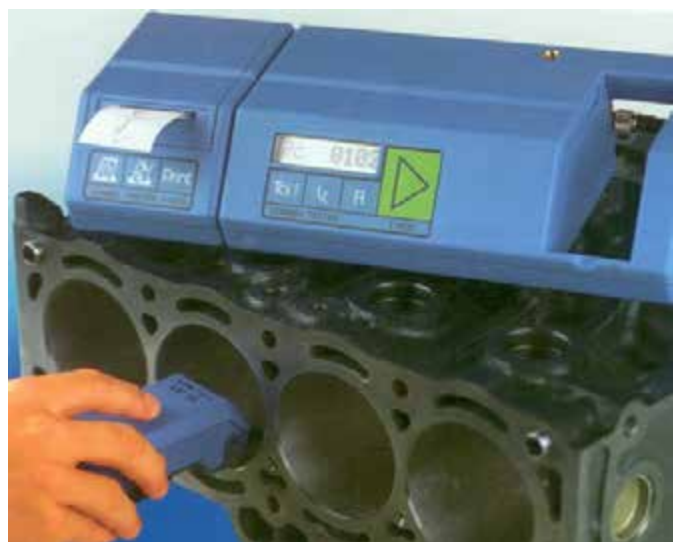
Рисунок 34pro-39: Прибор для определения шероховатости поверхности цилиндра быстро и точно определяет качество обработки поверхности. Обратите внимание, что шероховатость рабочей поверхности цилиндра двигателя, подлежащего ремонту, производится в той области, которой не касаются ни поршневые кольца, ни юбка поршня; источник: MSI
