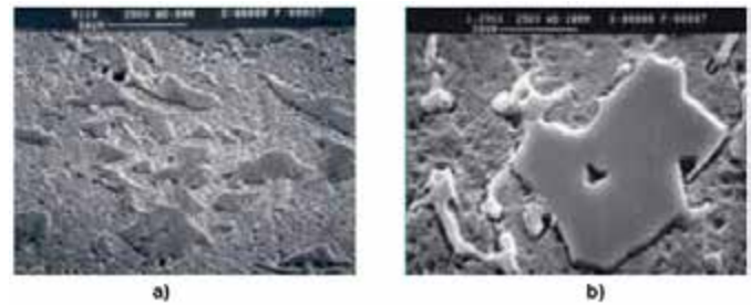
Рисунок 34pro-66: Раскрытая травлением рабочая поверхность цилиндра; источник: MSI
