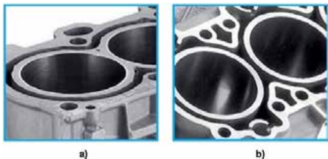
Рисунок 34pro-48: (a) В блоке цилиндров с совместно-отлитыми цилиндрами при запрессовке возможен перекося гильз цилиндров; (b) Цилиндры, выполненные отдельно меньше подвержены деформации при запрессовке втулок гильз цилиндров; источник: MSI
