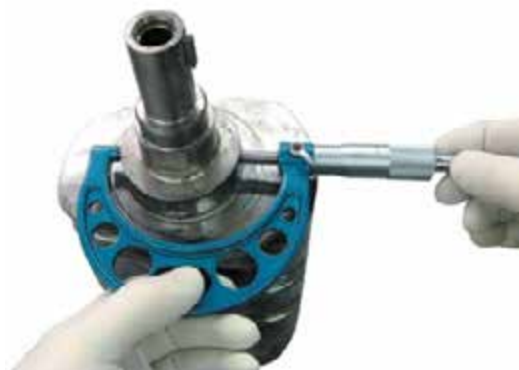
Рисунок 35-26: Все шейки коленчатого вала проверяются на соответствие диаметра, овальность и конусность; источник: Pearson Education, Inc.
