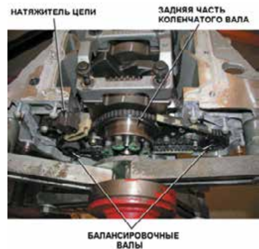
Рисунок 35-23: Четырехцилиндровый двигатель General Motors использует два балансировочных вала, приводимых в действие посредством цепной передачи, расположенной в задней части коленчатого вала; источник: Pearson Education, Inc.
