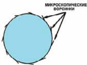
Рисунок 35-29: Схематическое отображение образования микроскопического ворса, образовавшегося на поверхности шейки при шлифовании или полировании; источник: TB2052 DANA
