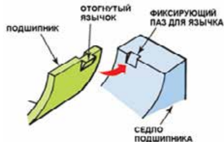
Рисунок 35-46: Отогнутый язычок вкладыша следует поместить в фиксирующий паз, выполненный в седле подшипника; источник: Pearson Education, Inc.
