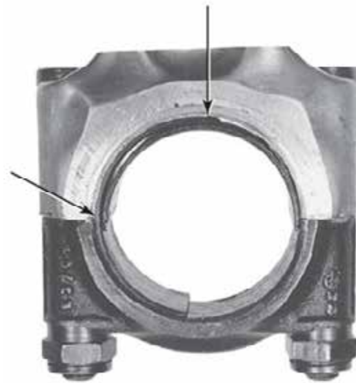
Рисунок 35-45: Проворачивание вкладыша. Нижний вкладыш подшипника затянуло под верхний вкладыш, при этом седло подшипника было серьезно повреждено; источник: Pearson Education, Inc.
