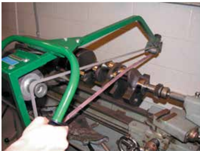
Рисунок 35-31: Направление полировочной ленты в точке соприкосновения с шейкой коленчатого вала должно обеспечивать разглаживание поверхности так, чтобы микро-ворсинки легли в направлении, противоположном нормальному вращению коленчатого вала; источник: TB2052 DANA
