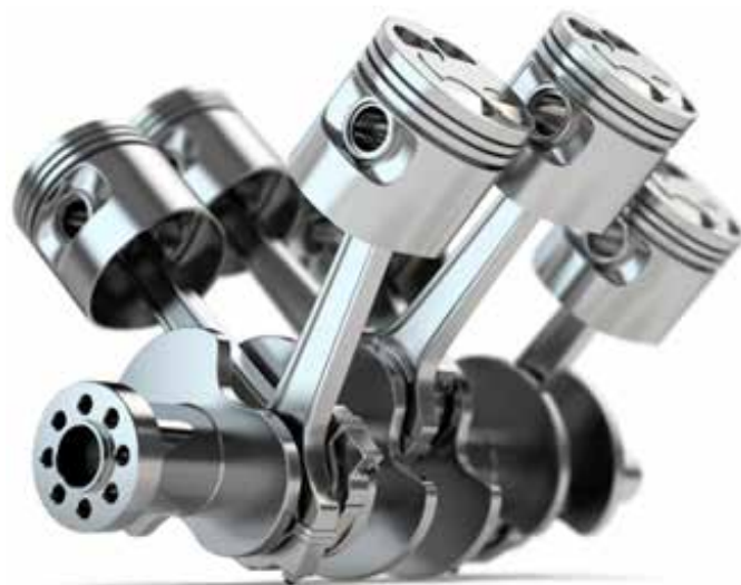
Рисунок 35-14: Коленчатый вал V-6 двигателя с углом между рядами цилиндров (банками), равным 60^\circ , имеет шесть шатунных шеек, расположенных под углом 60^\circ относительно друг друга; источник: freightratecentral.com
