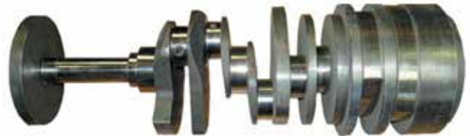
Рисунок 35-7: На снимке показана заготовка коленчатого вала в ходе проведения механической обработки. Слева, почти готовая форма коленчатого вала с уже сформированными коренными шейками, щеками и противовесами, справа – подвергнутая лишь подготовительной механической обработке (обдирке) часть заготовки коленчатого вала, в начальной фазе формирования требуемых форм; источник: Pearson Education, Inc.
