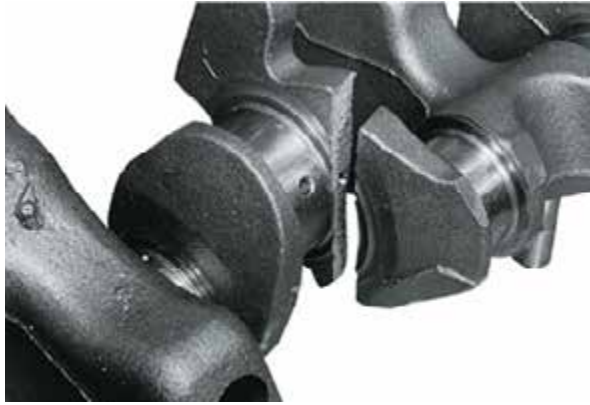
Рисунок 35-17: Коленчатый вал был сломан в результате возникновения чрезмерных крутильных колебаний; источник: Pearson Education, Inc.
