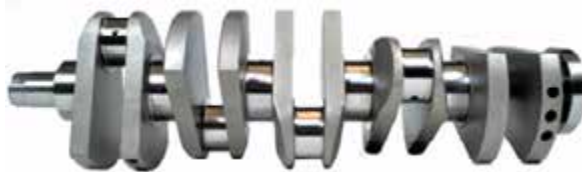
Рисунок 35-11: Коленчатый вал 5-цилиндрового рядного двигателя, у которого углы между кривошипами составляют 72^\circ
