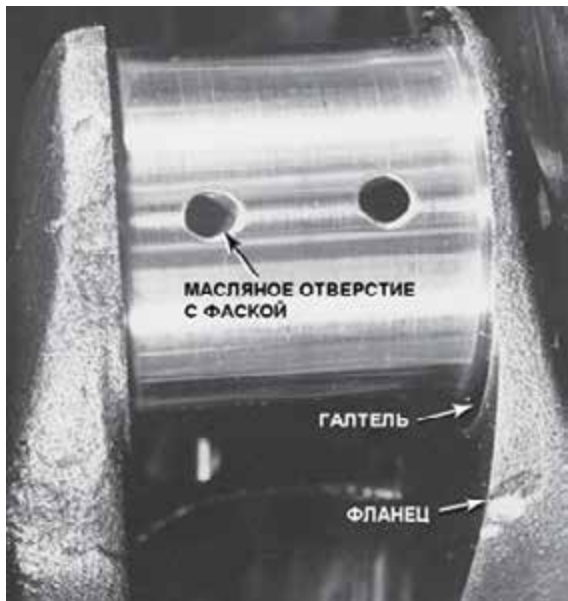
Рисунок 35-9: Типичное отверстие с фаской, выполненное на шейке коленчатого вала; источник: Pearson Education, Inc.
