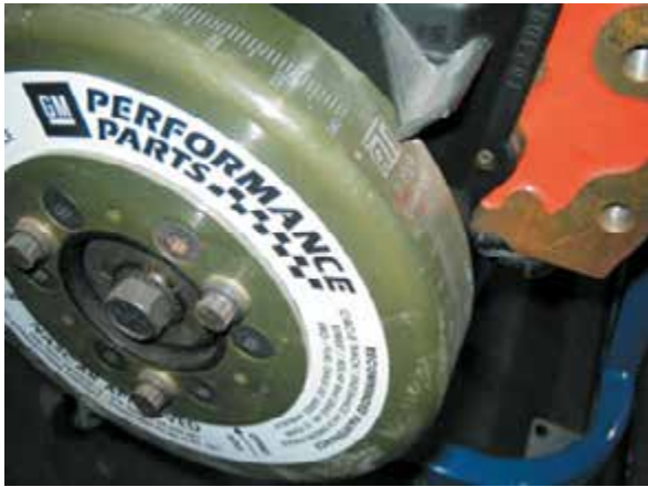
Рисунок 35-19: General Motors использует высокопроизводительный балансир на двигателях гоночных автомобилей; источник: Pearson Education, Inc.
