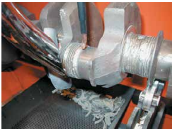
Рисунок 35-34: Чрезмерно изношенный коленчатый вал может быть восстановлен путем наплавки шеек с последующим их шлифованием в оригинальный размер; источник: Pearson Education, Inc.
