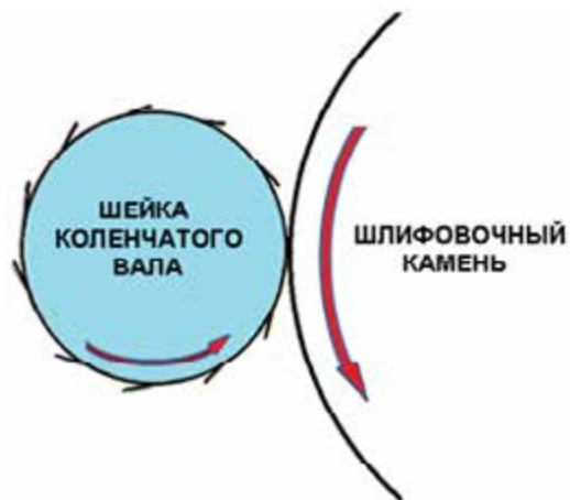
Рисунок 35-33: Направление вращения шлифовального камня и коленчатого вала должны придать микроворсинкам направления, которое противоположно необходимому направлению ворса после полировки; источник: TB2052 DANA
