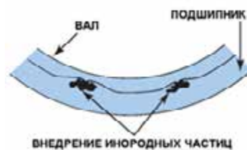
Рисунок 35-42: Схематическое представление о том, как посторонние материалы в виде твердых загрязнений внедряются в структуру подшипникового материала; источник: Pearson Education, Inc.
