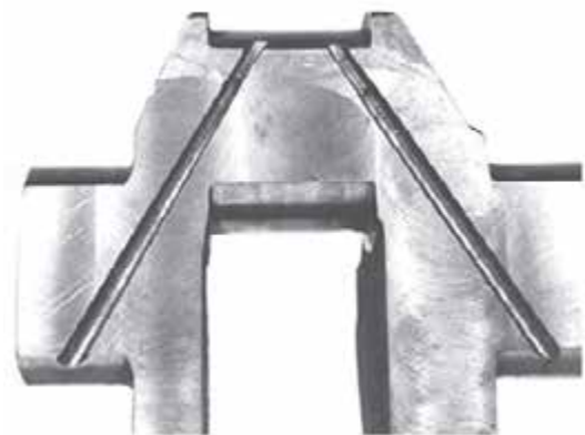
Рисунок 35-8: На снимке показан распиленный вдоль коленчатый вал, чтобы показать просверленные каналы, по которым масло от коренных шеек поступает к шатунным шейкам; источник: Pearson Education, Inc.
