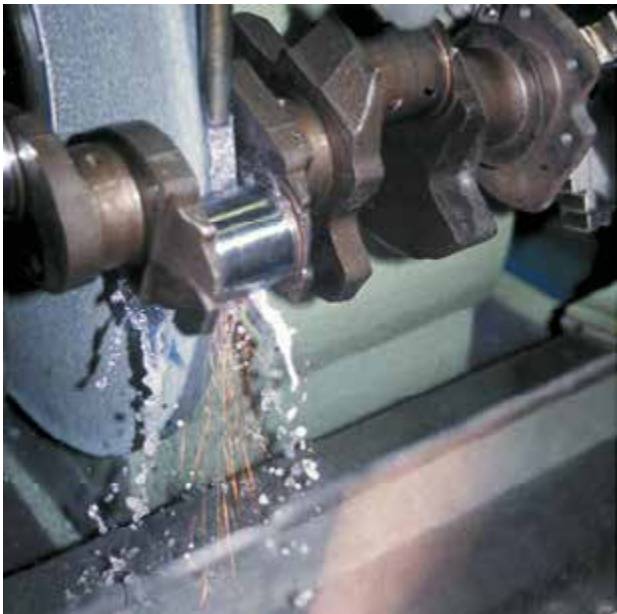
Рисунок 35-28: Закругления в зоне перехода от шейки к щеке коленчатого вала формируется за счет соответствующей обработки краёв шлифовального камня; источник: Pearson Education, Inc.
