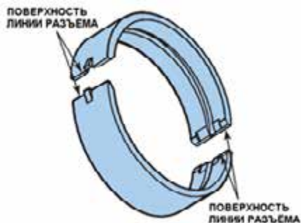
Рисунок 35-36: Две половинки подшипника скольжения (в просторечье – вкладыши) складываются в упор разделительными поверхностями; источник: Pearson Education, Inc.
