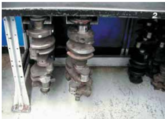
Рисунок 35-35: Коленчатые валы должны храниться в вертикальном положении в той области ремонтной зоны, которая предотвратит риск случайного их повреждения; источник: Pearson Education, Inc.
