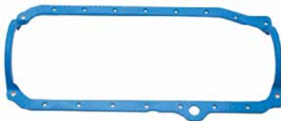
Рисунок 36-8: Обрезиненные стальные прокладки заменили ранее применяемые прокладки масляного поддона, которые имели отдельные элементы уплотнения корпуса переднего и заднего коленного подшипника, и две сторонние уплотнительные полосы; источник: Pearson Education, Inc.
