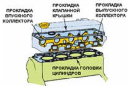
Рисунок 36-2: Прокладки помогают предотвратить утечки между двумя поверхностями; источник: Pearson Education, Inc.
