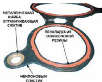
Рисунок 36-10: Типичная прокладка впускного коллектора оснащена металлической шайбой, предотвращающей чрезмерное сжатие прокладки при её установке и креплении с помощью резьбовых крепежных элементов; источник: Pearson Education, Inc.
