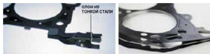
Рисунок 36-6: Многослойные стальные прокладки (MLS) широко используются на многих современных полностью алюминиевых двигателях, а также на двигателях, которые используют литой чугунный блок с алюминиевыми головками цилиндров. Этот тип прокладки позволяет компенсировать разницу температурного расширения алюминия и чугуна, не потеряв уплотнительной способности прокладки; источник: Pearson Education, Inc.
