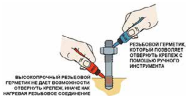
Рисунок 36-15: Применение изоляторов резьбовых соединений ( Thread locker ) зависит от того, может ли быть отвернут крепеж вручную? Если да, то следует применять фиксирующий резьбовой герметик синего цвета. Высокопрочный резьбовой герметик красного цвета может быть удален только при нагревании; источник: Pearson Education, Inc.
