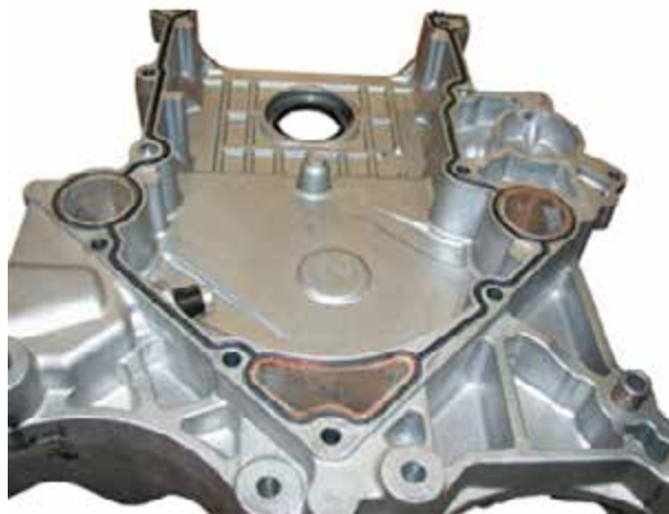
Рисунок 36-9: Формируемая на месте прокладка, как правило, использует силиконовую резину, и наносится по поточной линии сборки двигателей робототехникой. При ремонте обязательно проверьте, какой материал рекомендует производитель двигателя; источник: Pearson Education, Inc.
