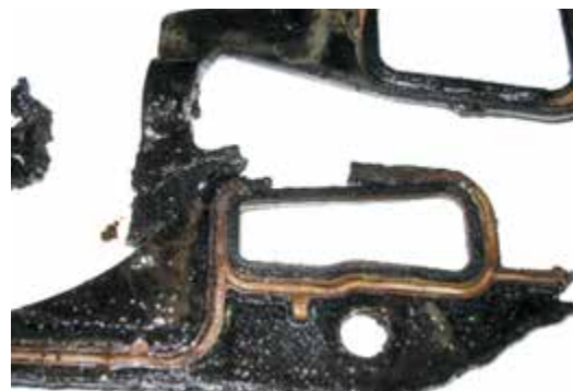
Рисунок 36-11: Эта прокладка впускного коллектора была повреждена из-за коррозионного истирания. Конструктивные изменения, внесенные в более поздние варианты прокладок, позволяют большее движение между впускным коллектором и головкой цилиндров; источник: Pearson Education, Inc.
