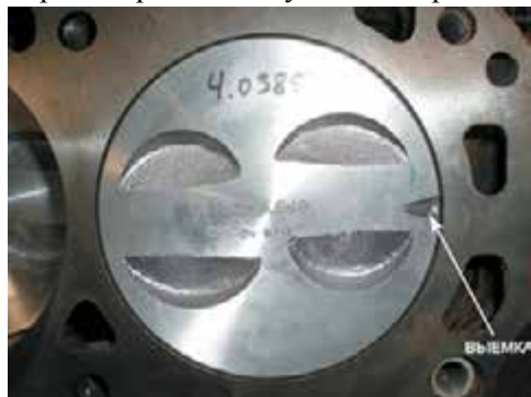
Рисунок 37-30: Выемка на днище поршня должна всегда быть направлена к передней части двигателя; источник: Pearson Education, Inc.
