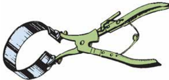
Рисунок 37-36: Этот клещевой тип инструмента использует гибкую ленту для сжатия поршневых колец перед установкой поршня в цилиндр. Инструмент комплектуется гибкими лентами для различных диаметров поршней; источник: Pearson Education, Inc.
