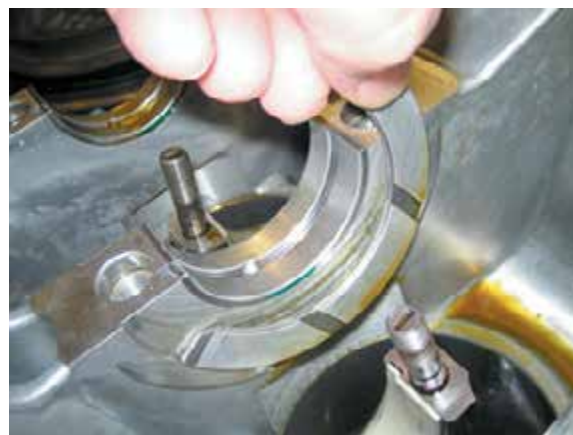
Рисунок 37-26: Вставляемый упорный подшипник следует поместить в предназначенное для него гнездо перед укладкой коленчатого вала; источник: Pearson Education, Inc.
