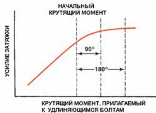
Рисунок 37-45: Из-за сложности достичь одинакового прижимного усилия простым выполнением предписаний по приложению рекомендованного крутящего момента многие производители прибегли к методу затяжки с превышением предела текучести материала болтов крепления головки цилиндров. Первичная затяжка болтов производится предписанным крутящим моментом в указанном производителем порядке. Затем к головкам болтов в том же порядке прилагается усилие, позволяющее повернуть головку болта на строго определенный угол. Пластическая деформация болта позволяет получить необходимое усилие затяжки; источник: Pearson Education, Inc.
