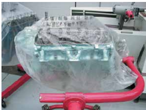
Рисунок 37-8: Использование пластикового мусорного мешка является отличным способом, чтобы держать двигатель в чистоте на всех этапах сборки; источник: Pearson Education, Inc.
