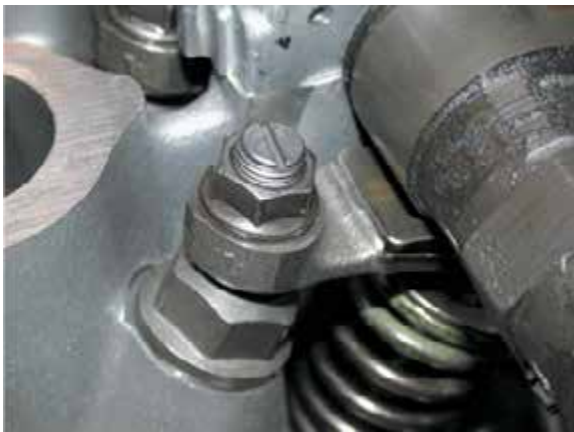
Рисунок 37-54: Настраиваемый механизм регулировки клапанного зазора использует фиксирующую гайку, которая предотвращает самопроизвольное изменение регулировок. Поэтому перед регулировкой следует ослабить фиксирующую гайку, и винтом отрегулировать зазор. Затем фиксирующая гайка затягивается, чтобы сохранить настройку. Дважды проверьте клапанный зазор после затяжки фиксирующей гайки; источник: Pearson Education, Inc.
