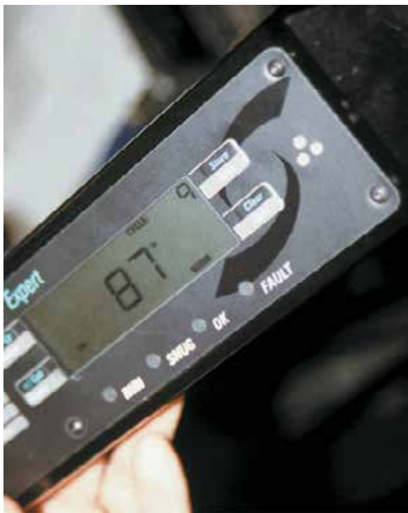
Рисунок 37-48: Электронный динамометрический ключ, показывающий количество градусов поворота. Эти очень точные и дорогие динамометрические ключи могут быть запрограммированы для отображения крутящего момента или количества градусов поворота; источник: Pearson Education, Inc.
