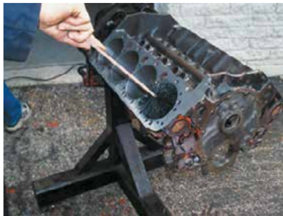
Рисунок 37-14: Лучший способ тщательной очистки цилиндров – использовать мыльного раствора (мощного средства), воды, и большой щетки. Этот метод позволяет отделить прилипшие во время механической обработки частицы от поверхностей блока, и смыть их потоком воды; источник: Pearson Education, Inc.
