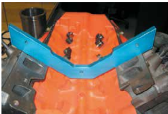
Рисунок 37-13: Угловой калибр (шаблон) используется для проверки угла между головками цилиндров на V-образном двигателе, в частности, на снимке – проверка угла между головками цилиндров небольшого блока V-8 двигателя Chevrolet .; источник: Pearson Education, Inc.
