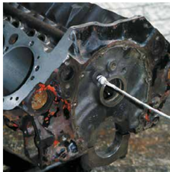
Рисунок 37-15: Все масляные галереи следует очистить с помощью мыла (мощного средства), воды, масла и длинной щетки для чистки галерей; источник: Pearson Education, Inc.
