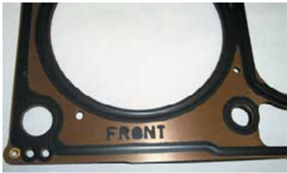
Рисунок 37-44: Типичная маркировка прокладки головки цилиндров. Надпись «FRONT» должна быть обращена к той части двигателя, на которой крепятся ремни привода аксессуаров; источник: Pearson Education, Inc.
