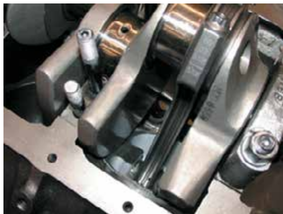
Рисунок 37-9: Пробная сборка показала, что потребуется небольшая шлифовка блока цилиндров, чтобы обеспечить зазор для противовеса коленчатого вала. Также, обратите внимание, что двигатель был оснащен шпильками для 4-болтовых крышек коренных подшипников; источник: Pearson Education, Inc.
