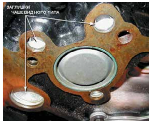
Рисунок 37-16: На этом двигателе используются три чашевидные заглушки в отверстиях масляной галереи, одна такая же заглушка в отверстие рубашки охлаждения и одна большая заглушка, устанавливаемая в торцевой части отверстия распределительного вала; источник: Pearson Education, Inc.
