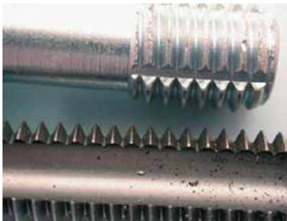
Рисунок 37-7: Зачистной метчик (вверху) – предпочтительный инструмент при очистке резьбовых отверстий, поскольку он очищает резьбу без удаления металла, в отличие от обычного резьбонарезного метчика (снизу); источник: Pearson Education, Inc.
