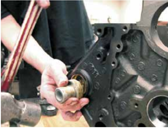
Рисунок 37-17: Герметик следует наносить на коническую поверхность чашеобразной заглушки до её установки в отверстие сердцевины; источник: Pearson Education, Inc.
