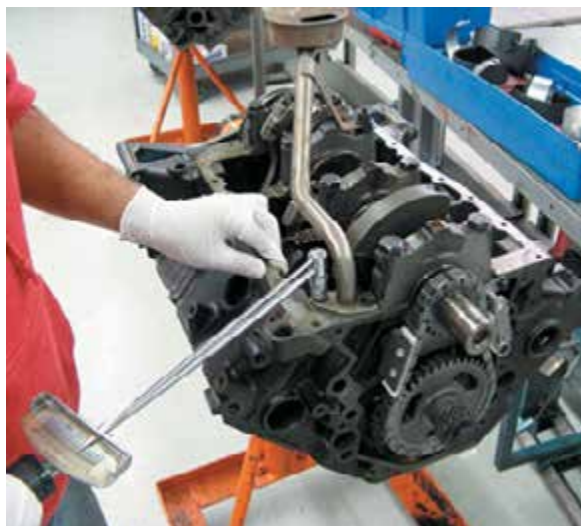
Рисунок 37-58: На снимке показана процедура затяжки фланца маслоприемника с помощью динамометрического ключа лучевого типа. Крутящий момент определяется спецификацией по ремонтуемому двигателю; источник: Pearson Education, Inc.
