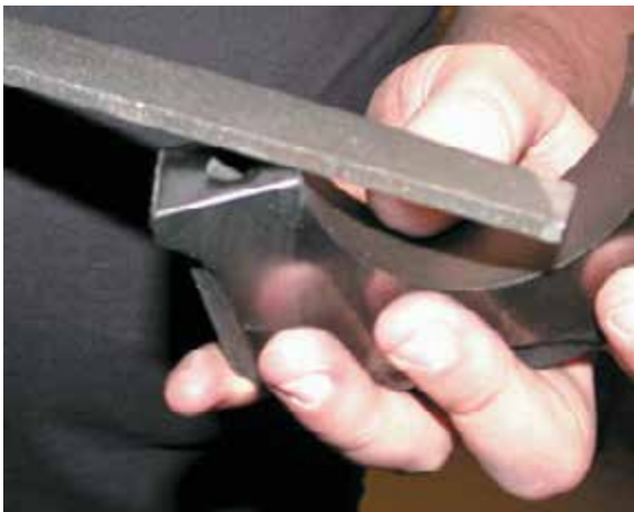
Рисунок 37-2: Снятие всех острых кромок и заусенцев является важным шагом для достижения правильной сборки двигателя; источник: Pearson Education, Inc.
