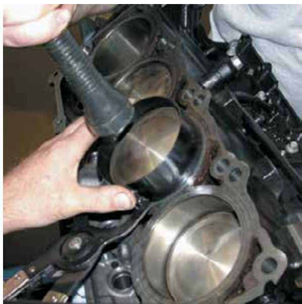
Рисунок 37-38: Установка поршня в цилиндр с помощью устройства сжатия поршневых колец. Рукояткой молотка слегка ударяйте по днищу поршня, опуская его в цилиндр. Не забудьте направлять открытую большую головку шатуна на шатунную шейку за длинные защитные приспособления шатунных болтов; источник: Pearson Education, Inc.
