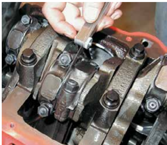
Рисунок 37-39: Боковой зазор между большой головкой шатуна и щекой кривошипа измеряется плоским щупом; источник: Pearson Education, Inc.
