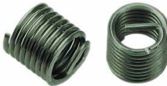
Рисунок 37-6: Резьбовая вставка Heli-Coil ввинчивается в резьбовое отверстие, и принимает на себе нагрузку, равномерно распределяя её в тело соединяемой детали; источник: LLC Newfrey
