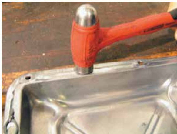
Рисунок 37-60: Перед установкой новой прокладки проверьте прямолинейность прилегающей поверхности масляного поддона. После затяжки болтов крепления масляного поддона происходит небольшая деформация металла. Если не выпрямить металл вокруг болтовых отверстий, может возникнуть утечка масла; источник: Pearson Education, Inc.
