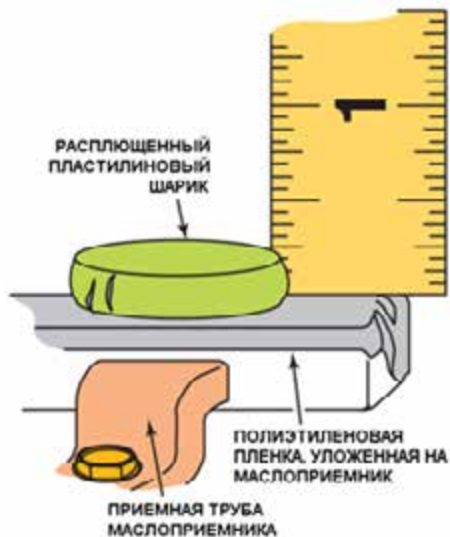
Рисунок 37-59: Используйте пластилин для определения зазора между маслоприёмником и масляным поддоном; источник: Pearson Education, Inc.
