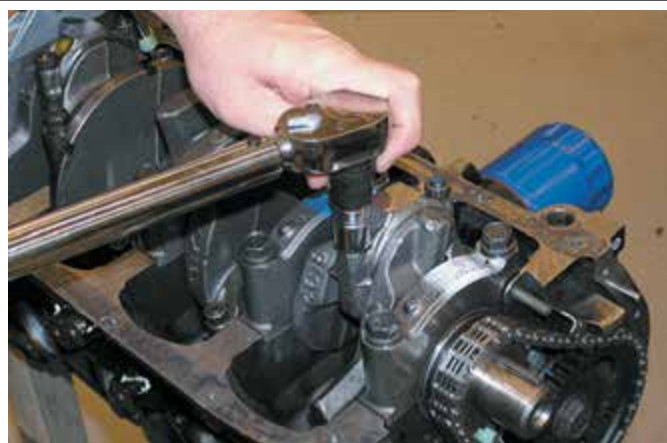
Фото 37-7: Наденьте на болты шатуна крышку, и затяните гайки с предписанным спецификацией усилием.
