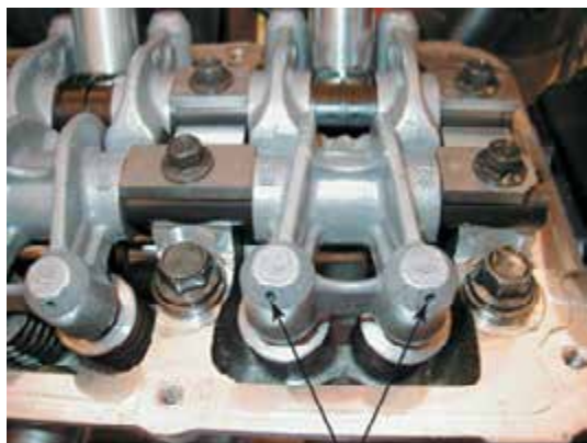
ОТВЕРСТИЯ ВЫПУСКА ВОЗДУХА ИЗ ГИДРАВЛИЧЕСКИХ МЕХАНИЗМОВ РЕГУЛИРОВКИ ЗАЗОРОВ В ПРИВОДЕ КЛАПАНОВ (HLA)
