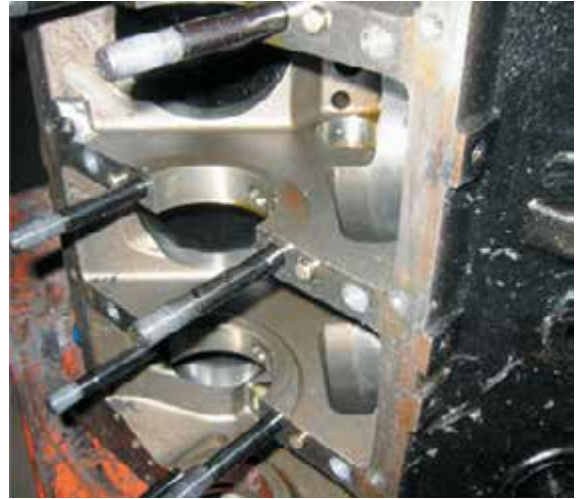
Рисунок 37-4: Шпильки крепления крышек коренных подшипников, ввернутые в V-8 блок; источник: Pearson Education, Inc.
