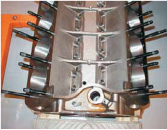
Рисунок 37-3: Вместо штатных болтов крепления головок цилиндров в блок ввинчены шпильки. Обратите внимание на то, сколько пространства необходимо для снятия головок цилиндров; источник: Pearson Education, Inc.
