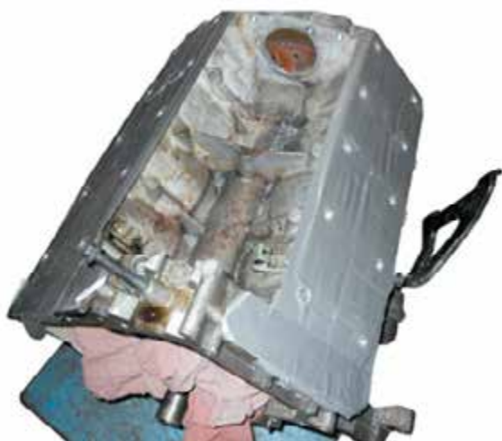
Рисунок 37-5: На снимке двигатель Cadillac Northstar в процессе восстановительного ремонта. В цехе выполняли работу, связанную с установкой Heli-coils® во все резьбовые отверстия под болты крепления головки цилиндров. В качестве меры предосторожности была использована клейкая лента, которая укрывала открытые полости двигателя, что помогает предотвратить попадание алюминиевой стружки в каналы и проходы; источник: Pearson Education, Inc.
