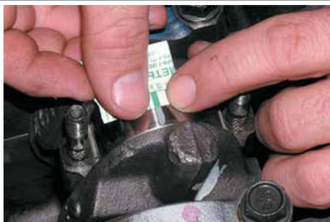
Фото 37-8: Отверните гайки крепления крышки и аккуратно снимите её. Сравните толщину деформированной нити с трафаретом на упаковке Plastigage ® . Чем больше ширина деформированной нити, тем меньше подшипниковый зазор. Проведите эту операцию для всех шатунных подшипников
