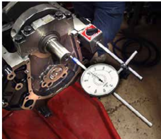
Рисунок 37-25: Циферблатный индикатор используется для проверки осевого люфта коленчатого вала, известный как зазор в упорном подшипнике. Всегда следуйте инструкциям производителя, соблюдая предписанные процедуры тестирования; источник: Pearson Education, Inc.
