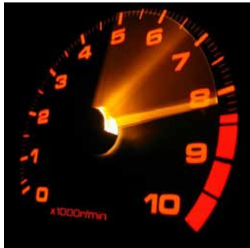
Рисунок CP37-39: Предельные обороты двигателя на тахометре обозначены красным цветом. Разгон коленчатого вала двигателя до красной линии возможен, но обороты выше красной линии обычно ограничиваются отсечкой топливоподачи в цилиндры двигателя; источник: AcuraBoost
