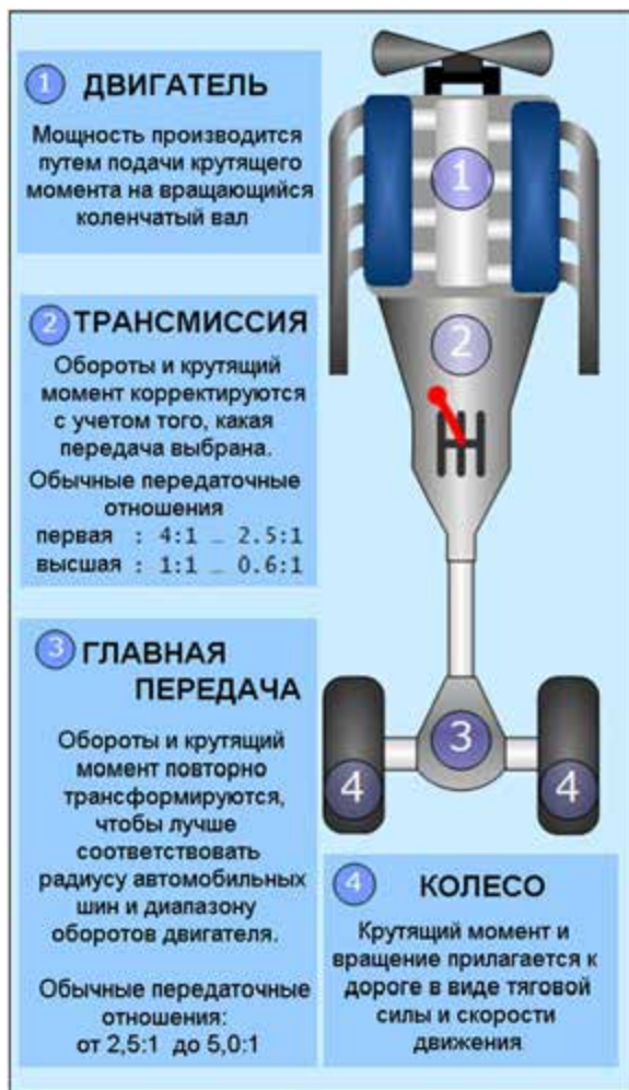
Рисунок CP37-18: Трансмиссия автомобиля оснащена коробкой передач и главной (финальной) передачей для регулировки крутящего момента двигателя и оборотов, необходимых для ускорения автомобиля; источник: craig.backfire
