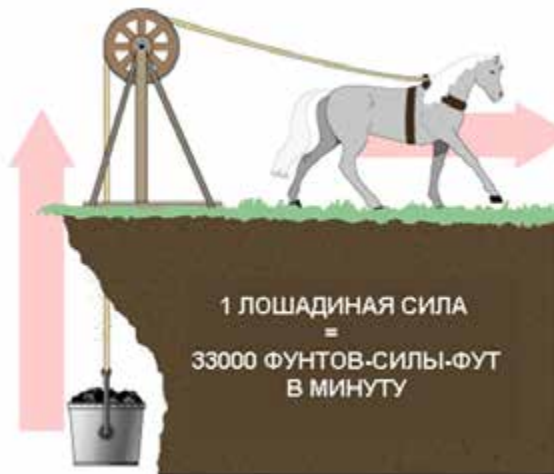
Рисунок SP37-01: Джеймс Ватт высчитал, что мощность одной лошади составляет 33000 фунтов-силы-фута; источник: craig.backfire
