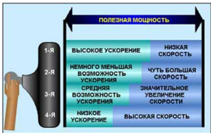
Рисунок CP37-20: Каждая пара зубчатых колес в коробке передач позволяет получить различные ускорения и скорости. Сочетание скорости и ускорения обеспечивается крутящим моментом и мощностью двигателя; источник: craig.backfire
