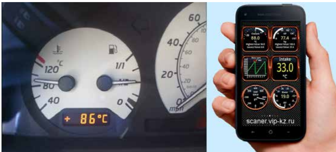
Рисунок 38-7: Несмотря на то, что температурный указатель может показывать нормальную рабочую температуру, используйте диагностический прибор или инфракрасный пирометр для проверки фактической температуры охлаждающей жидкости
