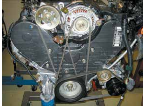
Рисунок 38-5: Чаще значительно проще установить и отрегулировать натяжение ремней привода вспомогательных агрегатов перед установкой двигателя в автомобиль; источник: Pearson Education, Inc.
