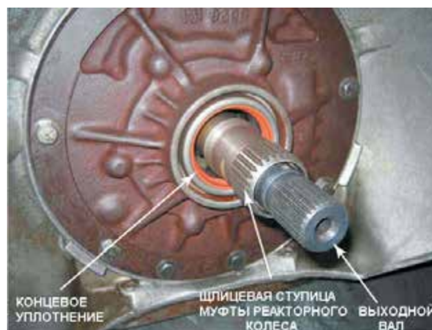
Рисунок 38-4: Шлицы выходного вала и шлицы установки муфты реакторного колеса гидротрансформатора перед установкой гидравлического трансформатора на валы АКПП должны быть выровнены; источник: Pearson Education, Inc.
