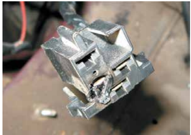
Рисунок 38-1: Частично расплавленный электрический разъем указывает, что в цепи присутствовало превышение максимально допустимой силы тока. Причину появления чрезмерного тока необходимо выяснить, и исправить до запуска двигателя; источник: Pearson Education, Inc.
