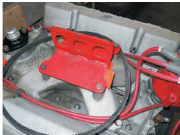
Рисунок 38-6: На двигатель установлена такелажная скоба, за которую будут цеплять крючья цепи подъемного устройства; источник: Pearson Education, Inc.
