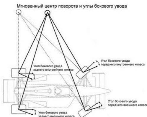
Рис. 1.48: Боковой увод колес передней и задней осей вызывает смещение мгновенного центра поворота автомобиля вперед. Если боковой увод передних и задних колес автомобиля одинаков, то автомобиль обладает так называемой «нейтральной поворачиваемостью». Это значит, что радиус поворота автомобиля не изменился, хотя и произошло центра поворота вперед; Источник: Racing Car Technology (RCT)
