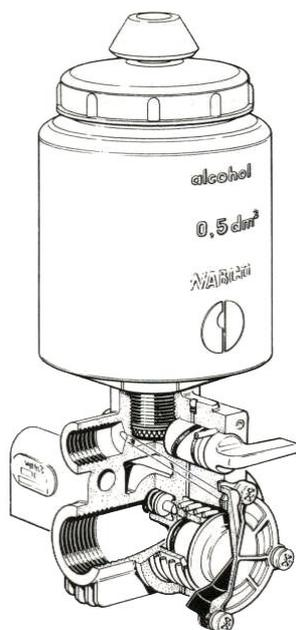
Рис. 9: Частичный разрез автоматического насоса для предохранения от замерзания; Источник: ТАК
